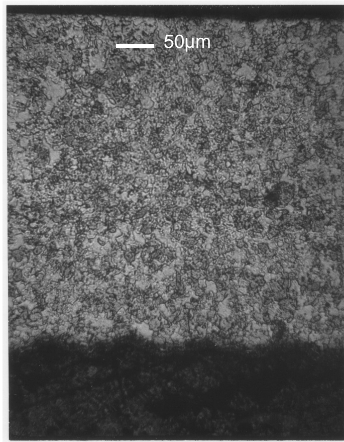
Figure 2-47: Microstructure du dépôt de tungstène LPPS (vue dans l'épaisseur, MEB électrons secondaires).
