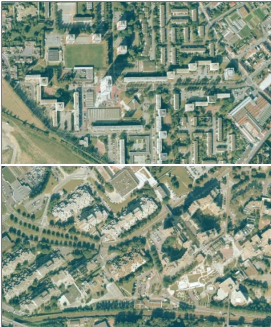
Figure 9 : Le quartier des Olivaux représentatif du grand ensemble des années 1950-1960 (photographie du dessus) et le quartier du Pont de Bois représentatif de celui de la fin des années soixante-dix avec des principes de hiérarchisation des réseaux et de ségrégation des modes plus fortement marqués (photographie du dessous)
