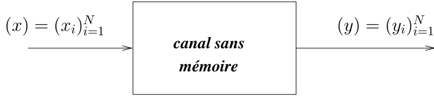
FIG. 5.17 – Passage de la séquence (x) à travers un canal sans mémoire.
