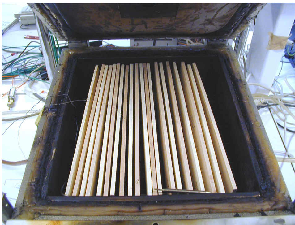
Figure 5-18 : Photo de la disposition des échantillons dans le four expérimental de traitement thermique du CIRAD-Forêt (Photo Patrick Rousset, CIRAD-Forêt).
