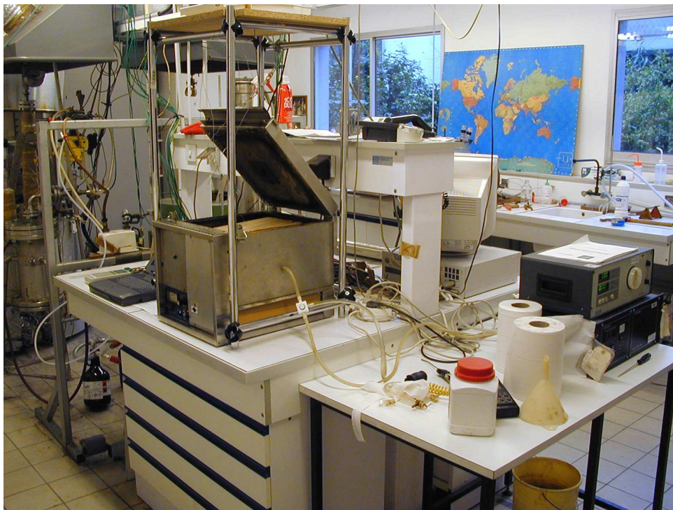
Figure 5-17 : Photo d'un dispositif expérimental de traitement thermique du bois du CIRAD-Forêt ( Photo Patrick Rousset, CIRAD-Forêt ).
