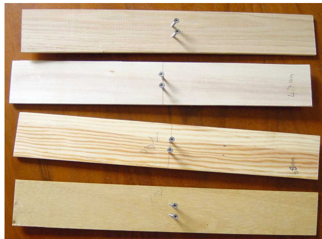
Figure 3-9 : Exemple de quelques échantillons préparés, avant l'essai.
