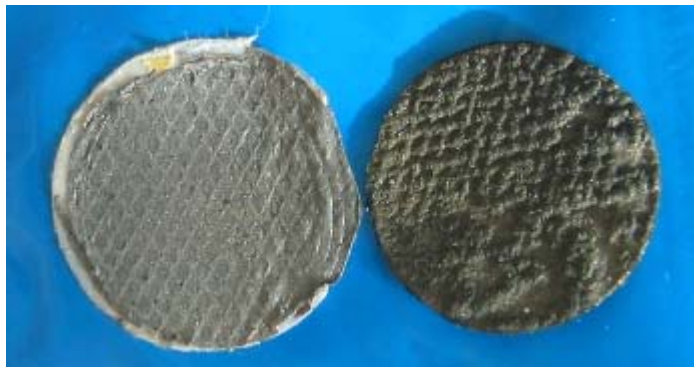
figure 4-19 – Film plastique de Sb (à gauche) et de \text{Li}_3\text{Sb} (à droite).
