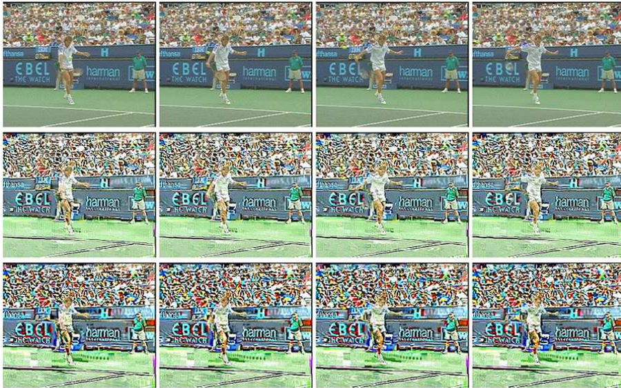
FIG. 27 – Résultats du Waterscrambling sur la séquence Stefan avec les forces suivantes \alpha . La première ligne représente la séquence originale ( \alpha = 0 ), la seconde ligne représente les résultats avec \alpha = 40 et la dernière ligne utilise \alpha = 60
