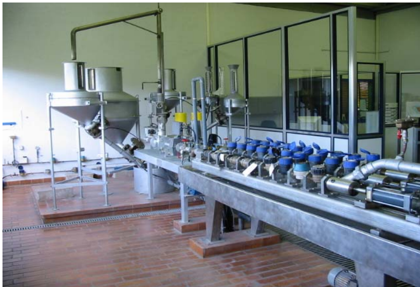
FIG. 4.2 – Le banc d'essai des compteurs du LECE.
