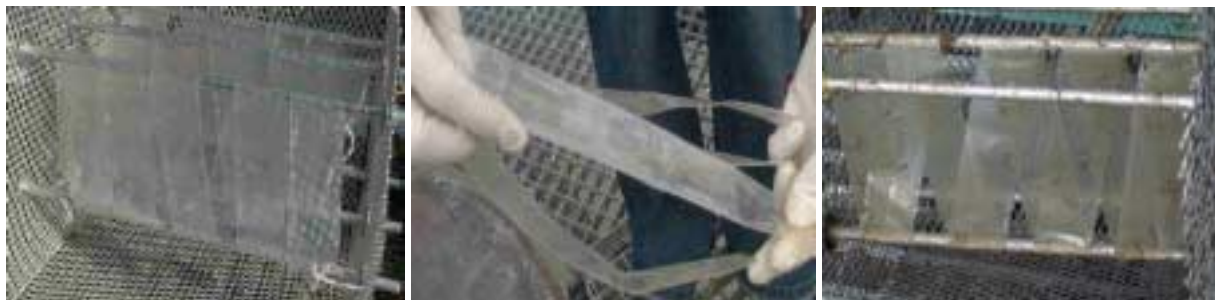
Photo 4 : SPMD avant mise à l'eau (gauche) dans les cages de protection, après 21 jours dans la Marne à Saint Maurice, (février 03, milieu), après 14 jours dans la Seine à Andrésy (avril 03, droite)
