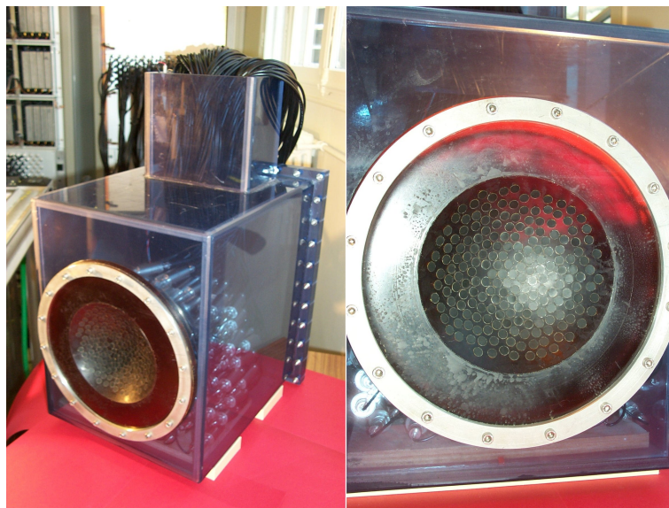
FIG.5.9 – Prototype dédié à la thérapie ultrasonore du cerveau. A gauche l'électronique multivoie et le boîtier contenant les adaptations d'impédances. A droite la distribution semi-aléatoire.
