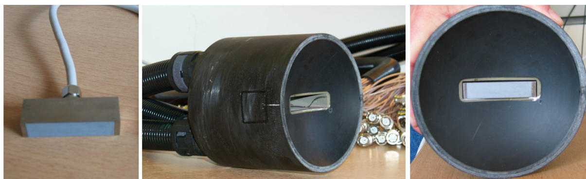
FIG.3.10 – A gauche : barrette d'imagerie 128 éléments. Au milieu : le système 192 éléments de thérapie. A droite : assemblage des transducteurs d'imagerie et de thérapie.
