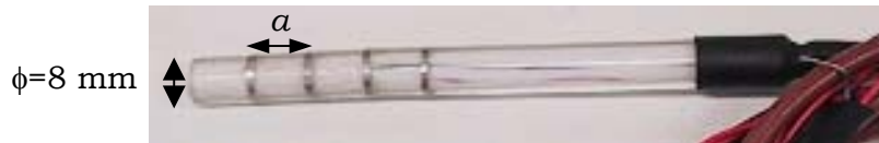
Figure II-3. Photo de la sonde de conductivité électrique type Wenner ( a = 5 mm).
