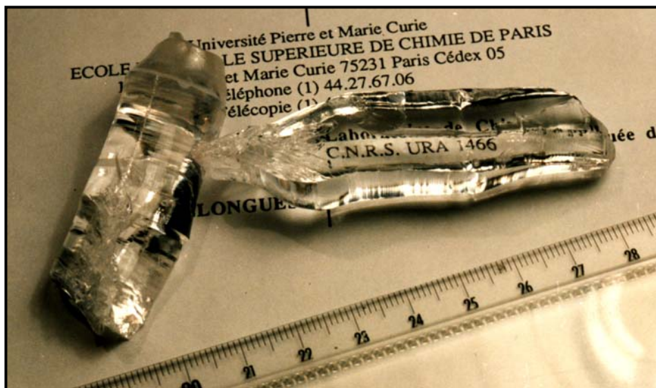
Figure 8: En haut: cristaux de GdCOB et YCOB obtenus par la technique Czochralski. Le cristal de GdCOB a été élaboré par la société Crismatec. Ses dimensions sont de 50 mm pour le diamètre et 120 mm pour la longueur. Le cristal de YCOB a pour dimensions 25 mm de diamètre et 150 mm de longueur. Ces cristaux sont parfaitement transparents et non fracturés. En bas: cristal de GdCOB élaboré au Laboratoire fracturé en deux.
