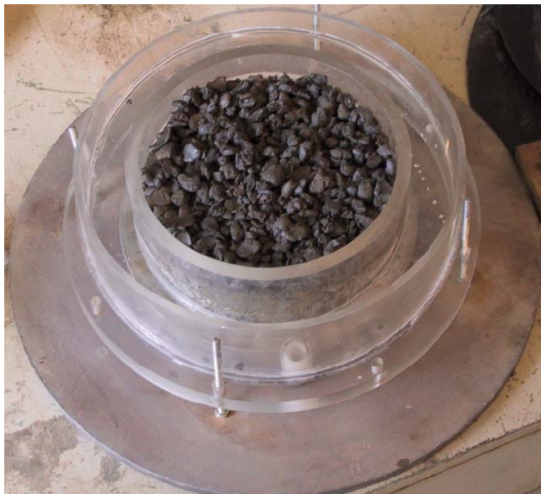
Figure AII-1: Couche d'argile en agrégats dans la cellule avant reproduction de l'état de surface
