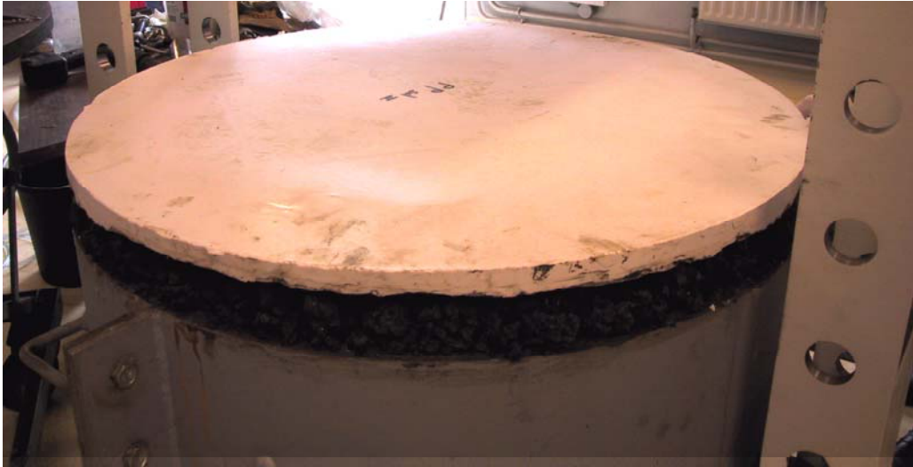
Figure AV-1: le moulage est placé sur la couche d'argile
