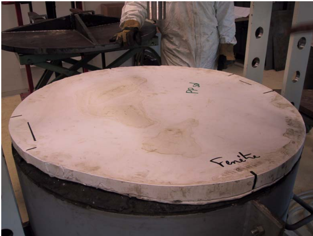
Figure AV-8: les repères sur le moulage sont utilisés pour le replacer toujours dans la même position par rapport à la colonne d'essais
