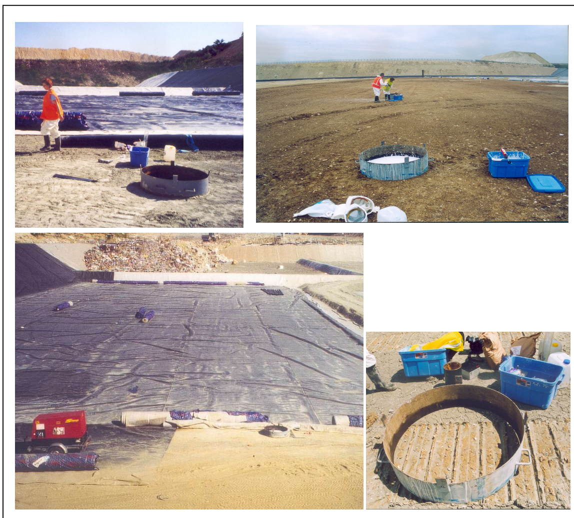
Figure IV-7 : Réalisation des moulages d'état de surface de barrière minérale sur différents sites.
