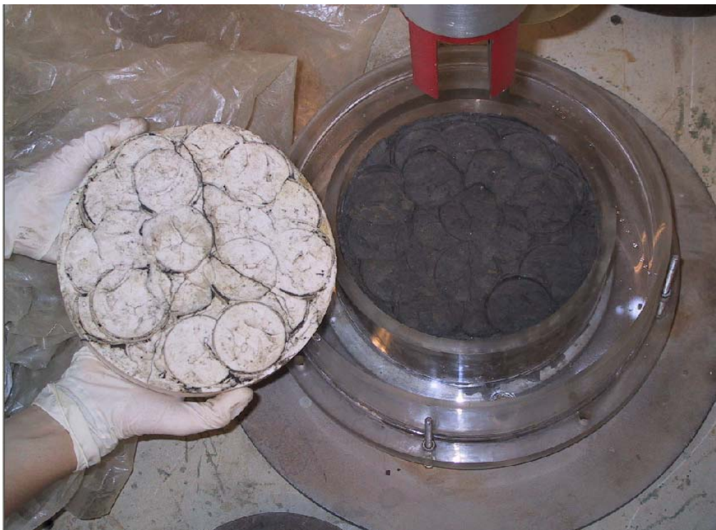
Figure AII-3: État de surface reproduit et moulage utilisé
