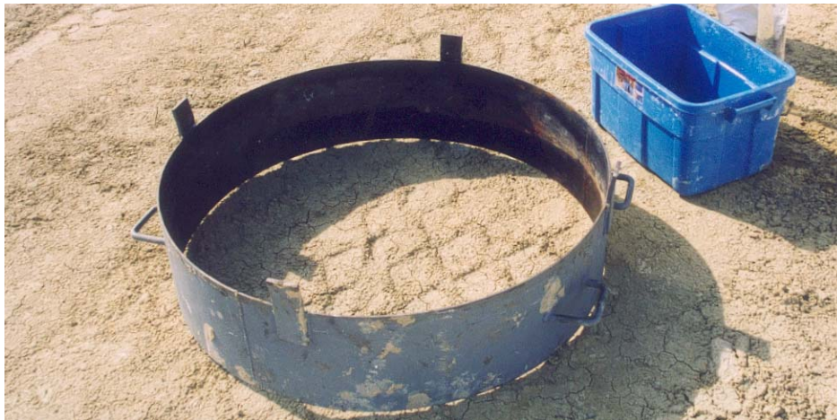
Figure AIV-1: Mise en place du cerclage d'acier sur la zone à mouler
