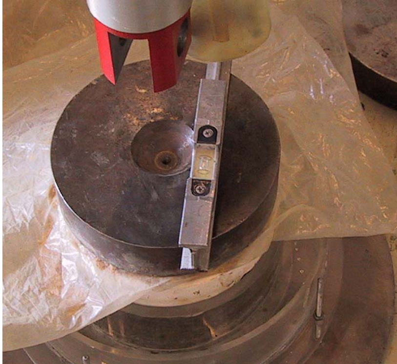
Figure AII-2: Vérification de l'horizontalité avant application de la charge mécanique
