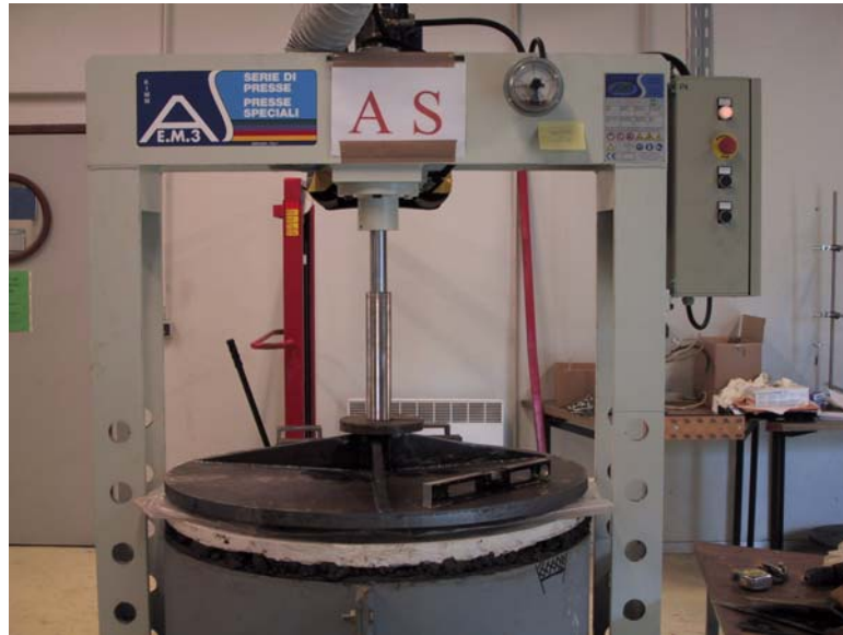
Figure AV-7: application de la contrainte mécanique pour reproduire l'état de surface
