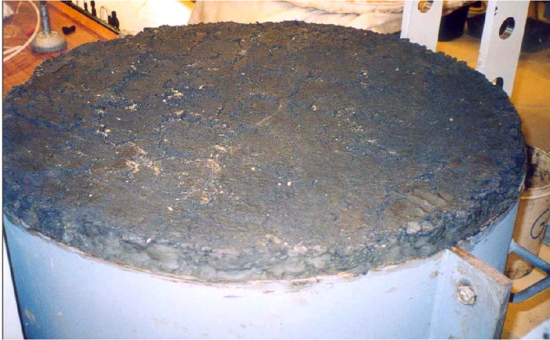
Figure AV-11: état de surface reproduit en fin d'essai
