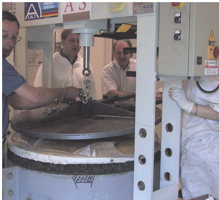
Figure AV-6: descente de la plaque en utilisant la presse hydraulique
