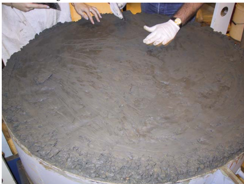
Figure AV-9: étape intermédiaire de lissage de la couche d'argile
