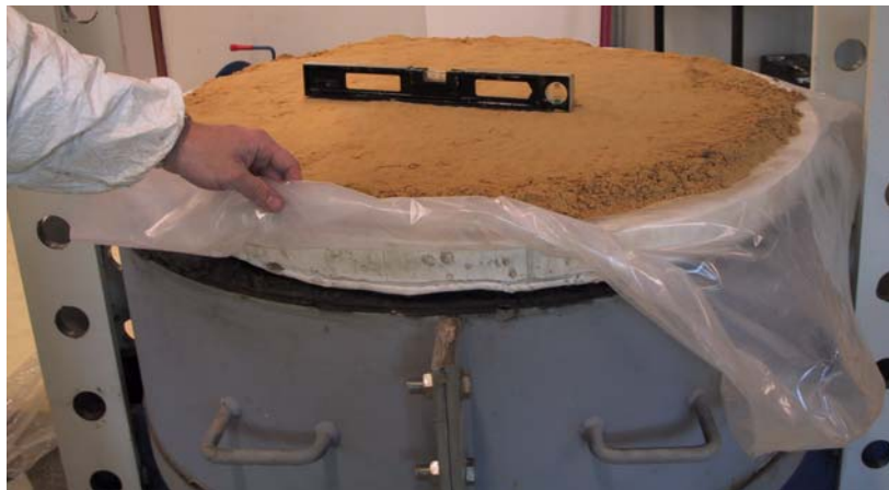
Figure AV-2: Une couche de sable est étalée et réglée pour uniformiser le contact entre la plaque d'acier et le moulage de plâtre polyester
