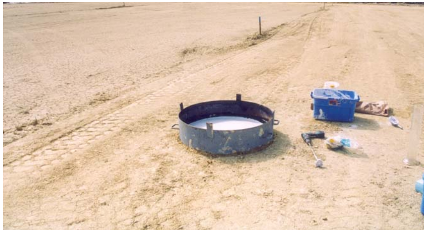
Figure AIV-2: Moulage de l'état de surface de la barrière minérale en cours
