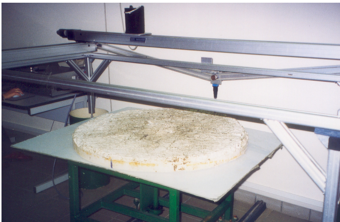
Figure IV-18 : Moulage d'état de surface de barrière minérale mis en place sous le bâti du rugosimètre laser en vue de la mesure de sa topographie.
