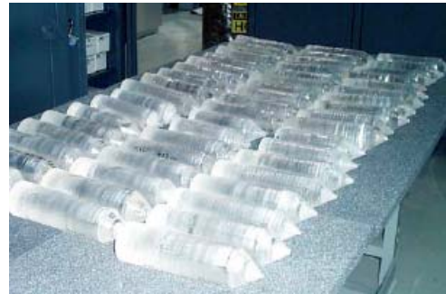
Figure I 14 : Production de cristaux de \text{Lu}_2\text{SiO}_5:\text{Ce} chez CTI (Knoxville, USA) en 2003 [6].
