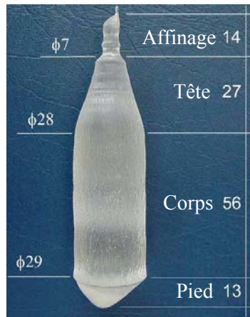
Figure II 4 : Cristal Czochralski de LPS:0,5%Ce d'un pouce de diamètre obtenu au LETI. Dimensions indiquées en mm.
