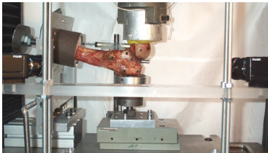
Figure 47 : Configuration de l'essai mécanique mis en place pour provoquer des fractures cliniques après une chute sur le côté.
