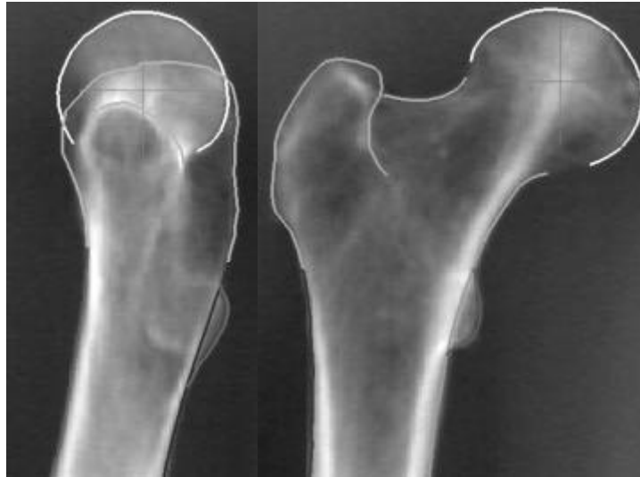
Figure 23 : Identification des contours non-stéréocorrespondants sur les vues frontale et latérale issues de l'acquisition DXA stéréoradiographique d'un fémur proximal.
