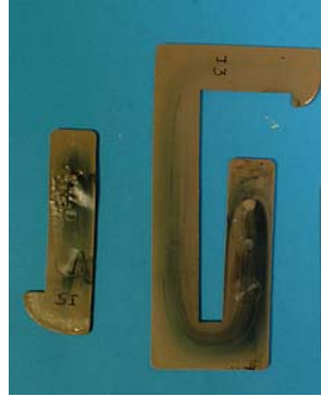
Fig. III.45 : Incomplets sur moule spirale réalisés pour des courses de 6 et 21,4 mm.
