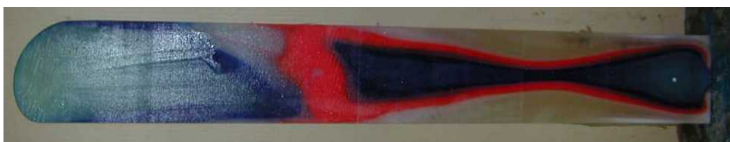
Fig. III.15 : \frac{1}{2} coupe dans le plan médian de la pièce finale (essai E - débit : 2,3 \cdot 10^{-5} \text{ m}^3/\text{s} ).
