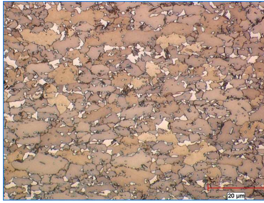
FIG. 2.30 – Micrographie de l'acier ferrito-martensitique D1957
