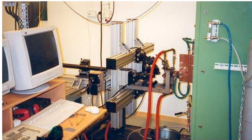
FIG. 4.61 – Vue d'ensemble du banc d'essai de fatigue thermique
