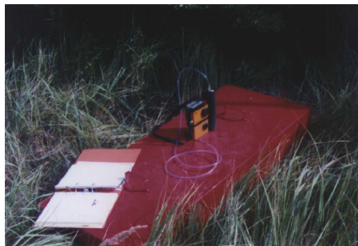
FIG. A.4 – Capot en tôle muni d'un tuyau en caoutchouc, posé sur les fosses immédiatement après leur creusement et relié à un détecteur à photo-ionisation de modèle MultiwarmPID qui évalue la teneur en polluants organiques volatils totaux.
