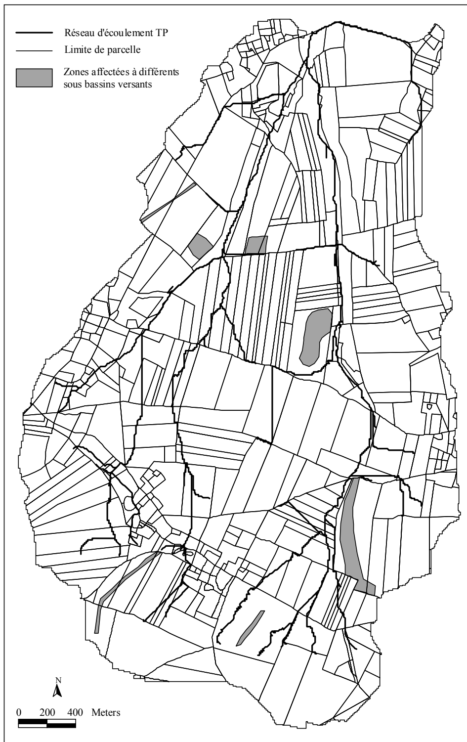
Figure 19 : Zonages des portions de territoires affectées à différents sous bassins versant en fonction du réseau d'écoulement choisi
