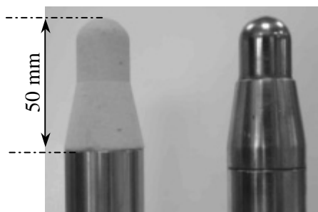
figure V-13 : Adaptation du test d'impact multi-axial pour utiliser un poinçon feutre : géométrie des embouts.
