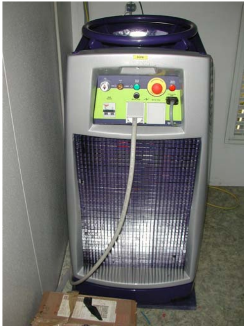
Pile à combustible PEM de 2 kW (Air Liquide) et son unité de contrôle (à droite).
