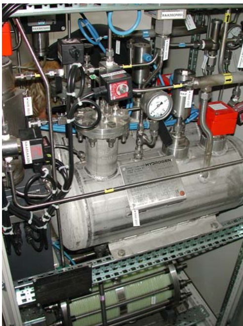
Electrolyseur alcalin de 3,6 kW (Hydrogen Systems) et son unité de contrôle (à droite).
