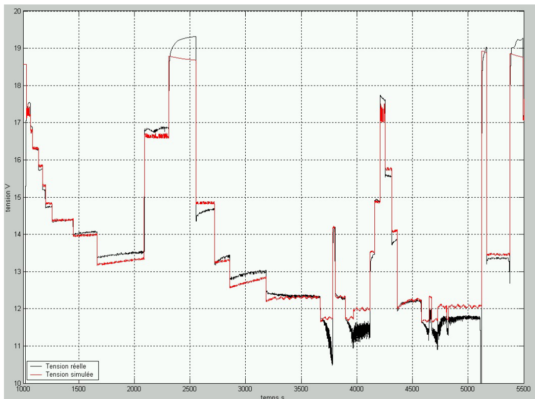
Figure IV-13 : Comparaison de la tension réelle (noire) et simulée (rouge) de la pile à combustible.
