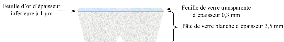
Figure 1-7 : Représentation schématique d'un profil de la tesselle dorée.
