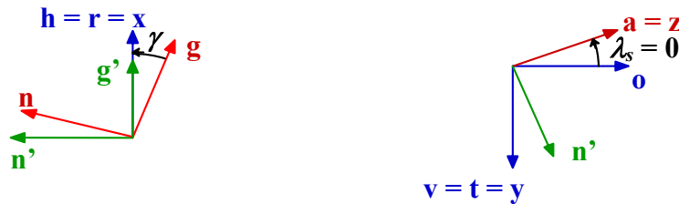
Figure IV-8 : Repères associés à la configuration de la série d'essais liés à l'influence de l'angle de coupe.
