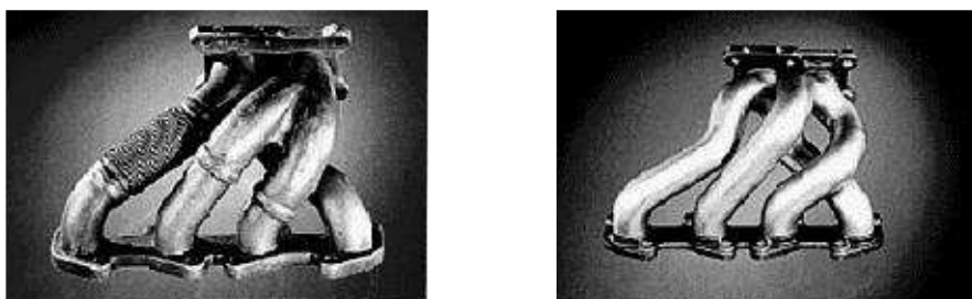
FIG. 83: Réalisation par emboutissage / soudage (à gauche) et hydroformage (à droite) Schuler Hydroforming 1998
