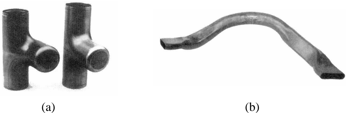
FIG. 85: (a) Hydroformage de piquages en T et (b) pièce de chassis pré-cintrée et hydroformée [Dohmann99]
