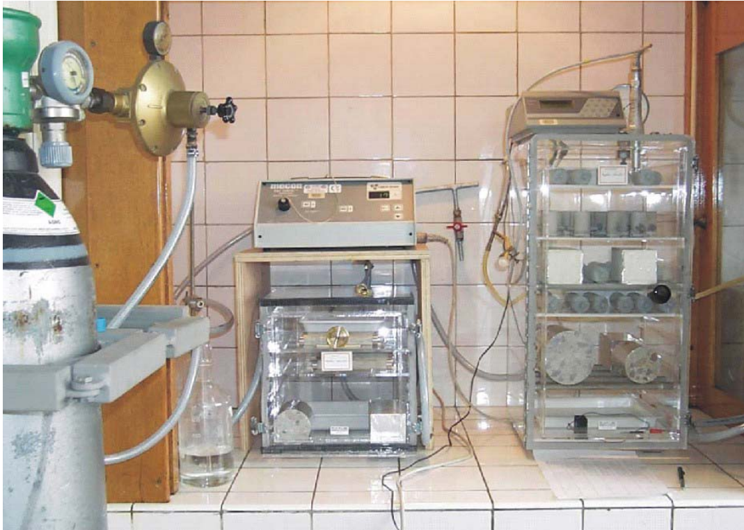
Fig. 2.1 – Dispositif de carbonatation accélérée du L.C.P.C..
