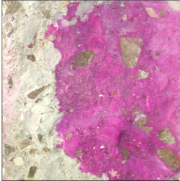
Fig. 3.15 – Front de carbonatation détecté par projection de phénolphtaléine sur une éprouvette de béton M25 après 14 jours de carbonatation accélérée.
