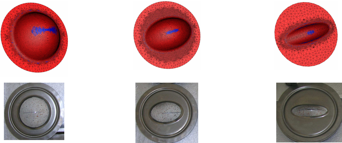
Figure 6.17 : Prédiction de la striction : En haut prédiction du critère de FMM / En bas photos des éprouvette.
