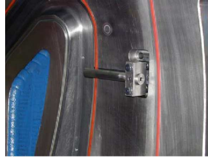
Figure 6.3 : système d'injection en hydroformage de flans doubles [Pasino et al, 2002]
