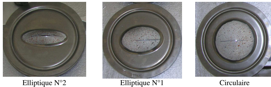
Figure 3.6 : Photos de trois éprouvettes marquées à la peinture et gonflées jusqu'à rupture.
