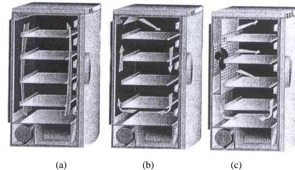
Figure I-4 : Les trois types de froid<sup>⊗</sup> ; (a) froid statique, (b) froid brassé, (c) froid ventilé (d'après Roussille (2002))
