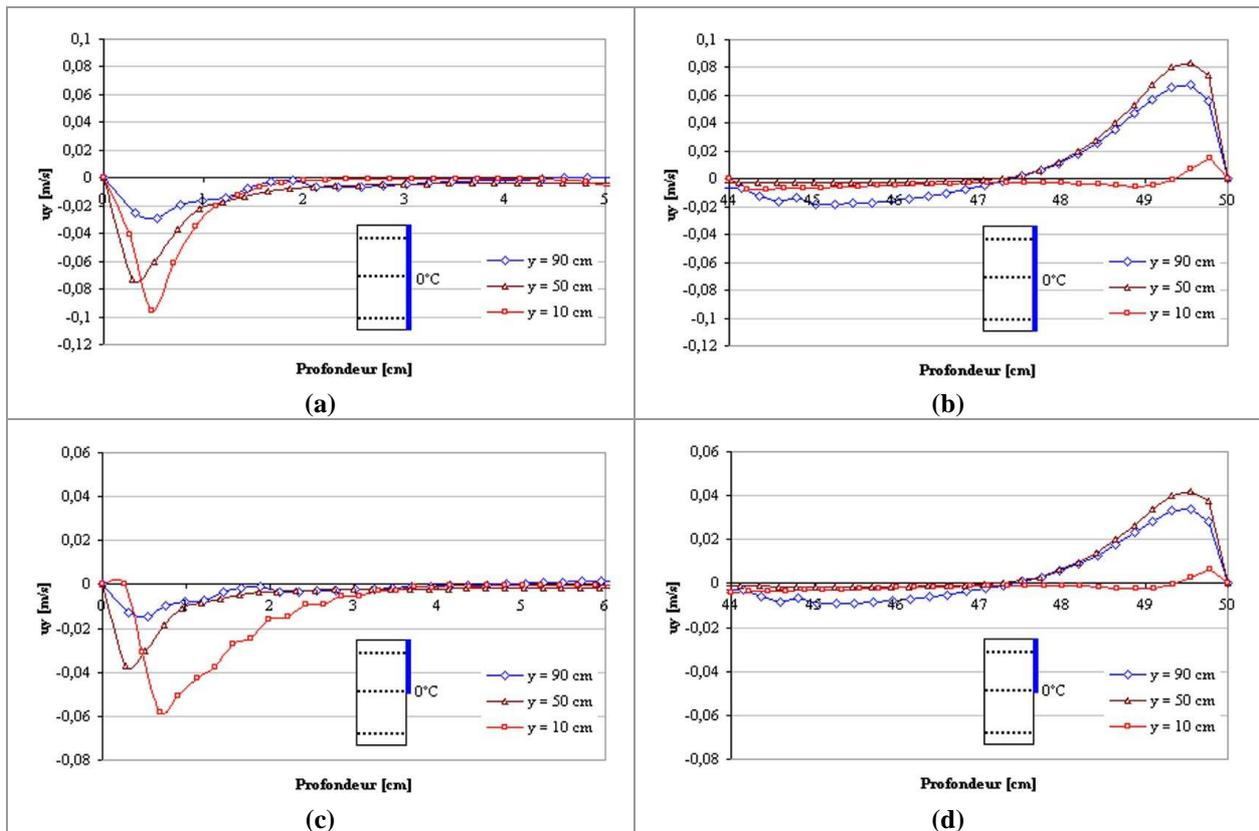
**Figure A-60 : Couche limite hydrodynamique à différentes hauteurs sur le plan de symétrie de la maquette remplie de sphères creuses, (a) Couche limite côté paroi froide (100% à 0°C) ; (b) Couche limite côté paroi vitrée (100% à 0°C) ; (c) Couche limite côté paroi froide (50% à 0°C) ; (d) Couche limite côté paroi vitrée (50% à 0°C)**
