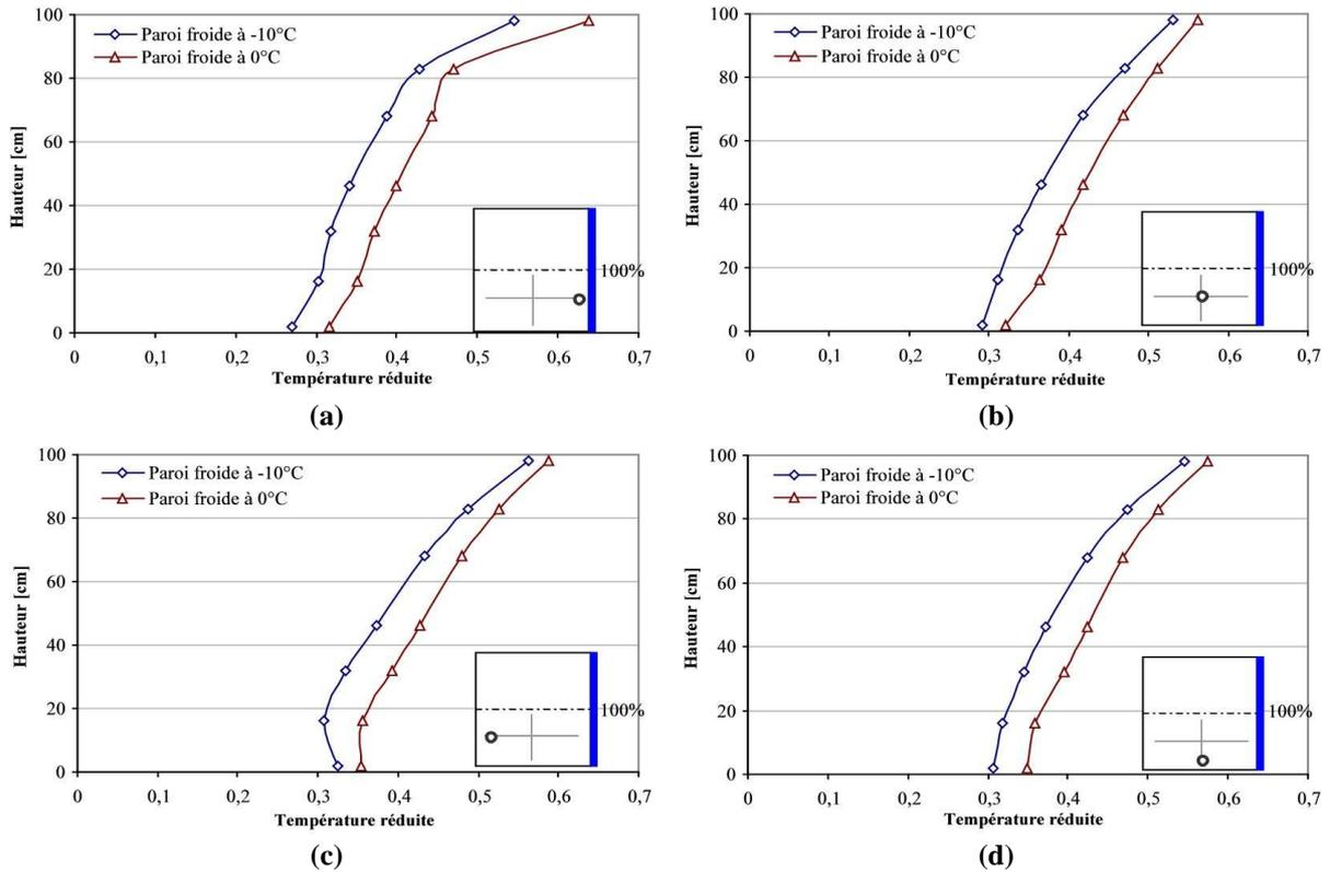
**Figure IV-36 : Influence de température de la paroi froide sur les profils verticaux de température dans la maquette vide ; (a) Près de la paroi froide ; (b) A mi-distance entre la paroi froide et la paroi vitrée en face ; (c) Près de la paroi vitrée (en face de la paroi froide) ; (d) Près de la paroi vitrée latérale**
