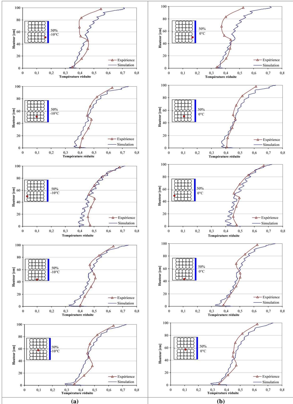
**Figure A-73 : Comparaison Expérience/ Simulation CFD des profils verticaux de température pour différentes positions de la maquette vide remplie avec quatre blocs de sphères creuses ; (a) 50% à  $-10^{\circ}\text{C}$ ; (b) 50% à  $0^{\circ}\text{C}$**
