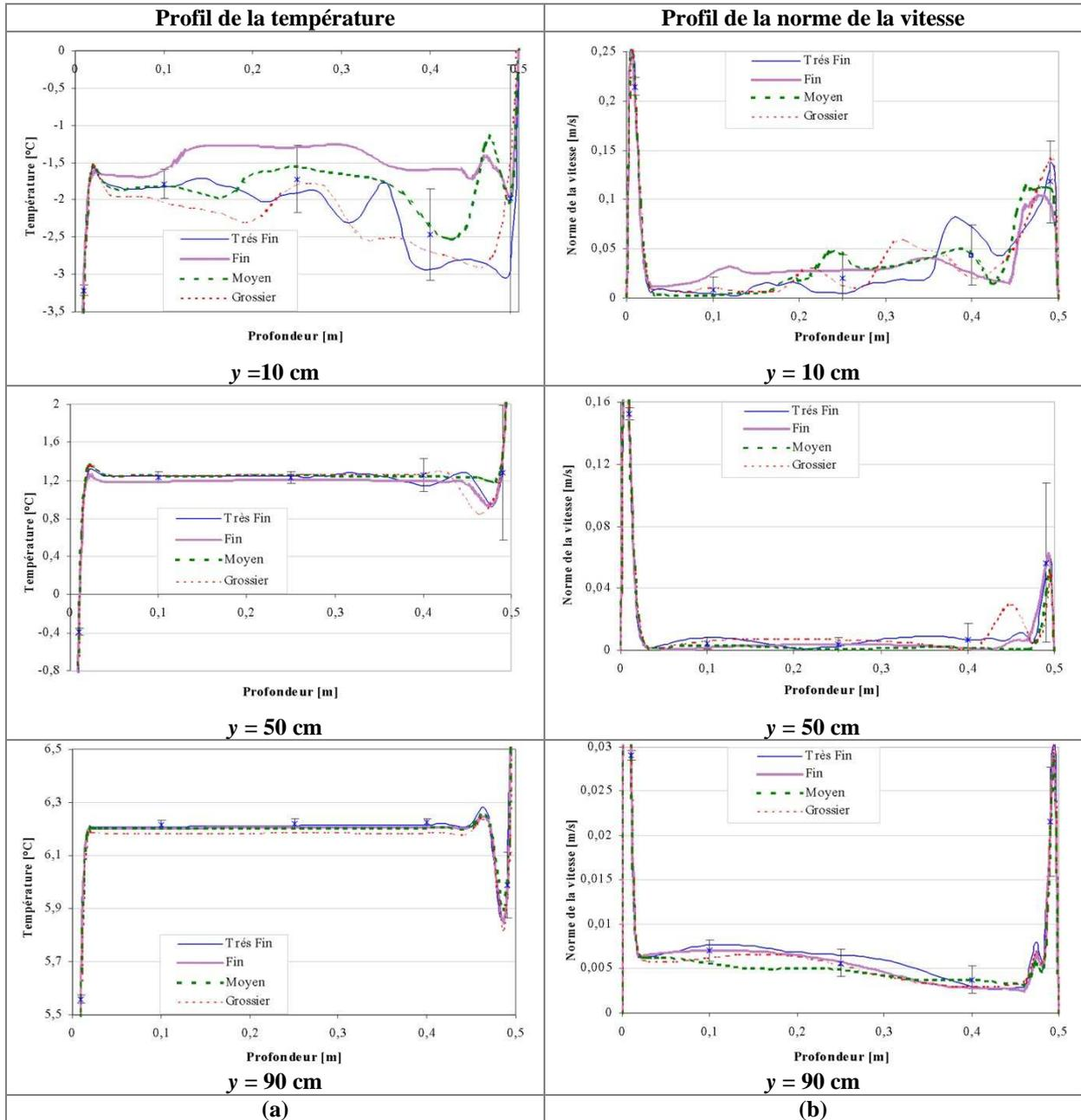
Figure III-10 : Etude de la sensibilité de la solution aux maillages ; (a) Cas de la température pour trois hauteurs différentes :  $y=10\text{cm}$ ,  $y=50\text{cm}$  et  $y=90\text{cm}$  ; (b) Cas de la norme de la vitesse pour trois hauteurs différentes :  $y=10\text{cm}$ ,  $y=50\text{cm}$  et  $y=90\text{cm}$  ; (les croix et les barres représentent la moyenne  $\pm 2$  fois l'écart type aux points de contrôle du maillage Très Fin)
