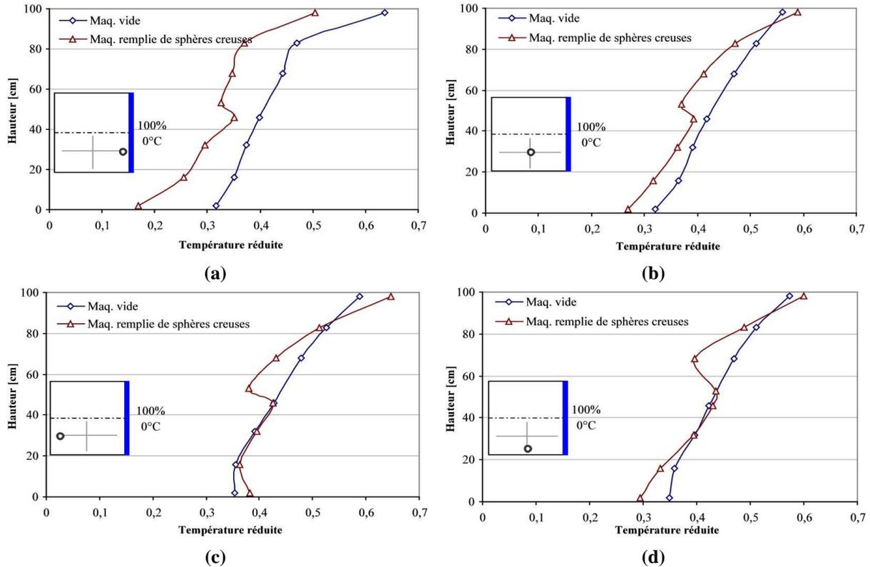
**Figure IV-50 : Comparaison des profils verticaux de température entre le cas de la maquette vide et le cas de la maquette remplie avec quatre blocs de sphères creuses-Totalité de la paroi froide maintenue à 0°C (a) Près de la paroi froide ; (b) A mi-distance entre la paroi froide et la paroi vitrée en face ; (c) Près de la paroi vitrée (en face de la paroi froide) ; (d) Près de la paroi vitrée latérale**
