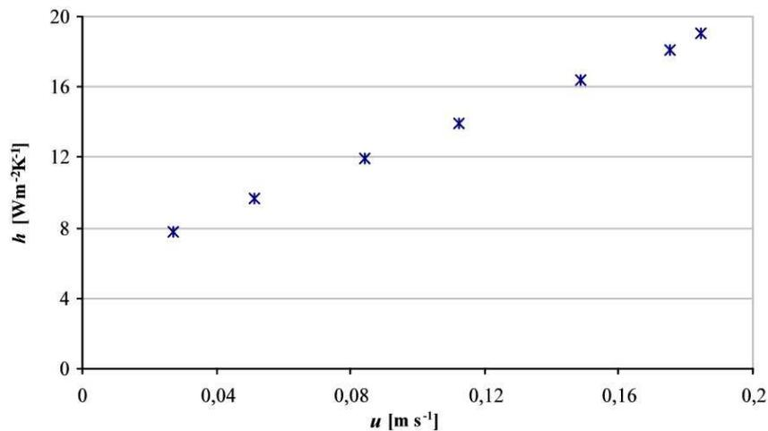
Figure IV-9 : Influence de la vitesse de l'air sur le coefficient de transfert de chaleur par convection (5<sup>ème</sup> rangée)
