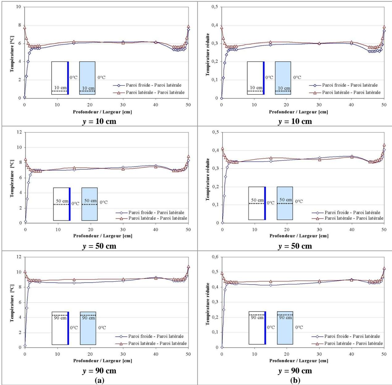
**Figure A-41 : Comparaison de la distribution de la couche limite thermique entre la paroi froide et la paroi latérale en face et entre les deux parois latérales sur le plan médian-Totalité de la paroi froide maintenue à 0°C - Cas de la maquette vide ; (a)Température en fonction de la profondeur ; (b) Température réduite en fonction de la profondeur**
