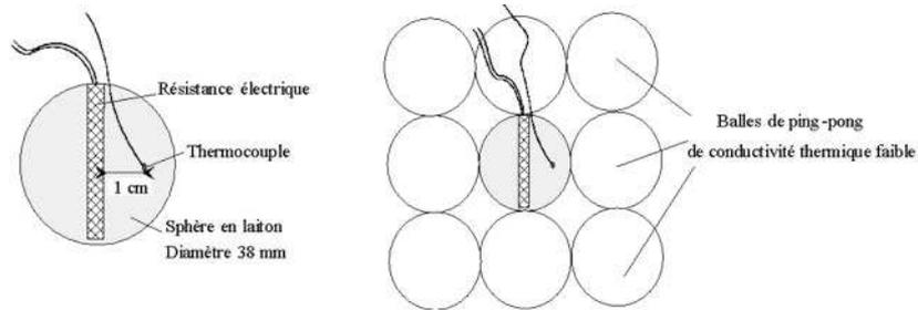
**Figure II-3 : Schéma du capteur sphérique utilisé pour la mesure du coefficient de transfert thermique**
