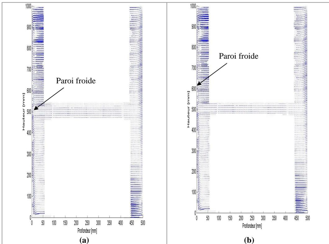
Figure A-58 : Champ de vitesse sur le plan de symétrie de la maquette remplie avec quatre blocs de sphères creuses, (a) 100% de la paroi froide maintenue à  $0^{\circ}\text{C}$  ; (b) 50% de la paroi froide maintenue à  $0^{\circ}\text{C}$
