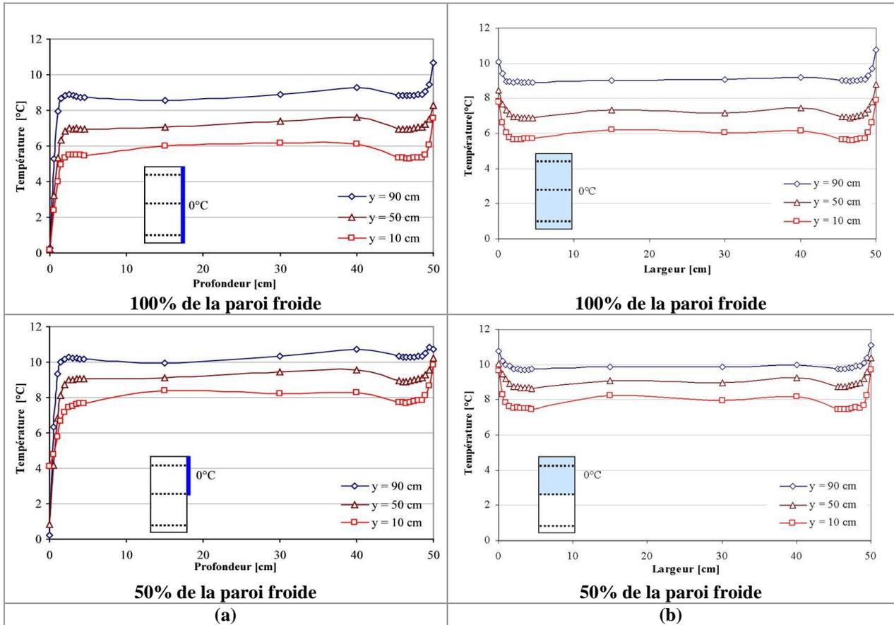
**Figure A-39 : Distribution de la couche limite thermique sur trois hauteurs différentes ( $y = 10\text{cm}$ ,  $y = 50\text{cm}$  et  $y = 90\text{cm}$ ) - Cas de la maquette vide ; (a) Entre la paroi froide et la paroi latérale en face ; (b) Entre les deux parois latérales sur le plan médian**
