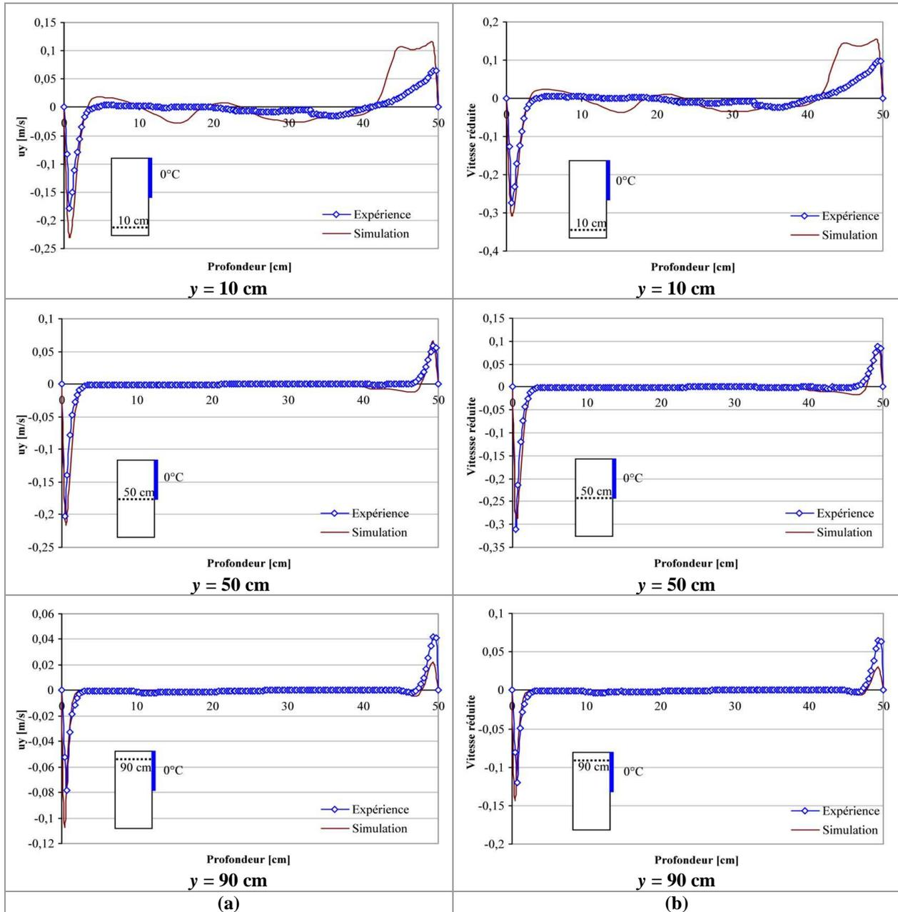
**Figure A-37 : Comparaison Expérience/ Simulation CFD de la distribution de la couche limite hydrodynamique sur différentes hauteurs-Maquette vide –Moitié supérieure de la paroi froide maintenue à 0°C, (a) vitesse en fonction de profondeur ; (b) vitesse réduite en fonction de profondeur**
