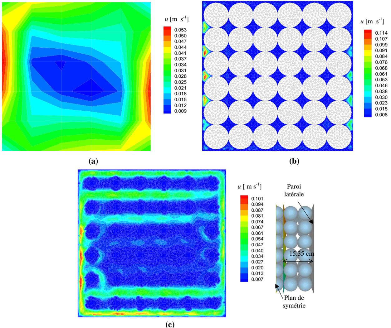
**Figure IV-67 : Norme de la vitesse interstitielle; (a) Code 'macro-poreux' <sup>⊗</sup>; (b) Simulation CFD - Plan de symétrie ; (c) Simulation CFD - Plan situé à 15.35 cm de la paroi latérale**
