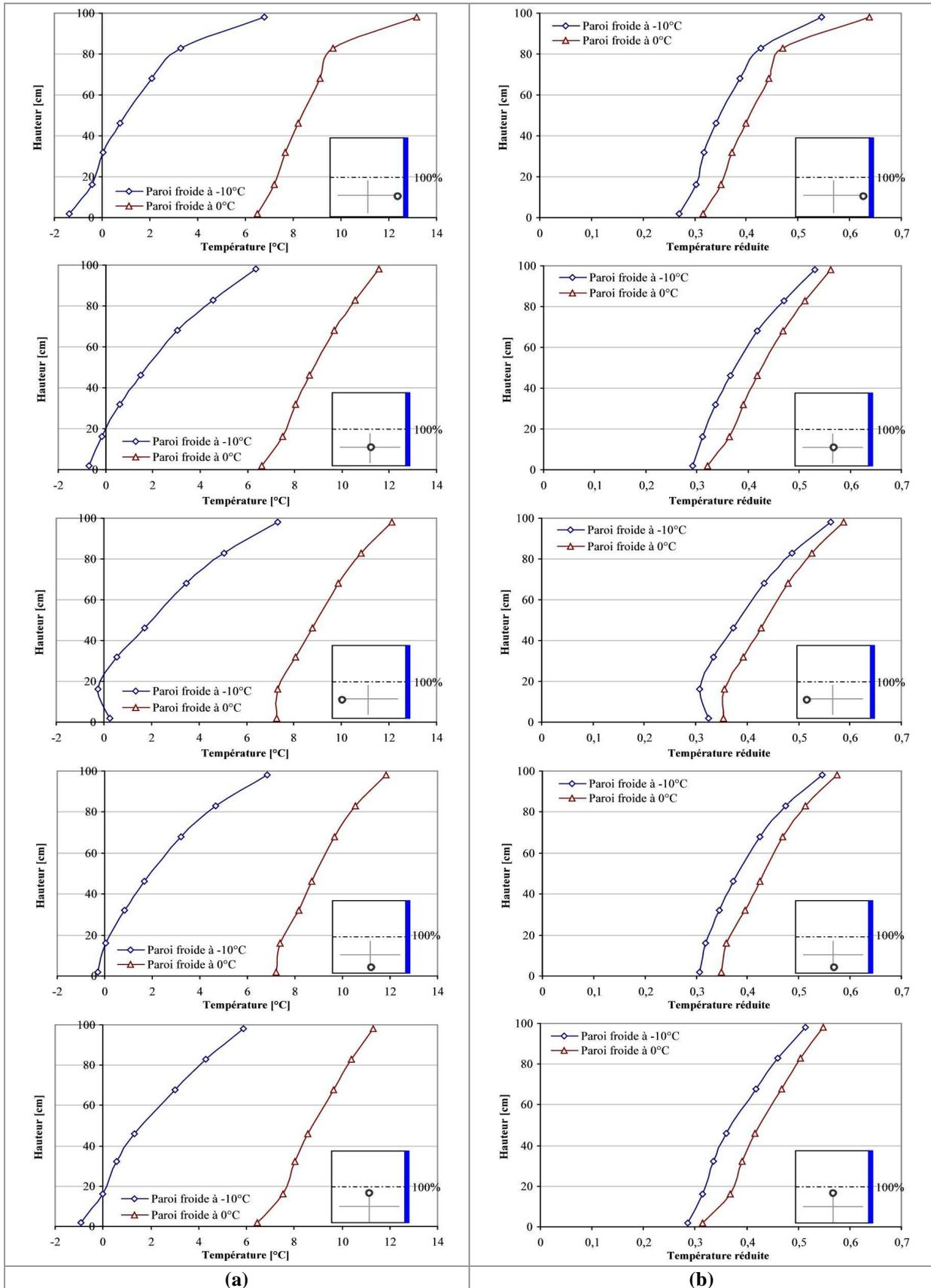
**Figure A-44 : Profils verticaux de température à différentes positions dans la maquette vide et pour deux températures de la paroi froide (-10°C et 0°C) - 100% de la paroi froide (a) Hauteur en fonction de la température; (b) Hauteur en fonction de la température réduite**
