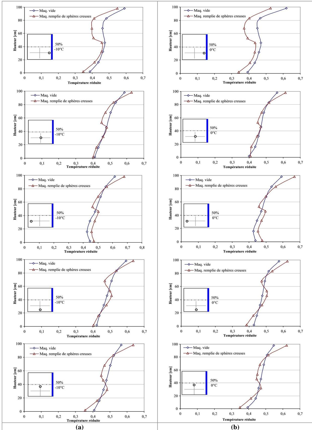
Figure A-71 : Comparaison des profils verticaux de température entre le cas de la maquette vide et le cas de la maquette remplie avec quatre blocs de sphères creuses (a) 50% à  $-10^{\circ}\text{C}$  ; (b) 50% à  $0^{\circ}\text{C}$
