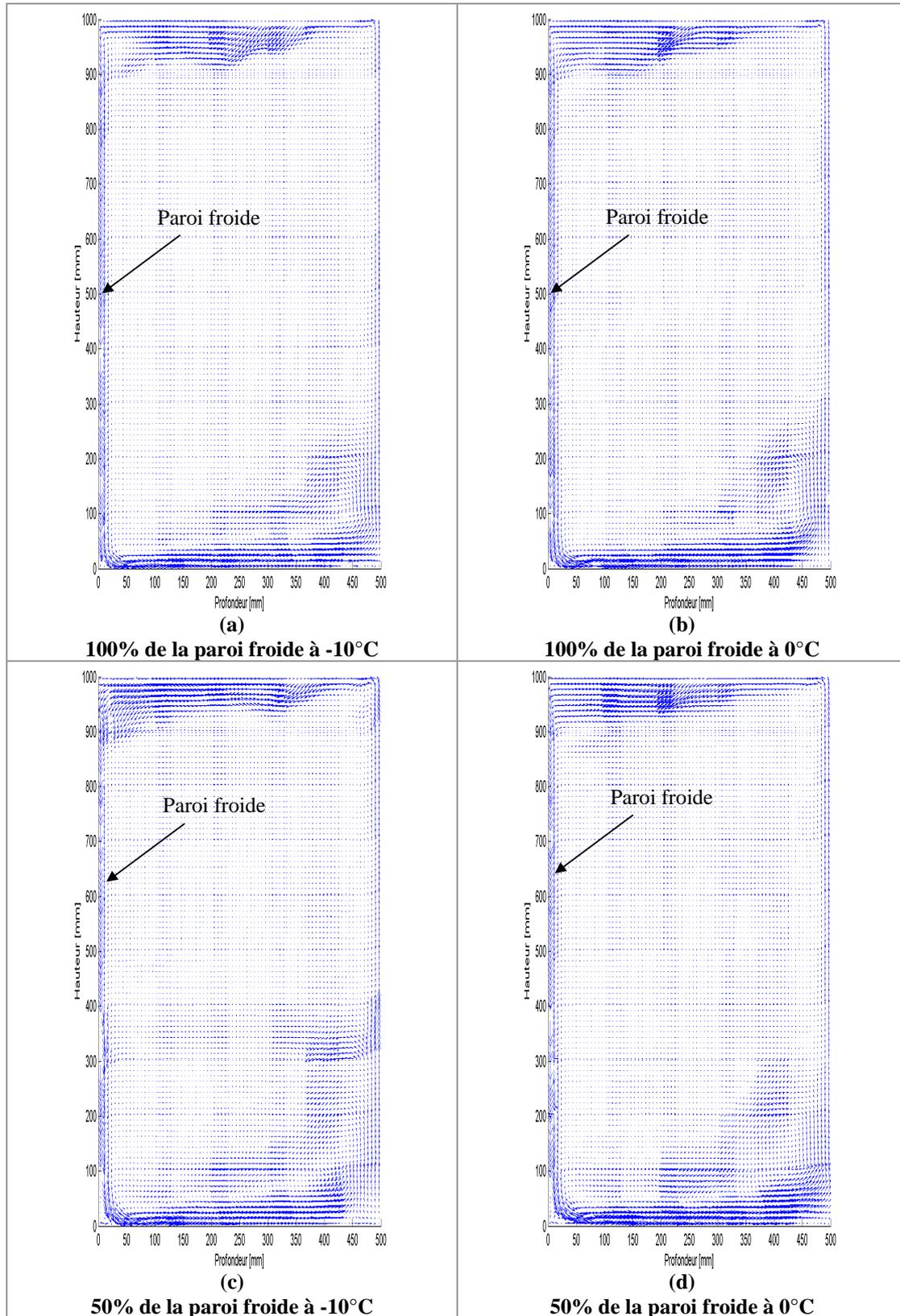
Figure A-20 : Champ de vitesse sur le plan de symétrie de la maquette vide, (a) 100% de la paroi froide maintenue à  $-10^{\circ}\text{C}$  ; (b) 100% de la paroi froide maintenue à  $0^{\circ}\text{C}$  ; (c) 50% de la paroi froide maintenue à  $-10^{\circ}\text{C}$  ; (d) 50% de la paroi froide maintenue à  $0^{\circ}\text{C}$  ;
