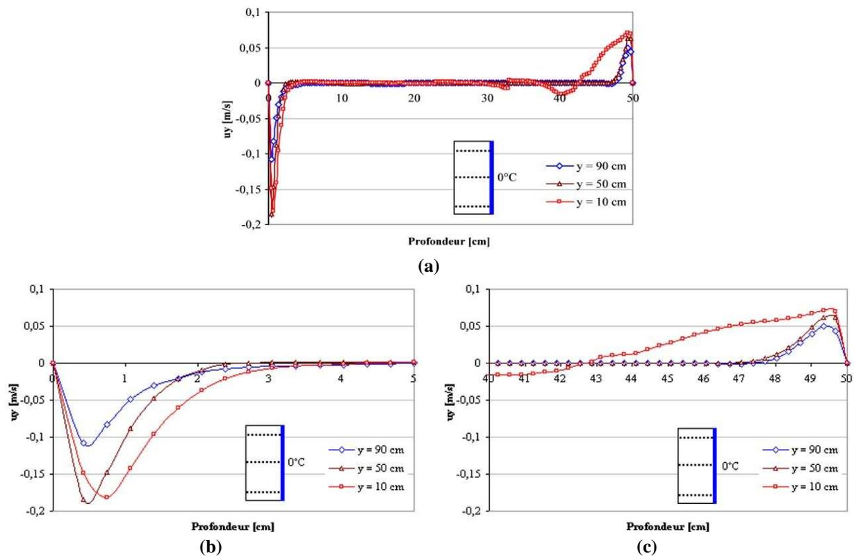
**Figure IV-21 : Profil horizontal de la vitesse ( $u_y$ ) sur trois hauteurs sur le plan de symétrie – Totalité de la paroi froide maintenue à  $0^\circ\text{C}$ , (a) Vue globale ; (b) Couche limite côté paroi froide ; (c) Couche limite côté paroi vitrée**
