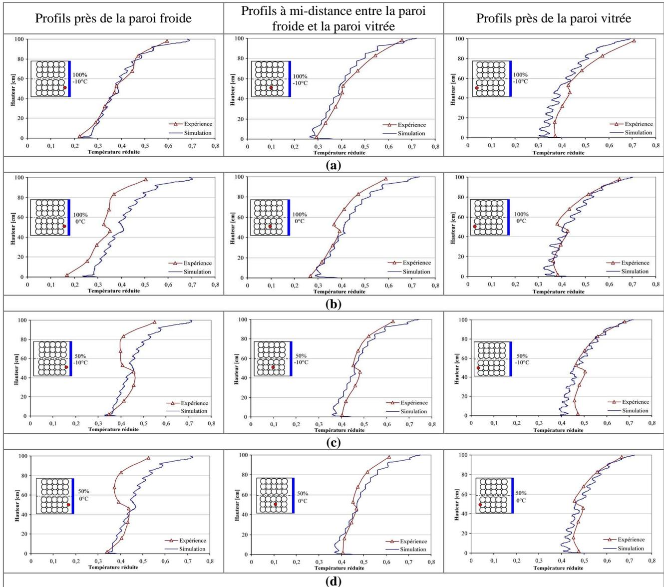
**Figure IV-54 : Comparaison des résultats expérimentaux avec les résultats des simulations pour les profils verticaux de température dans la maquette remplie avec quatre blocs de sphères creuses (a) 100% de la paroi froide maintenue à  $-10^{\circ}\text{C}$  ; (b) 100% de la paroi froide maintenue à  $0^{\circ}\text{C}$  ; (c) 50% de la paroi froide maintenue à  $-10^{\circ}\text{C}$  ; (d) 50% de la paroi froide maintenue à  $0^{\circ}\text{C}$**
