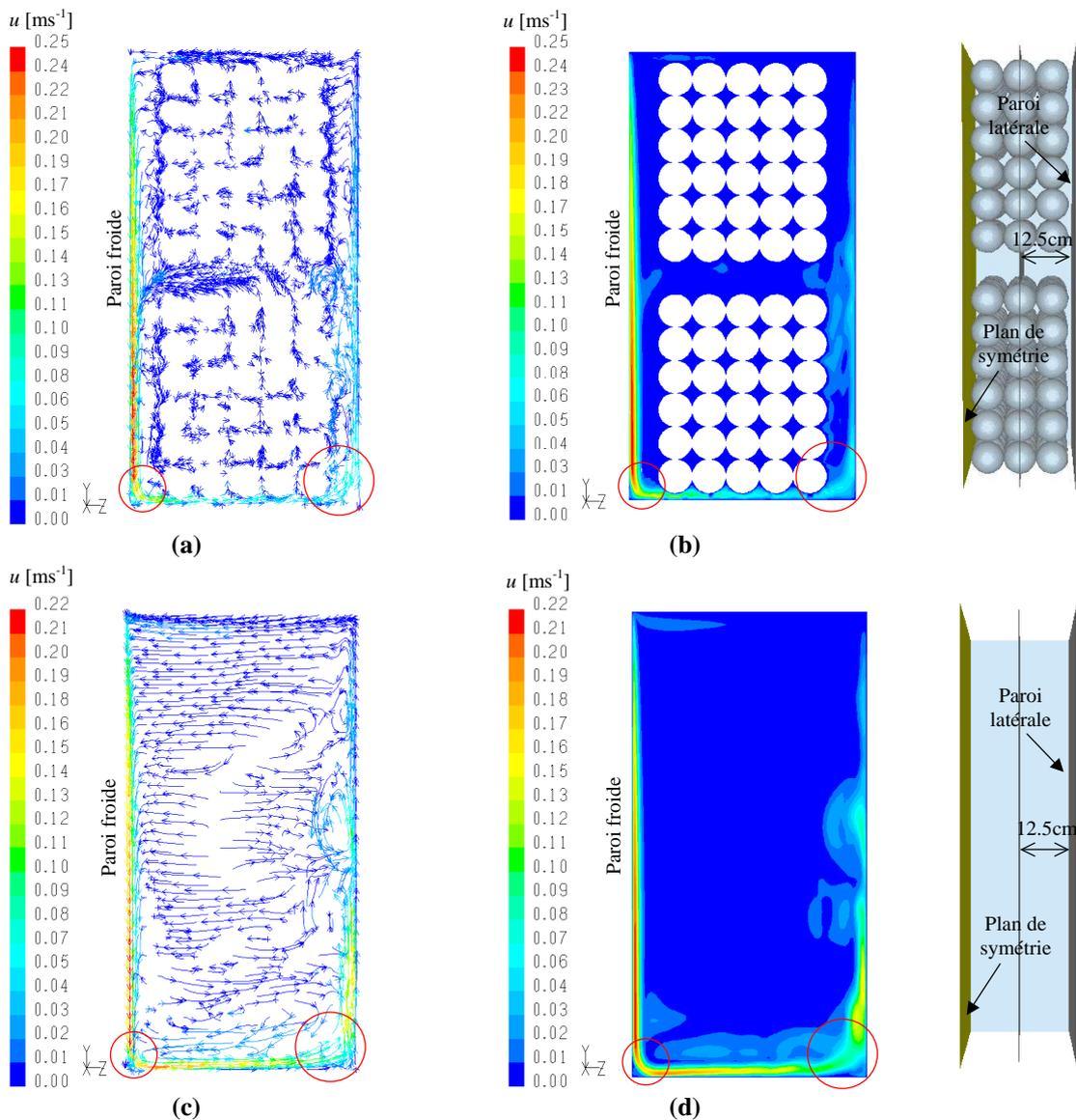
**Figure IV-47 : Vitesse sur le plan situé à 12.5 cm de la paroi latérale (100% à 0°C) ; (a) Lignes de courants – Cas de la maquette remplie de sphères creuses ; (b) Norme de la vitesse – Cas de la maquette remplie de sphères creuses ; (c) Lignes de courants – Cas de la maquette vide ; (d) Norme de la vitesse – Cas de la maquette vide**
