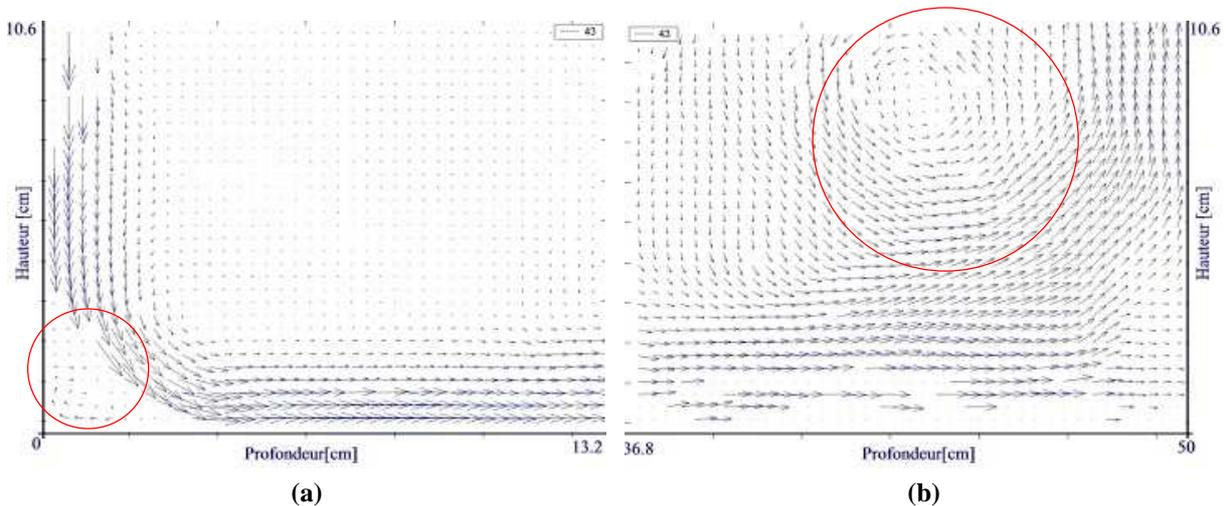
Figure IV-29 : Mise en évidence par mesure PIV de boucles de re-circulations en bas de la maquette vide -Totalité de la paroi froide maintenue à -10°C ; (a) Près de la paroi froide ( $u_{max} \approx 0.25 \text{ m s}^{-1}$ ); (b) Près de la paroi vitrée ( $u_{max} \approx 0.13 \text{ m s}^{-1}$ )
