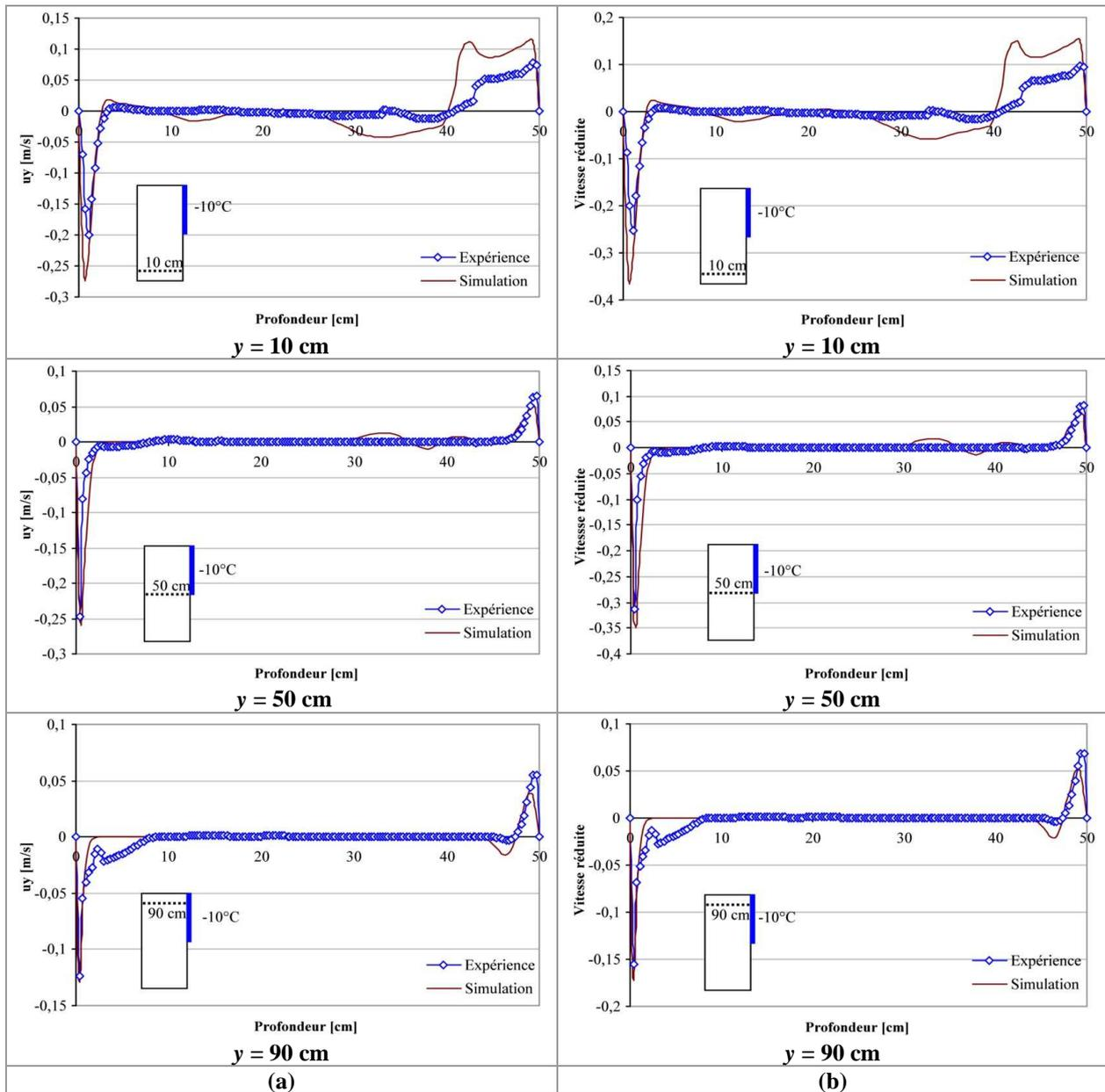
Figure A-36 : Comparaison Expérience/ Simulation CFD de la distribution de la couche limite hydrodynamique sur différentes hauteurs-Maquette vide –Moitié supérieure de la paroi froide maintenue à  $-10^{\circ}\text{C}$ , (a) vitesse en fonction de profondeur ; (b) vitesse réduite en fonction de profondeur
