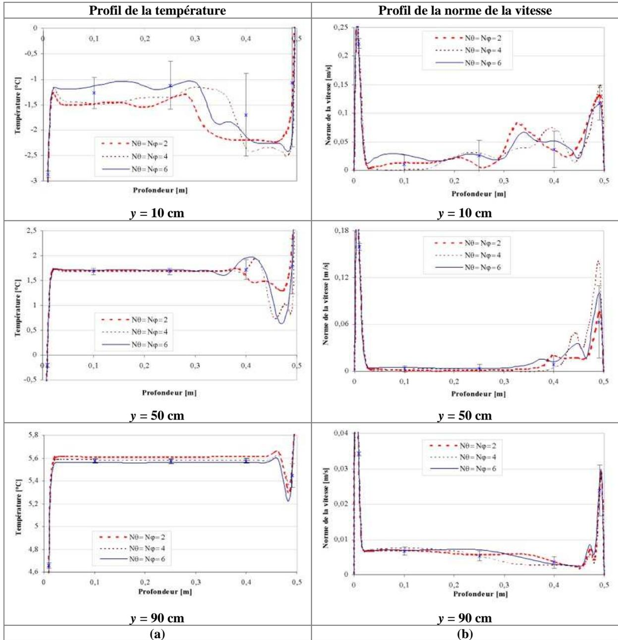
Figure III-12 : Etude de la sensibilité de la solution à la discrétisation angulaire ; (a) Profil de la température pour trois hauteurs différentes  $y=10$ cm,  $y=50$ cm et  $y=90$ cm ; (b) Profil de la norme de la vitesse pour trois hauteurs différentes  $y=10$ cm,  $y=50$ cm et  $y=90$ cm ; (les croix et les barres représentent la moyenne  $\pm 2$  fois l'écart type aux points de contrôle de la discrétisation angulaire  $N_\theta = N_\varphi = 6$ )
