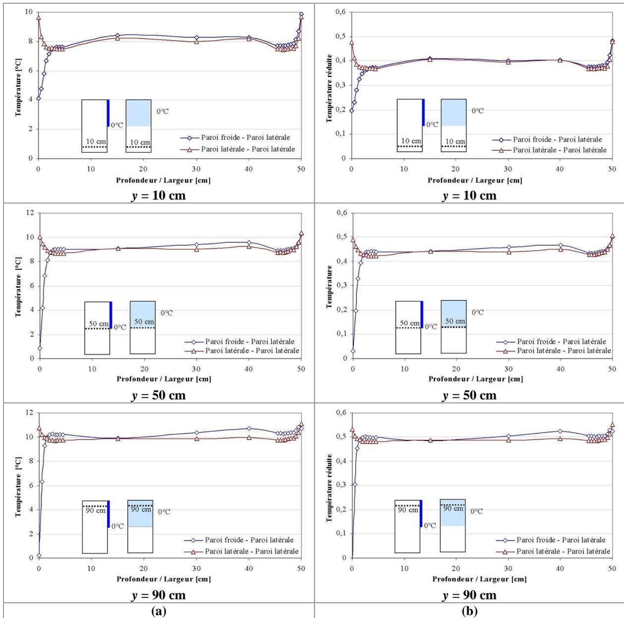
**Figure A-42 : Comparaison de la distribution de la couche limite thermique entre la paroi froide et la paroi latérale en face et entre les deux parois latérales sur le plan médian-Moitié supérieure de la paroi froide maintenue à 0°C- Cas de la maquette vide ; (a)Température en fonction de la profondeur (b) Température réduite en fonction de la profondeur**
