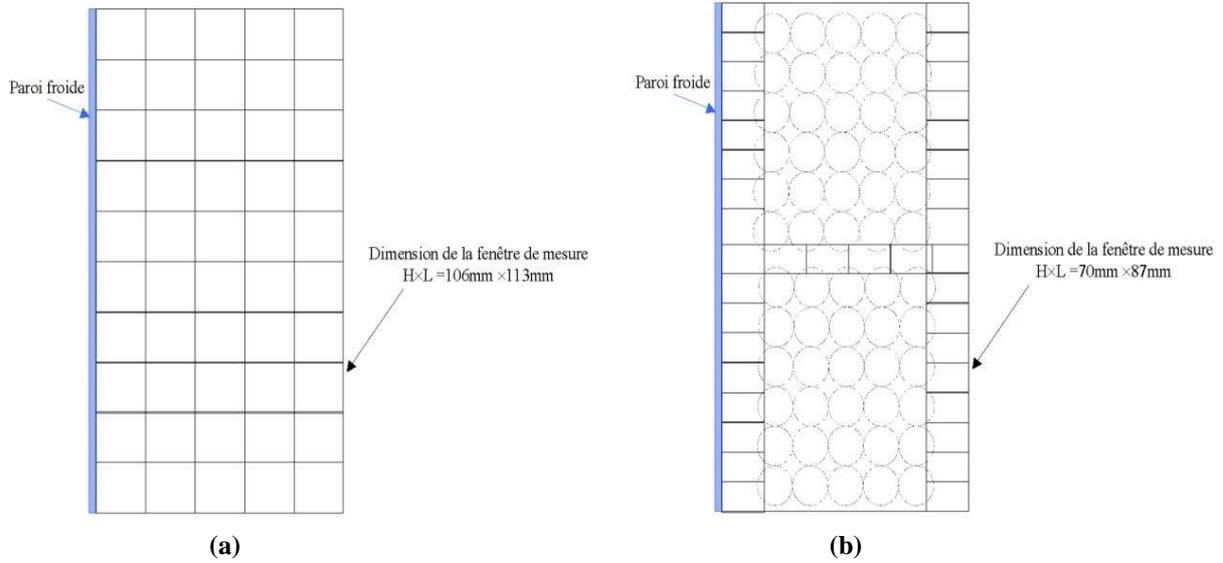
**Figure II-23 : Différentes fenêtres de mesure par PIV sur le plan de symétrie ; (a) Cas de la maquette vide, (b) Cas de la maquette remplie de 4 blocs de sphères creuses**
