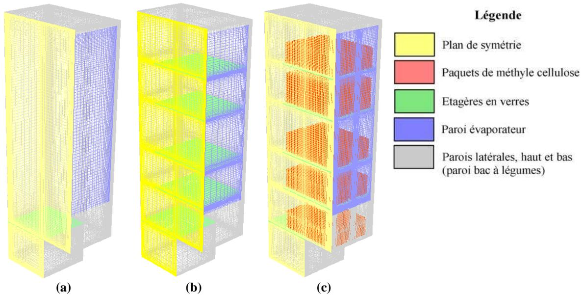
Figure III-6 : Maillages réalisés sur Fluent 4.1 (a)- Réfrigérateur vide ; (b)- Réfrigérateur équipé d'étagères en verre ; (c)- Réfrigérateur équipé d'étagères en verre et chargé de produits
