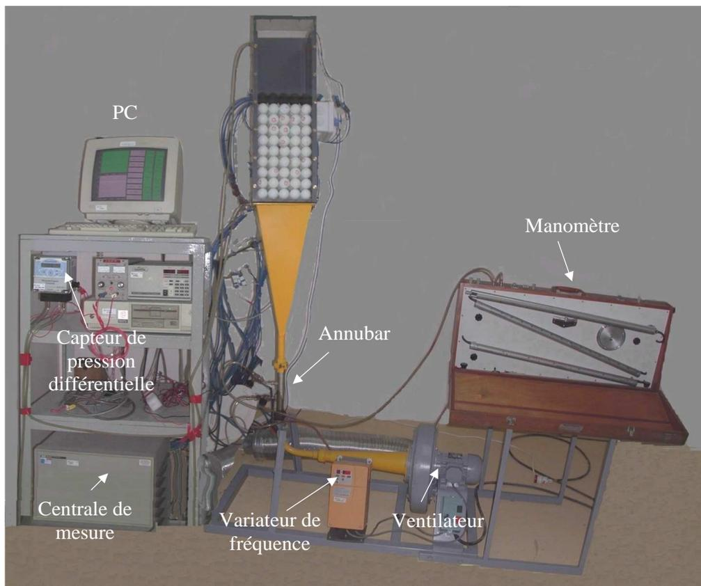
**Figure A-11 : Dispositif expérimental utilisé pour la caractérisation des différents modes d'échange dans un empilement ordonné de sphères**
