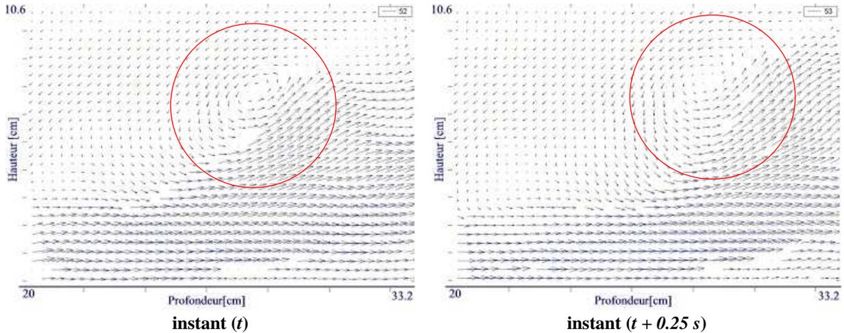
**Figure IV-22 :** Exemple de champ instantané de vitesse sur une fenêtre de mesure PIV– (Position de la fenêtre de mesure : Profondeur entre 20 cm et 33.2 cm ; Hauteur entre 0 et 10.6 cm)- Cas de la maquette vide avec 100% de la paroi froide maintenue à  $-10^{\circ}\text{C}$ , ( $u_{max} \approx 0.12 \text{ m s}^{-1}$ )
