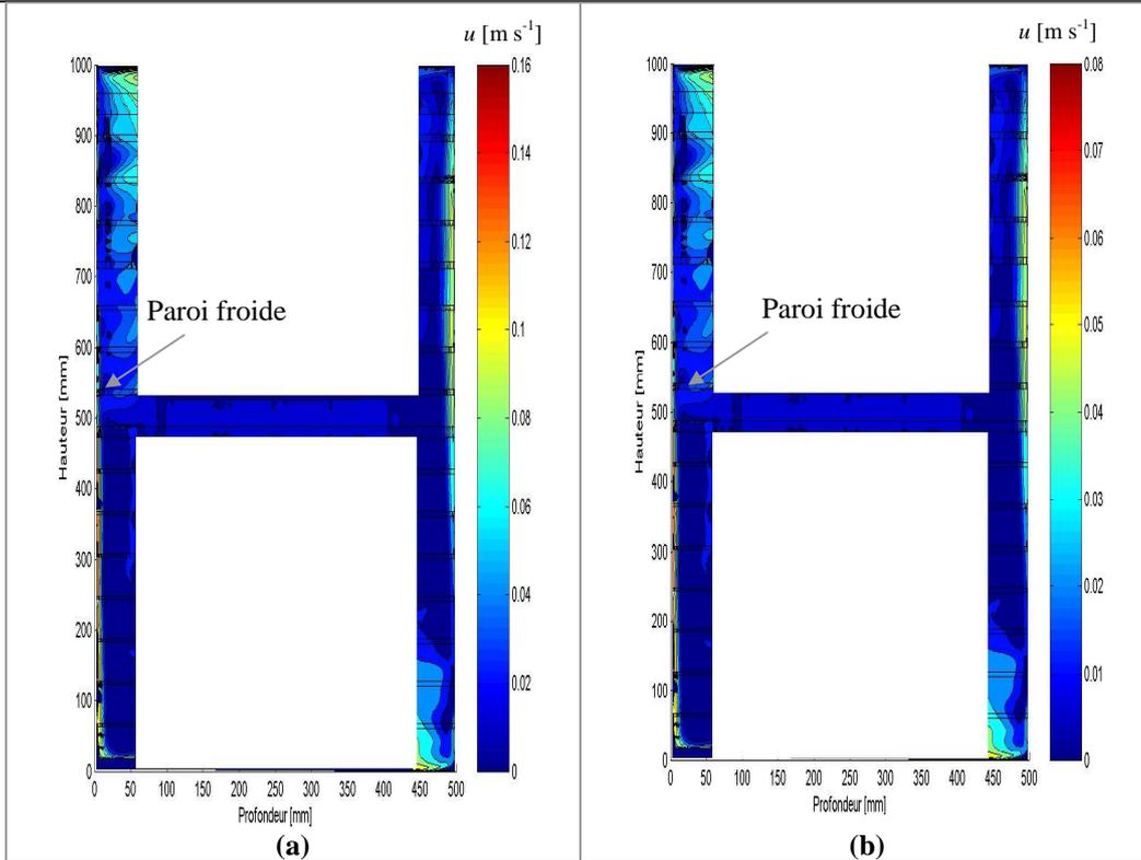
Figure A-57 : Norme de la vitesse sur le plan de symétrie de la maquette remplie avec quatre blocs de sphères creuses ; (a) 100% de la paroi froide maintenue à  $-0^{\circ}\text{C}$  ; (b) 50% de la paroi froide maintenue à  $0^{\circ}\text{C}$
