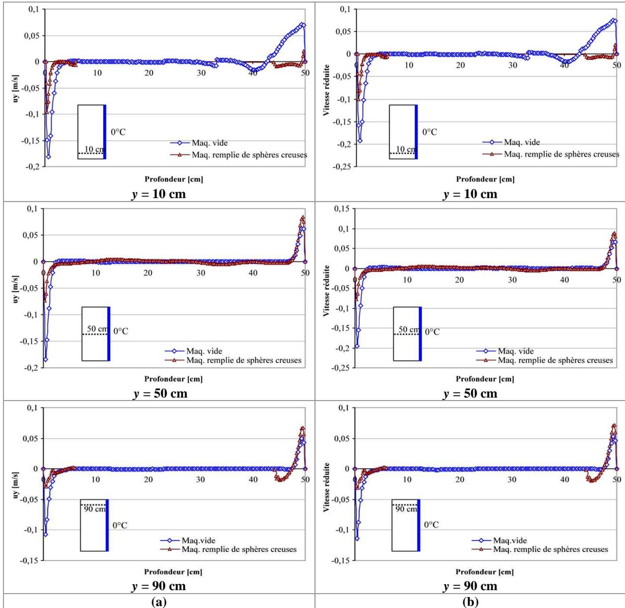
**Figure A-62 : Comparaison des profils horizontaux de vitesse entre le cas de la maquette vide et le cas de la maquette remplie avec quatre blocs de sphères creuses (100% à  $0^\circ\text{C}$ ), (a) vitesse en fonction de profondeur ; (b) vitesse réduite en fonction de profondeur**
