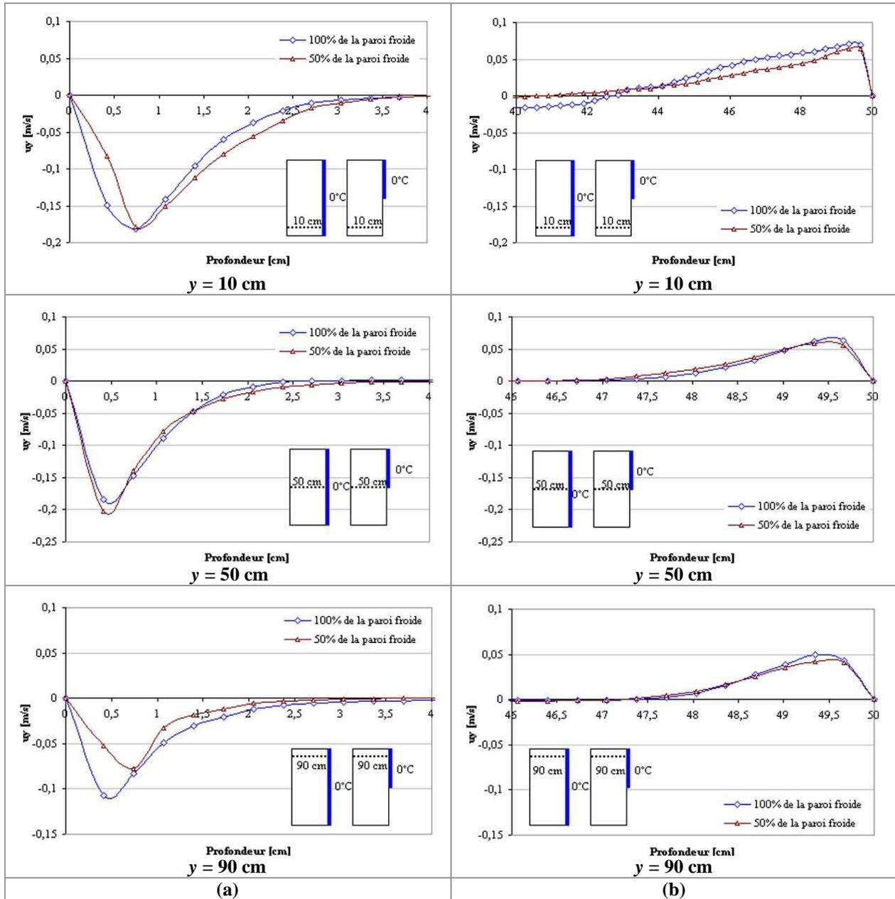
**Figure A-33 : Couche limite hydrodynamique à différentes hauteurs sur le plan de symétrie de la maquette vide- Deux surfaces de la paroi froide (100% et 50%)- Paroi froide maintenue à  $0^{\circ}\text{C}$  (a) Couche limite côté paroi froide; (b) Couche limite côté paroi vitrée**
