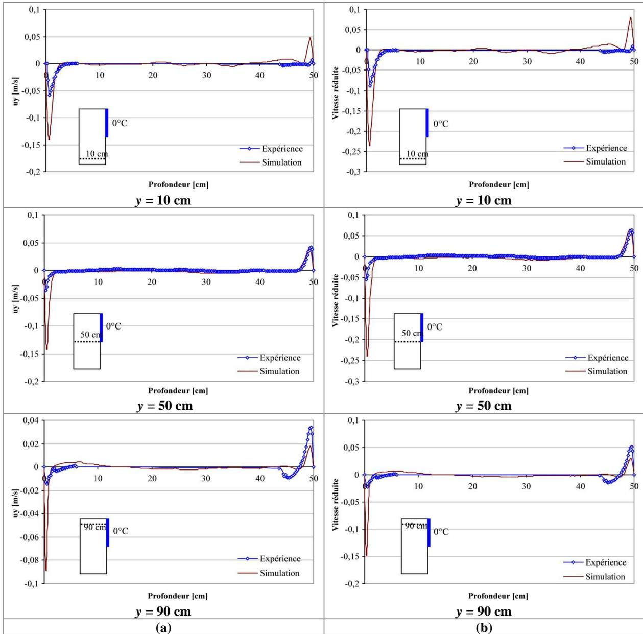
**Figure A-65 : Comparaison Expérience/ Simulation CFD de la distribution de la couche limite hydrodynamique sur différentes hauteurs-Maquette remplie de quatre blocs de sphères creuses – Moitié supérieure de la paroi froide maintenue à  $0^\circ\text{C}$ , (a) Vitesse en fonction de profondeur ; (b) Vitesse réduite en fonction de profondeur**
