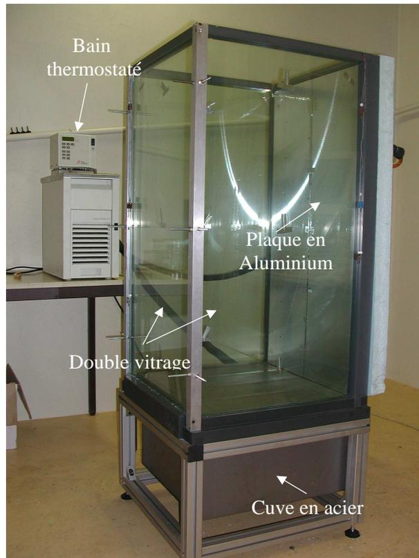
Figure A-12 : Maquette de réfrigérateur vide
