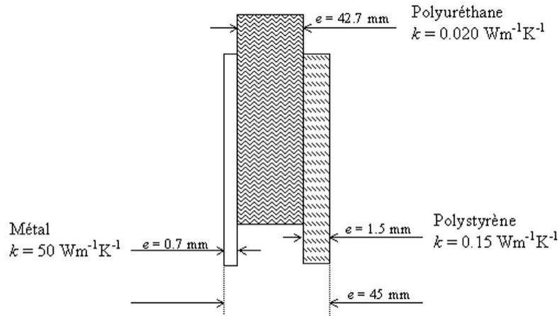
Figure II-10 : Caractéristiques thermiques d'une paroi d'un réfrigérateur
