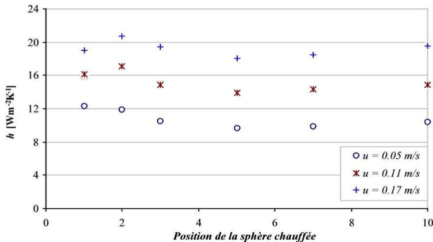
Figure IV-11 : Influence de la position du produit dans l'empilement sur le coefficient de transfert convectif
