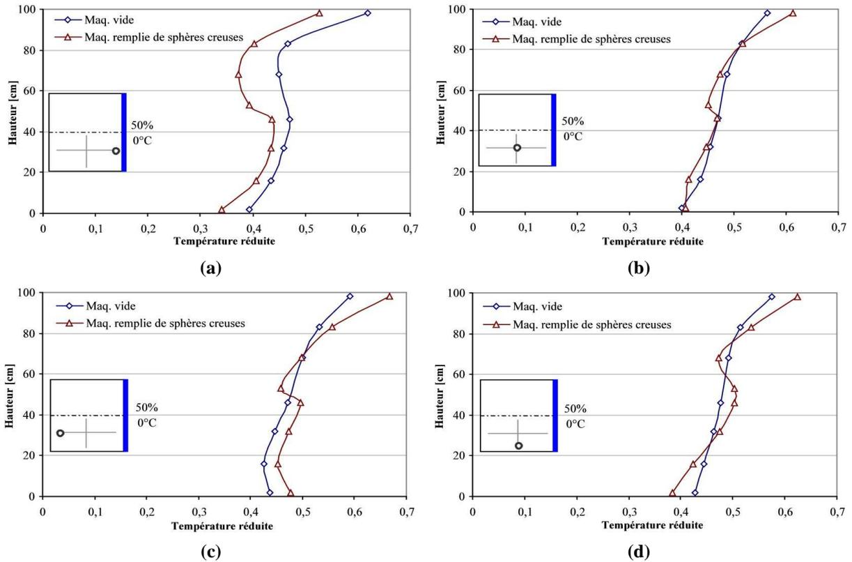
**Figure IV-51 : Comparaison des profils verticaux de température entre le cas de la maquette vide et le cas de la maquette remplie avec quatre blocs de sphères creuses-Moitié supérieure de la paroi froide maintenue à 0°C (a) Près de la paroi froide ; (b) A mi-distance entre la paroi froide et la paroi vitré en face ; (c) Près de la paroi vitrée (en face de la paroi froide) ; (d) Près de la paroi vitrée latérale**
