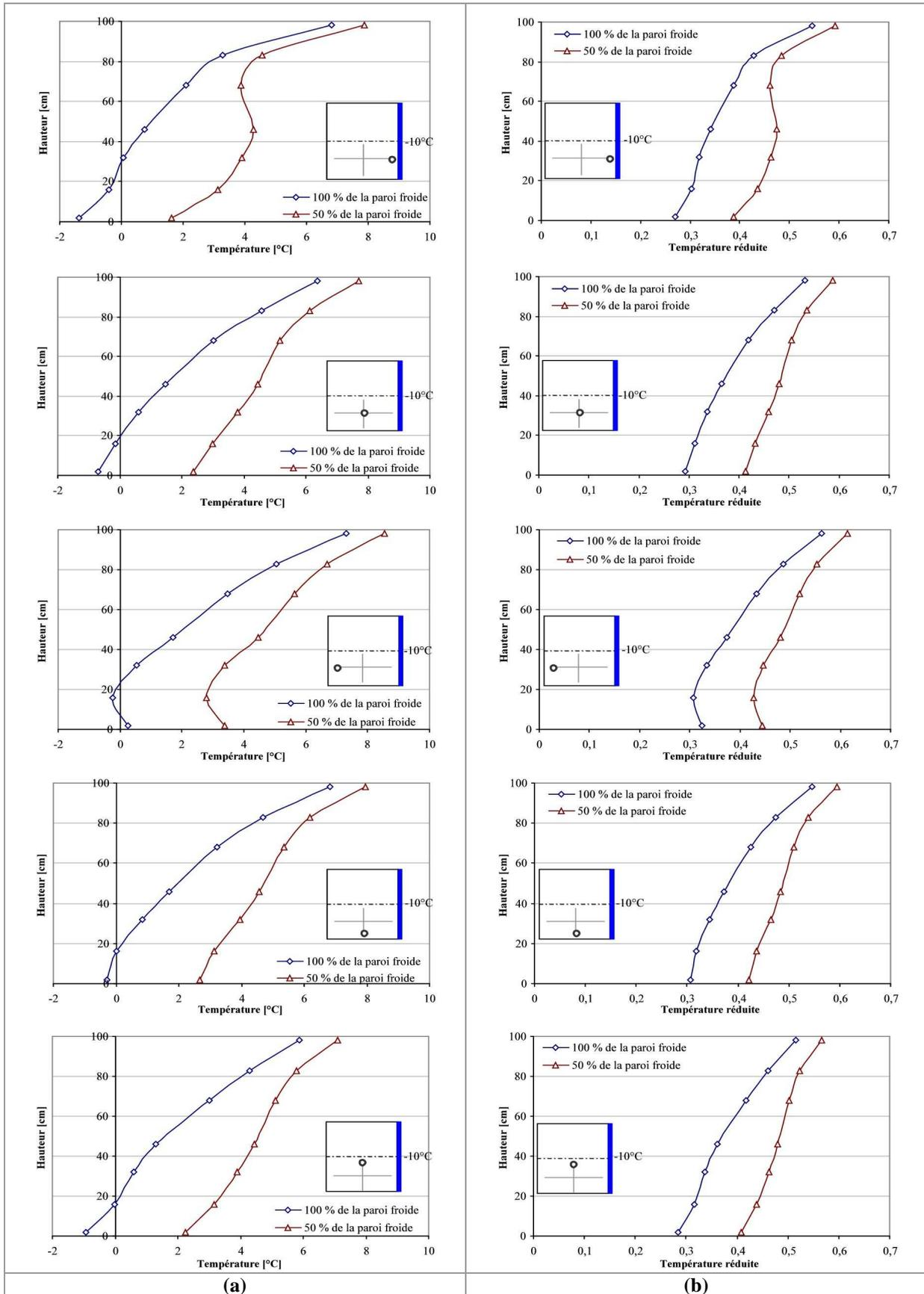
**Figure A-46 : Profils verticaux de température à différentes positions dans la maquette vide et pour les deux surfaces de la paroi froide (100% et 50%) - Paroi froide maintenue à -10°C ; (a) Hauteur en fonction de la température; (b) Hauteur en fonction de la température réduite**
