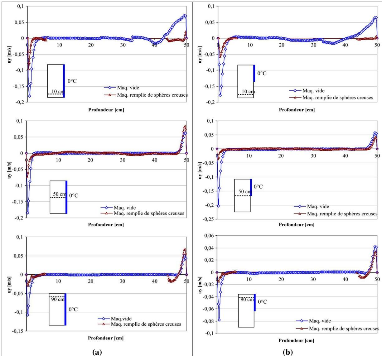
Figure IV-45 : Comparaison des profils horizontaux de vitesse entre le cas de la maquette vide et le cas de la maquette remplie avec quatre blocs de sphères creuses, (a) 100% de la paroi froide à  $0^\circ\text{C}$  ; (b) 50% de la paroi froide à  $0^\circ\text{C}$
