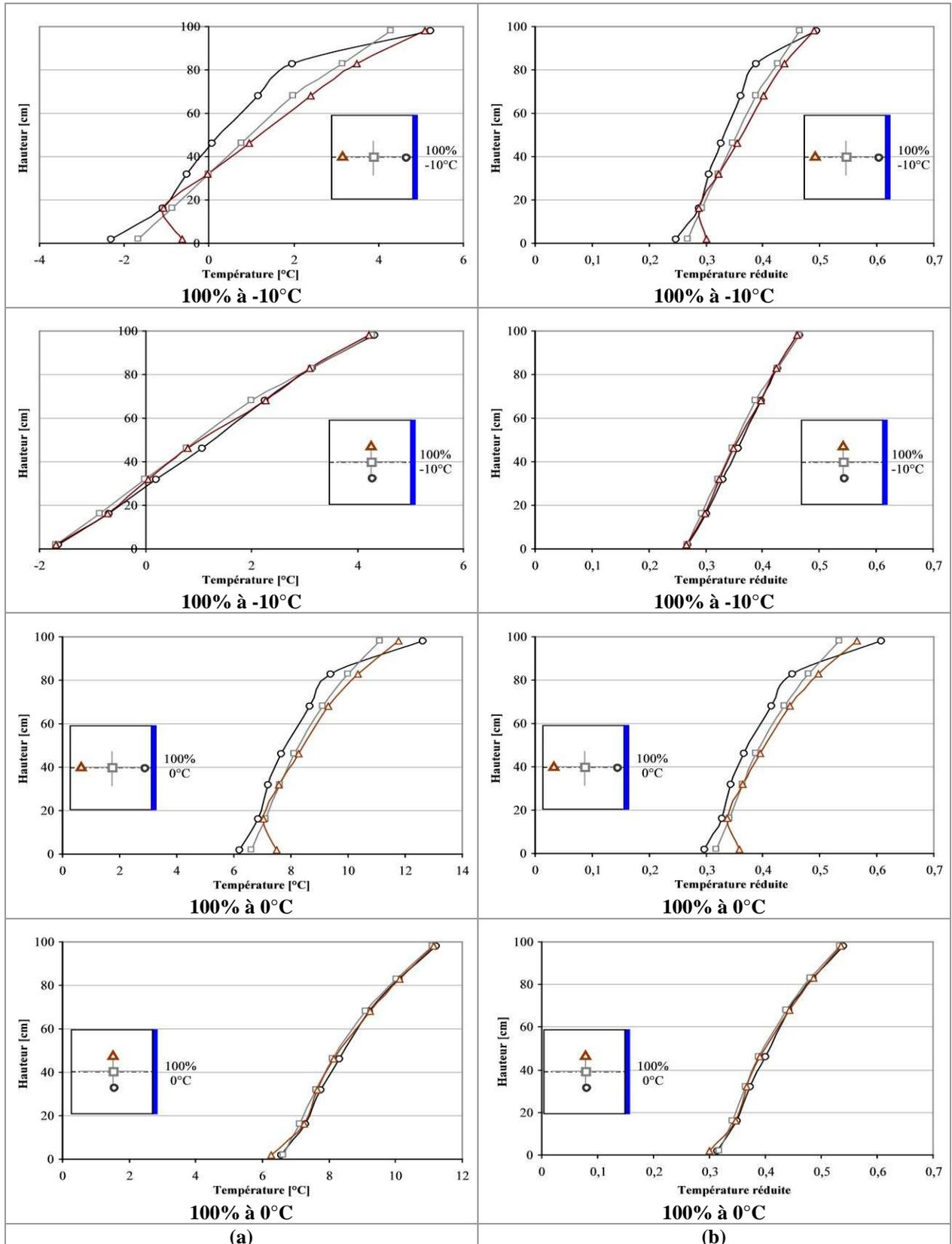
Figure A-49 : Comparaison des profils verticaux de température pour différentes positions par rapport au plan de symétrie de la maquette vide- 100% de la paroi froide ; (a) Hauteur en fonction de la température; (b) Hauteur en fonction de la température réduite
