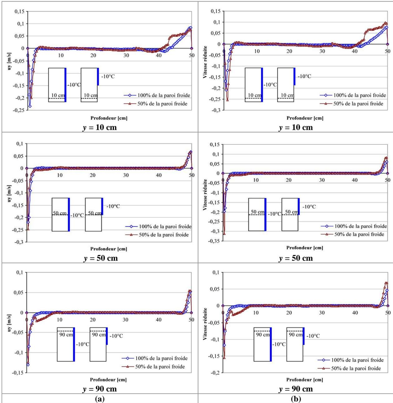
**Figure A-30 : Distribution de la couche limite hydrodynamique pour les deux surfaces de la paroi froide (100% et 50%)- Maquette vide -Paroi froide maintenue à  $-10^\circ\text{C}$ ; ; (a) vitesse en fonction de profondeur ; (b) vitesse réduite en fonction de profondeur**
