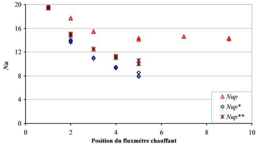
Figure IV-19 : Influence de l'établissement hydrodynamique et thermique simultanées sur le coefficient convectif entre la paroi et le lit fixe ( $u = 0.11 \text{ m s}^{-1}$ ,  $T_{paroi} - T_{air} = 15^\circ\text{C}$ )
