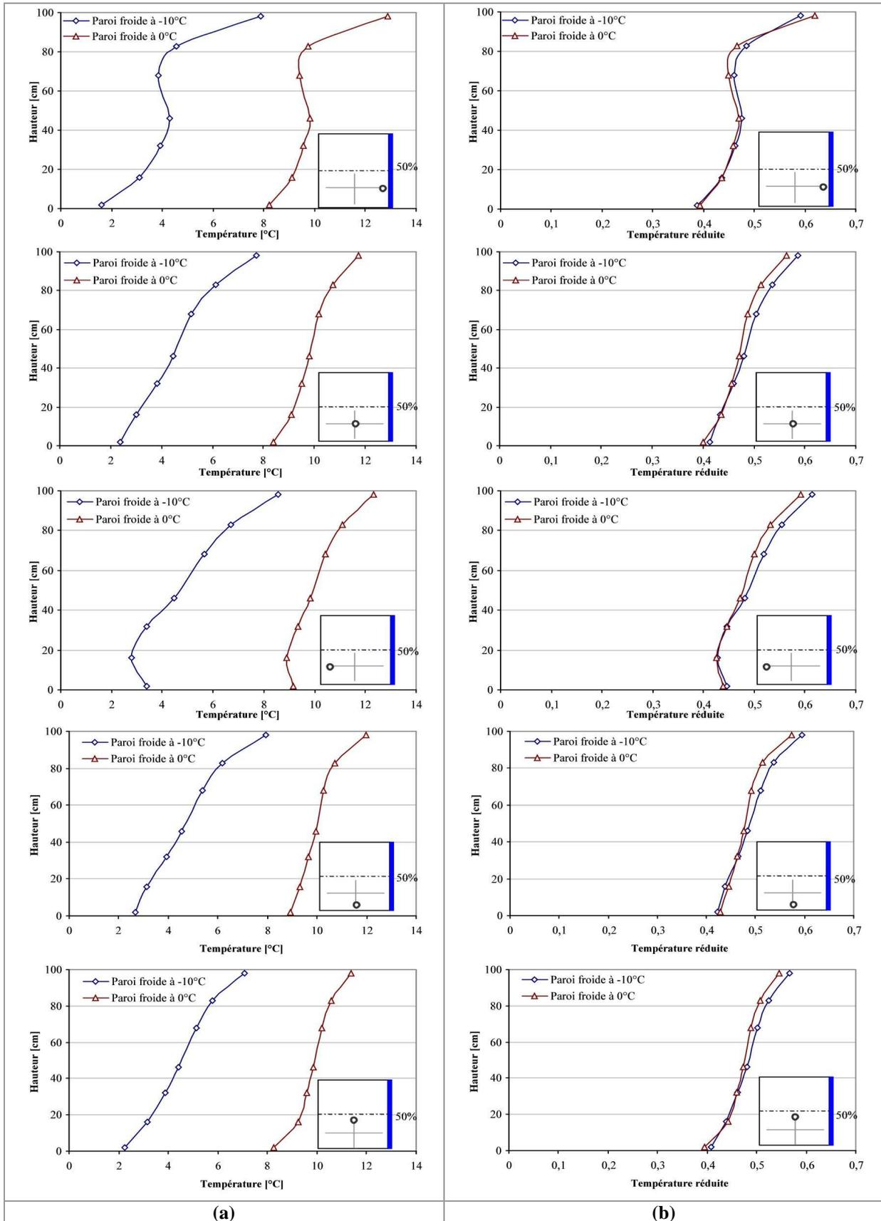
**Figure A-45 : Profils verticaux de température à différentes positions dans la maquette vide et pour deux températures de la paroi froide (-10°C et 0°C) - 50% de la paroi froide (a) Hauteur en fonction de la température; (b) Hauteur en fonction de la température réduite**
