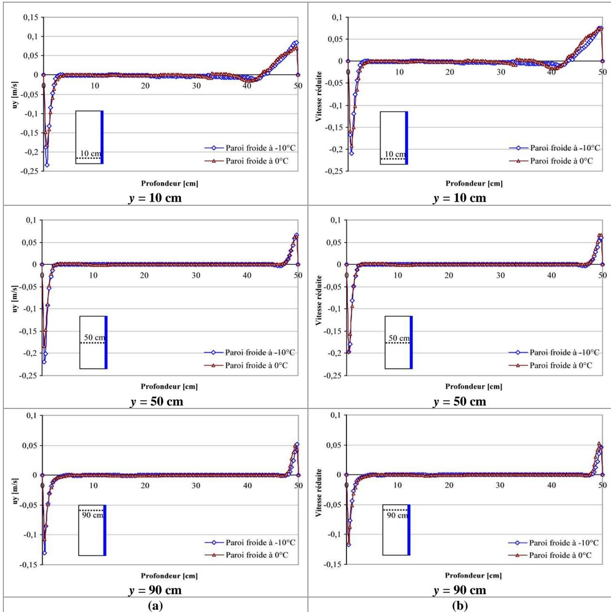
**Figure A-26 : Profil horizontal de la vitesse ( $u_y$ ) pour les deux températures de la paroi froide (-10°C et 0°C) - Totalité de la surface froide utilisée ; (a) Vitesse en fonction de la profondeur ; (b) Vitesse réduite en fonction de la profondeur**
