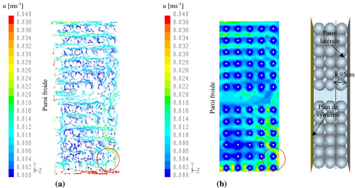
**Figure IV-48 : Vitesse sur le plan situé à 8.95 cm de la paroi latérale (100% à  $0^\circ\text{C}$ ) - Cas de la maquette remplie de sphères creuses ; (a) Lignes de courants ; (b) Norme de la vitesse**
