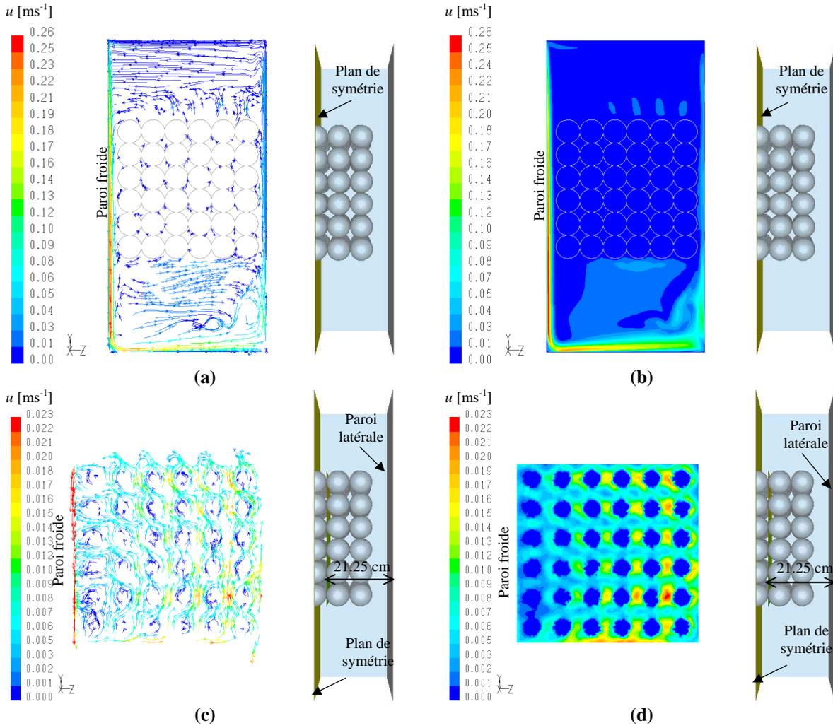
**Figure IV-59 : Maquette de réfrigérateur remplie avec des sphères en gel à l'équilibre (4200 min), (a) Lignes de courant sur le plan de symétrie ; (b) Norme de la vitesse sur le plan de symétrie ; (c) Lignes de courant au sein de l'empilement sur le plan situé à 21.25 cm de la paroi latérale ; (d) Norme de la vitesse au sein de l'empilement sur le plan situé à 21.25 cm de la paroi latérale**
