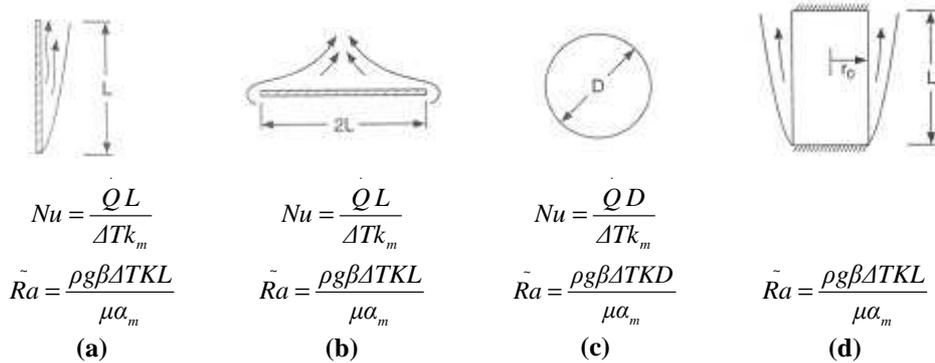
**Figure I-24 : Transfert de chaleur par convection naturelle externe dans un milieu poreux (a) Plaque verticale isotherme ; (b) Plaque horizontale isotherme chauffée sur la face supérieure ; (c) Cylindre horizontal isotherme ; (d) Cylindre vertical avec des extrémités adiabatiques**
