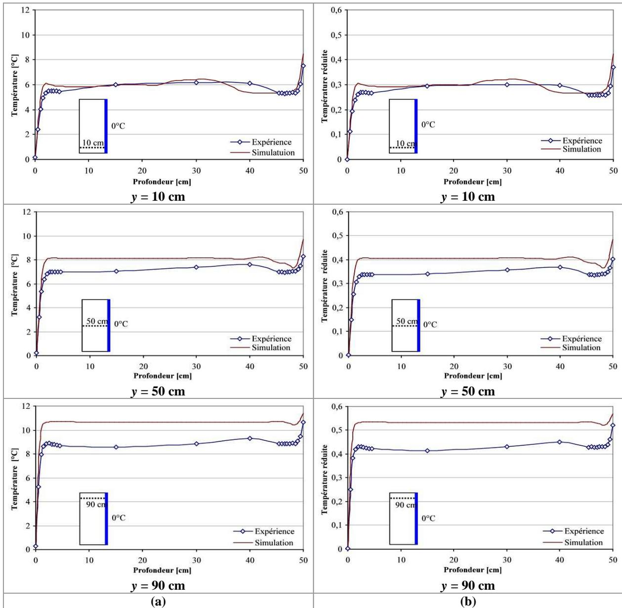
**Figure A-53 : Comparaison Expérience/ Simulation CFD de la distribution de la couche limite thermique entre la paroi froide et la paroi latérale en face -Totalité de la paroi froide maintenue à 0°C (a) Température en fonction de la profondeur ; (b) Température réduite en fonction de la profondeur**
