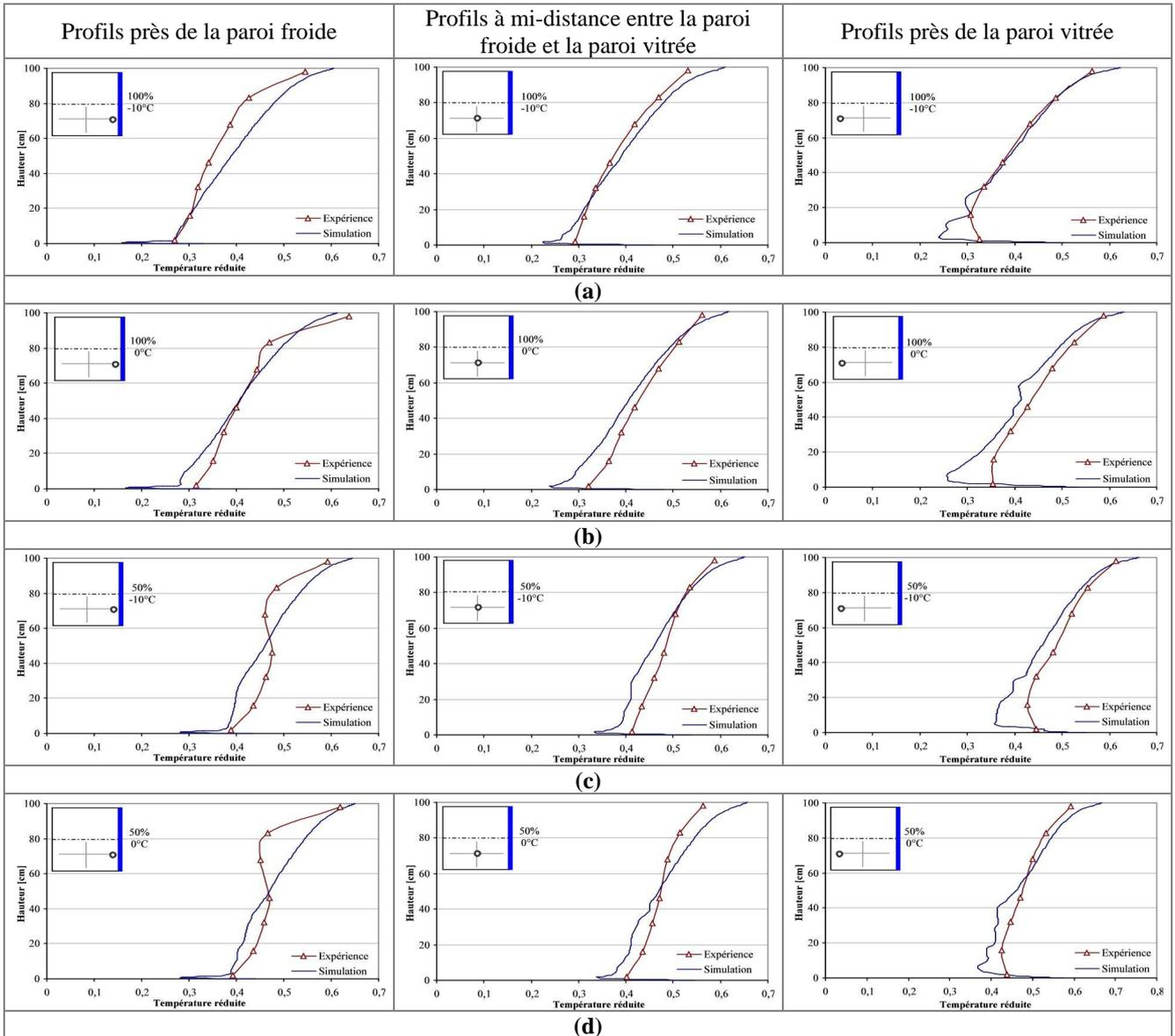
**Figure IV-39 : Comparaison entre les résultats expérimentaux et les simulations CFD des profils verticaux de température dans la maquette vide ; (a) 100% de la paroi froide maintenue à  $-10^{\circ}\text{C}$  ; (b) 100% de la paroi froide maintenue à  $0^{\circ}\text{C}$  ; (c) 50% de la paroi froide maintenue à  $-10^{\circ}\text{C}$  ; (d) 50% de la paroi froide maintenue à  $0^{\circ}\text{C}$**
