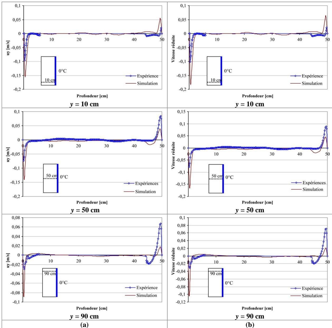
**Figure A-64 : Comparaison Expérience/ Simulation CFD de la distribution de la couche limite hydrodynamique sur différentes hauteurs-Maquette remplie de quatre blocs de sphères creuses – Totalité de la paroi froide maintenue à 0°C, (a) vitesse en fonction de profondeur ; (b) vitesse réduite en fonction de profondeur**
