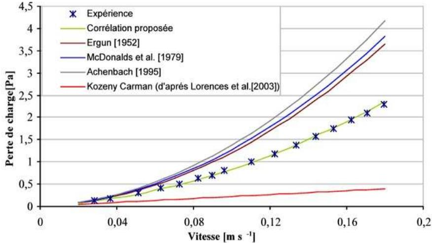
Figure IV-3 : Perte de charge dans l'empilement en fonction de la vitesse débitante pour différentes corrélations proposé par la littérature (H = 0.38 m)
