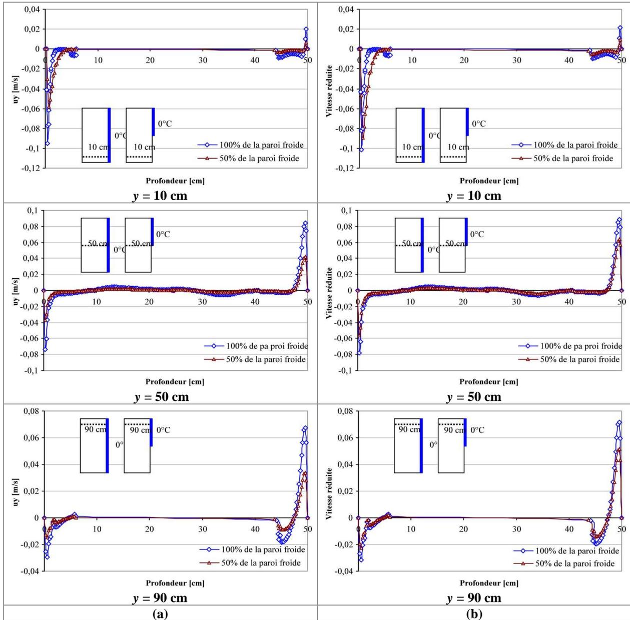
**Figure A-61 : Distribution de la couche limite hydrodynamique pour les deux surfaces de la paroi froide (100% et 50%) - Maquette remplie de sphères creuses - Paroi froide maintenue à  $0^\circ\text{C}$ ;**
