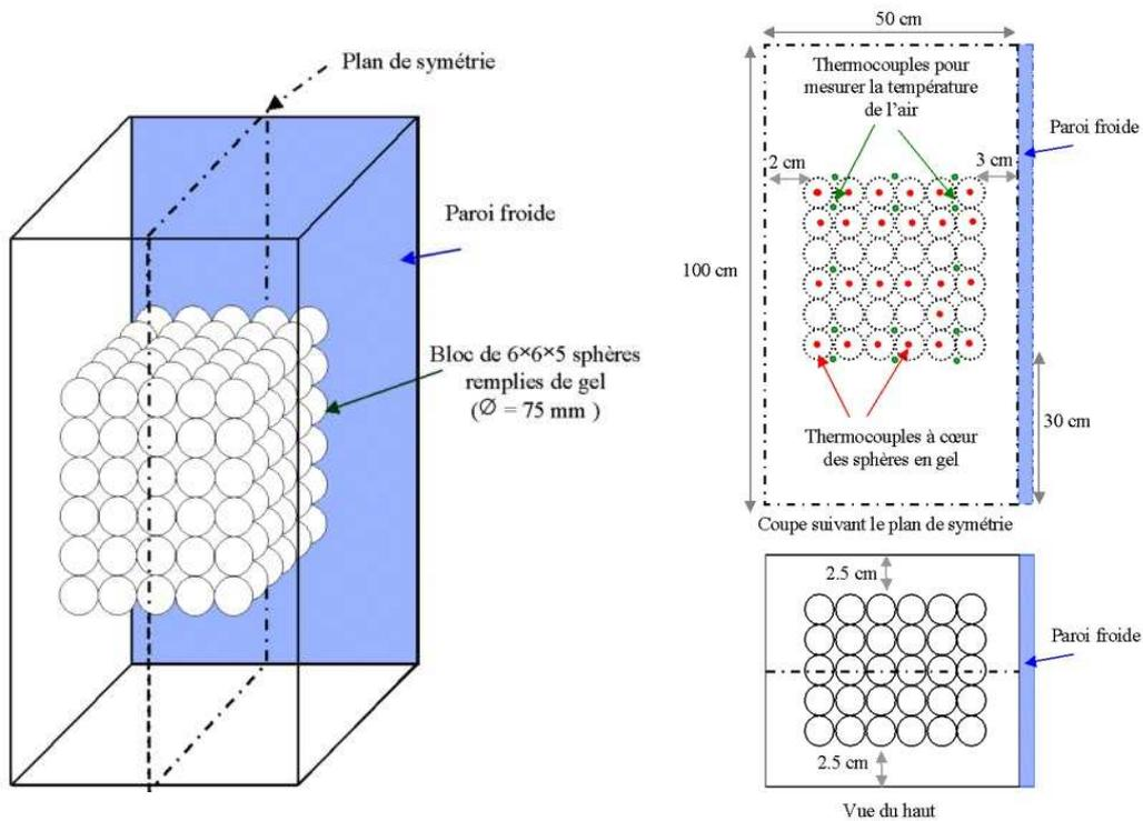
**Figure II-17 : Ecoulement autour d'un milieu partiellement rempli de sphères en gel (empilement de 6×6×5 sphères en gel)**
