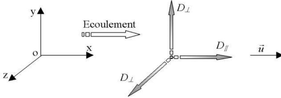
Figure I-17 : Schéma de la dispersion longitudinal  $D_{||}$  (selon (ox)) et la dispersion transversale  $D_{\perp}$  (selon (oy) et (oz))
