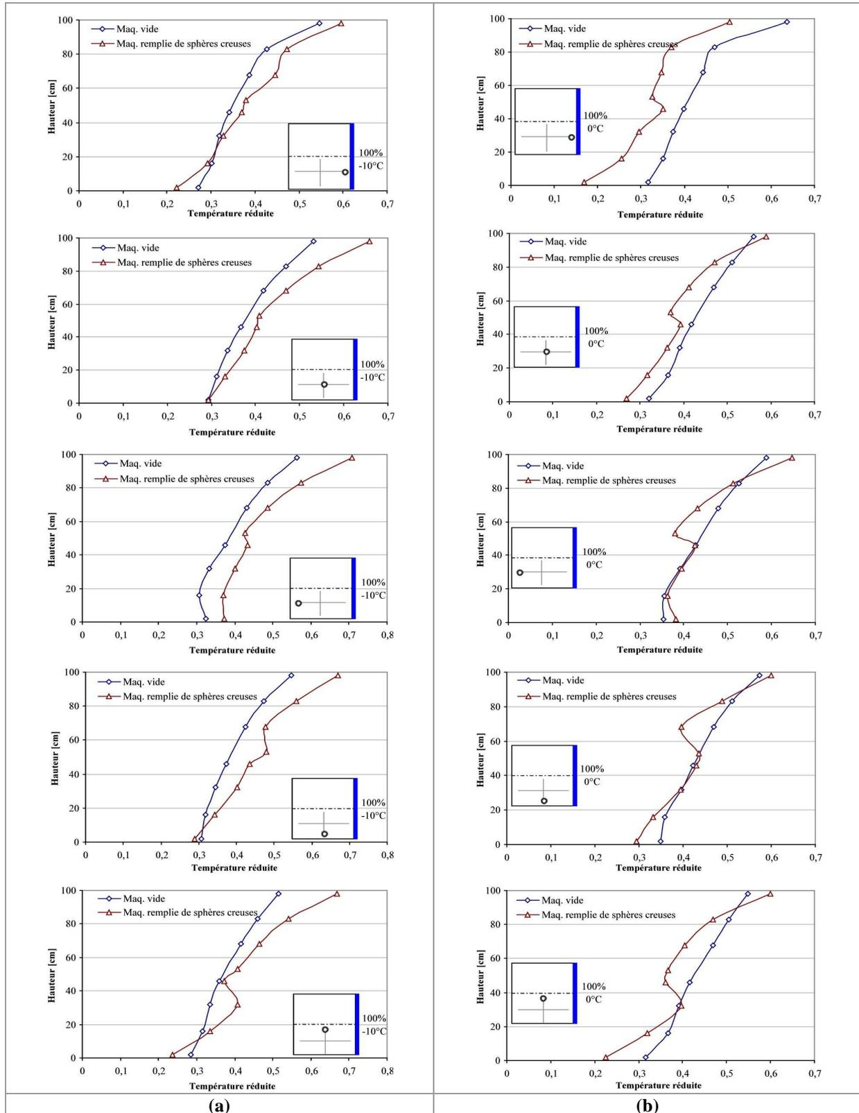
**Figure A-70 : Comparaison des profils verticaux de température entre le cas de la maquette vide et le cas de la maquette remplie avec quatre blocs de sphères creuses ;
