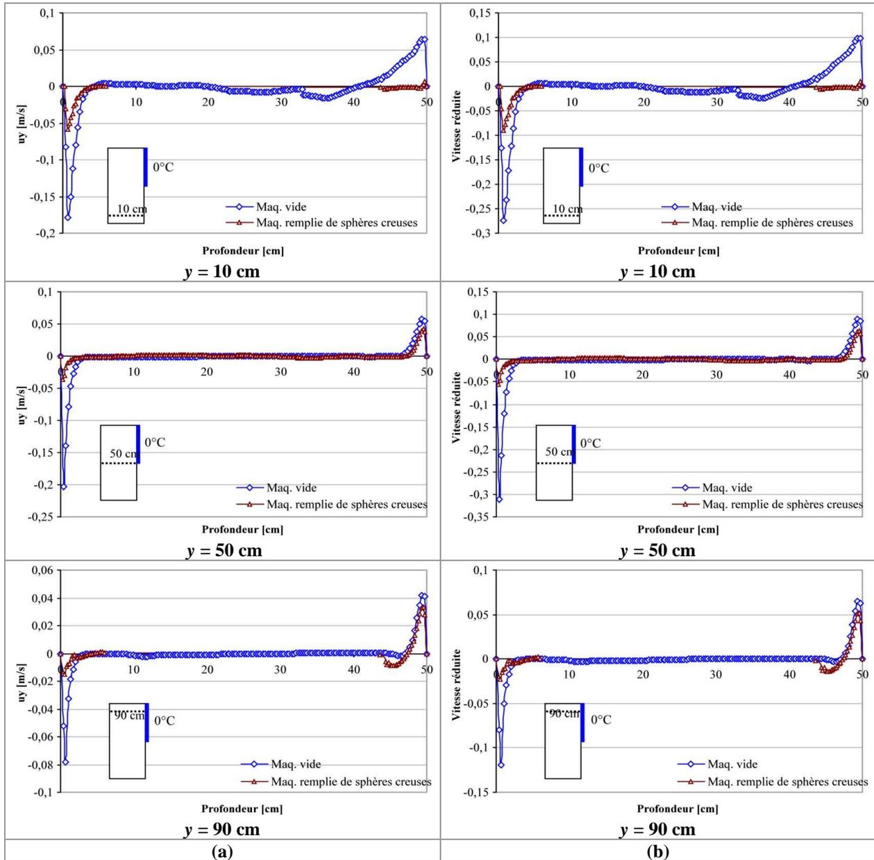
Figure A-63 : Comparaison des profils horizontaux de vitesse entre le cas de la maquette vide et le cas de la maquette remplie avec quatre blocs de sphères creuses (50% à  $0^\circ\text{C}$ ), (a) vitesse en fonction de profondeur ; (b) vitesse réduite en fonction de profondeur
