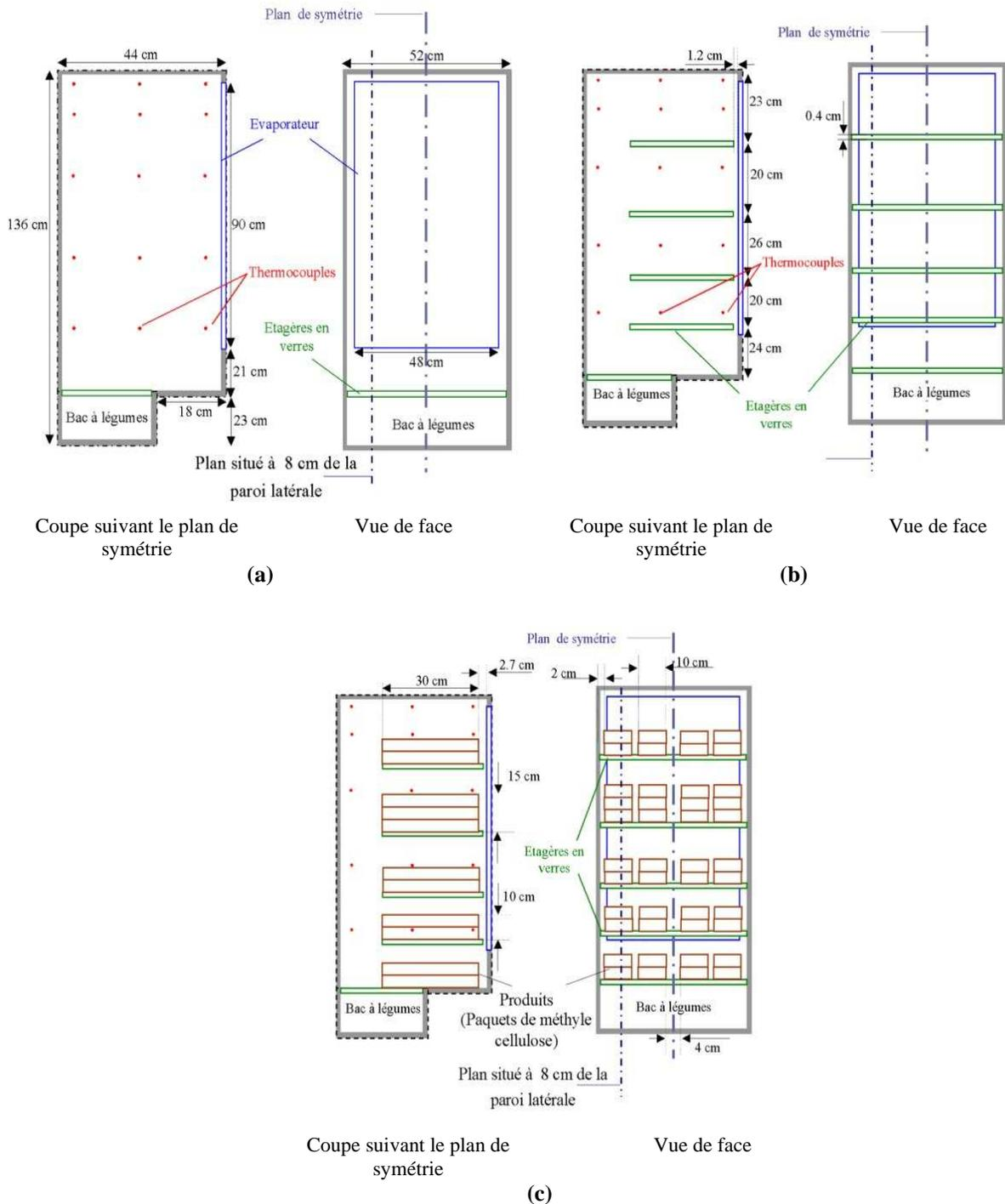
Les différentes expériences ont été réalisées dans une cellule à température contrôlée (maintenue à une température de  $20^{\circ}\text{C}\pm 0.2^{\circ}\text{C}$ ). Comme le montre la figure II-24, l'évaporateur occupe environ 80% de la totalité de la paroi arrière du réfrigérateur. L'espace situé en bas à l'arrière (derrière le bac à légumes) représente l'emplacement du compresseur.
