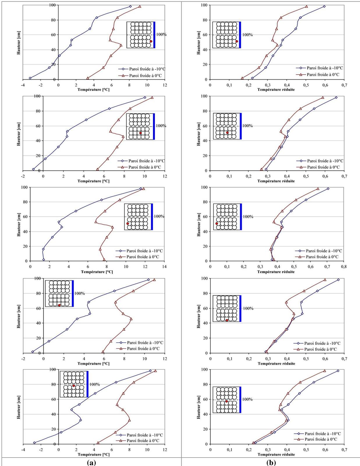
**Figure A-66 : Profils verticaux de température à différentes positions dans la maquette remplie avec quatre blocs de sphères creuses pour deux températures de la paroi froide (-10°C et 0°C) - 100% de la paroi froide (a) Hauteur en fonction de la température; (b) Hauteur en fonction de la température réduite**
