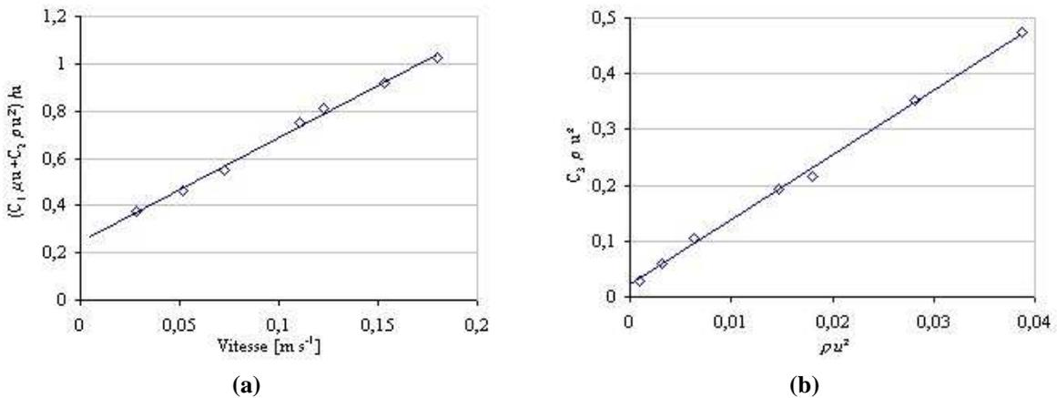
**Figure IV-2 : Détermination des coefficients relatifs à la perte de charge dans l'empilement**
