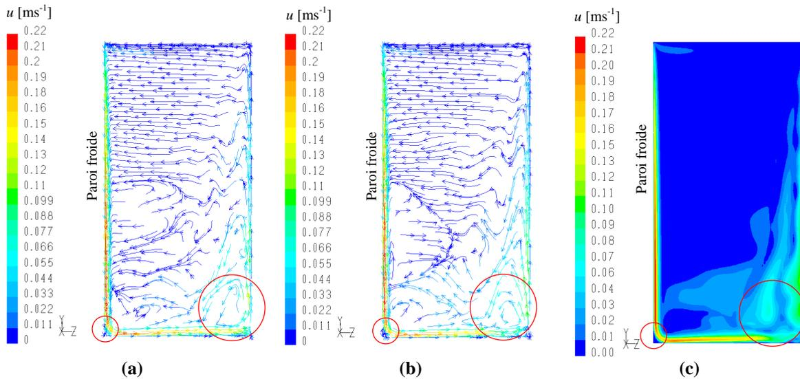
Figure IV-28 : Résultats de simulations Fluent - Plan de symétrie de la maquette vide (100% à 0°C), (a) Lignes de courant colorées par la norme de la vitesse à 70 min<sup>⊗</sup>; (b) Lignes de courant colorées par la norme de la vitesse à 130min; (c) Norme de la vitesse à 130 min
