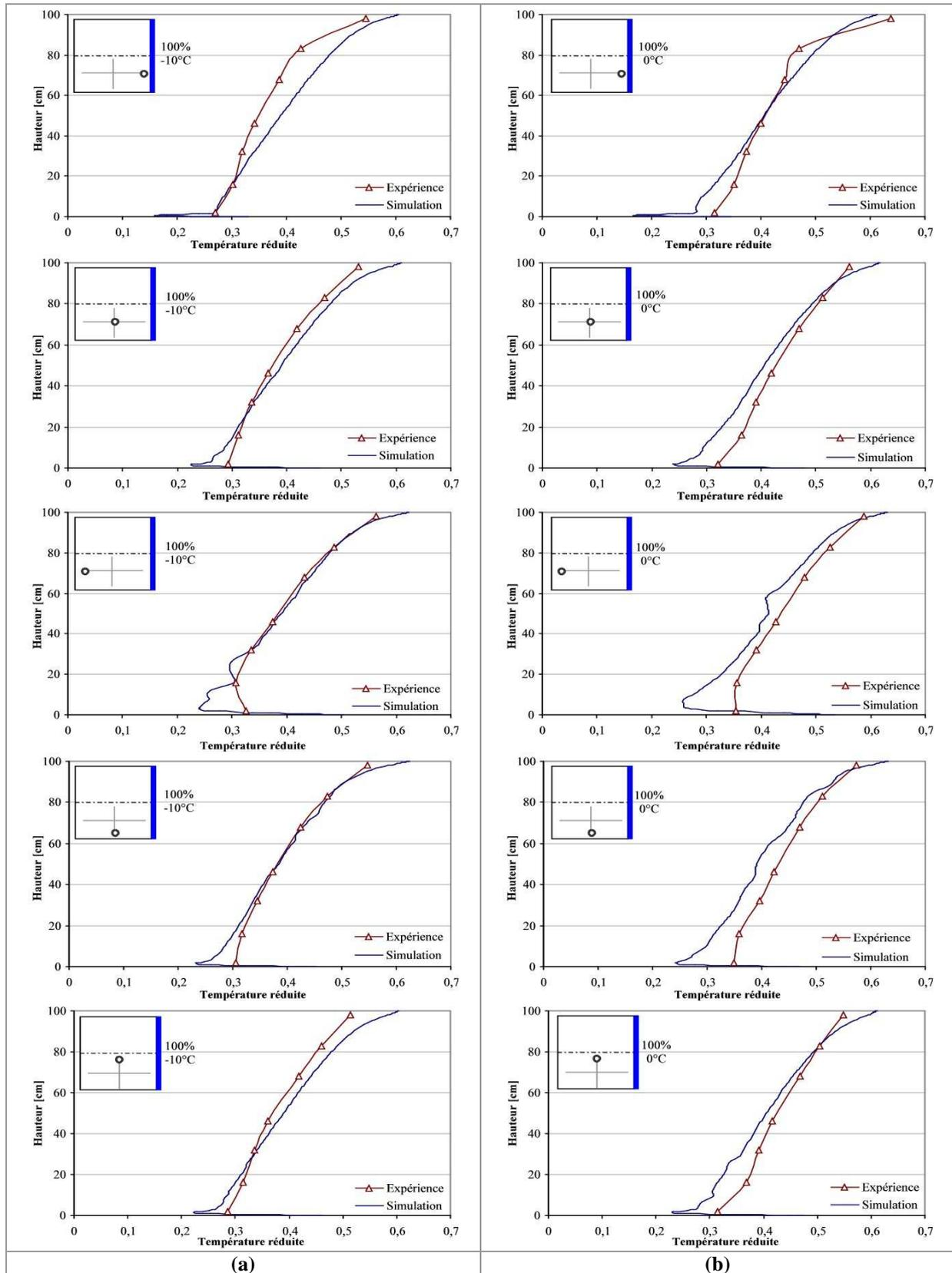
Figure A-51 : Comparaison Expérience/ Simulation CFD des profils verticaux de température pour différentes positions de la maquette vide (a) 100% à  $-10^{\circ}\text{C}$ ; (b) 100% à  $0^{\circ}\text{C}$
