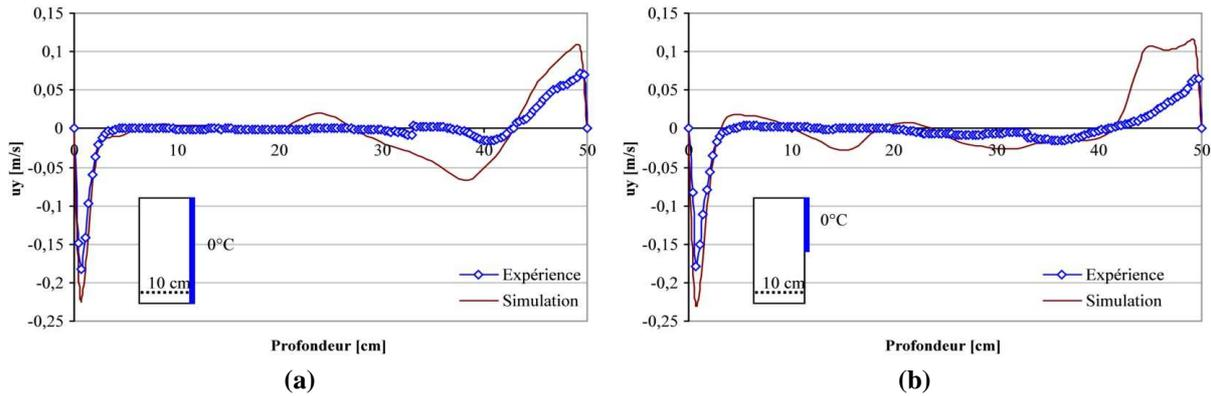
**Figure IV-30: Comparaison Expérience/ Simulation des profils de vitesse pour  $y = 10$  cm ; (a) Totalité de la paroi froide maintenue à  $0^{\circ}\text{C}$ ; (b) Moitié supérieure de la paroi froide maintenue à  $0^{\circ}\text{C}$**
