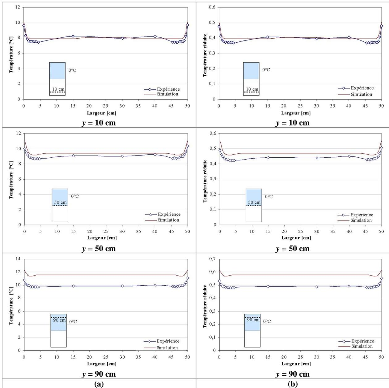
**Figure A-56 : Comparaison Expérience/ Simulation CFD de la distribution de la couche limite thermique entre les deux parois latérales sur le plan médian-Totalité de la paroi froide maintenue à 0°C (a)Température en fonction de la profondeur ; (b) Température réduite en fonction de la profondeur**
