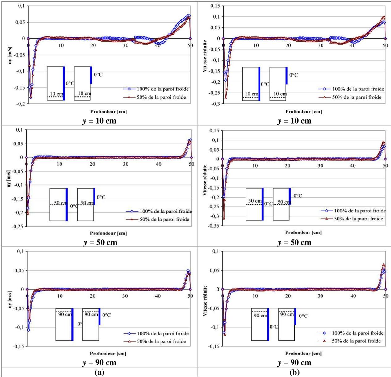
**Figure A-32 : Distribution de la couche limite hydrodynamique pour les deux surfaces de la paroi froide (100% et 50%) - Maquette vide - Paroi froide maintenue à  $0^\circ\text{C}$ ; ; (a) vitesse en fonction de profondeur ; (b) vitesse réduite en fonction de profondeur**
