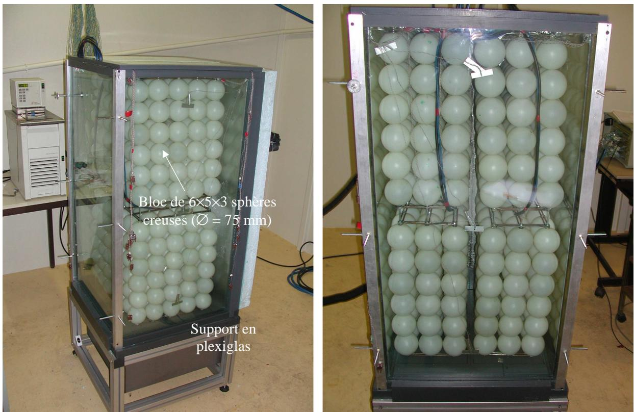
**Figure A-15 : Dispositif expérimental pour la mesure de la température d'air dans la maquette remplie avec quatre blocs de 6x5x3 de sphères creuses**
