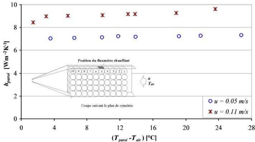
**Figure IV-13 : Influence de l'écart de température entre la paroi et l'air ( $T_{paroi} - T_{air}$ ) sur le coefficient de transfert convectif (Fluxmètre chauffant sur la 5<sup>ème</sup> rangée).**
