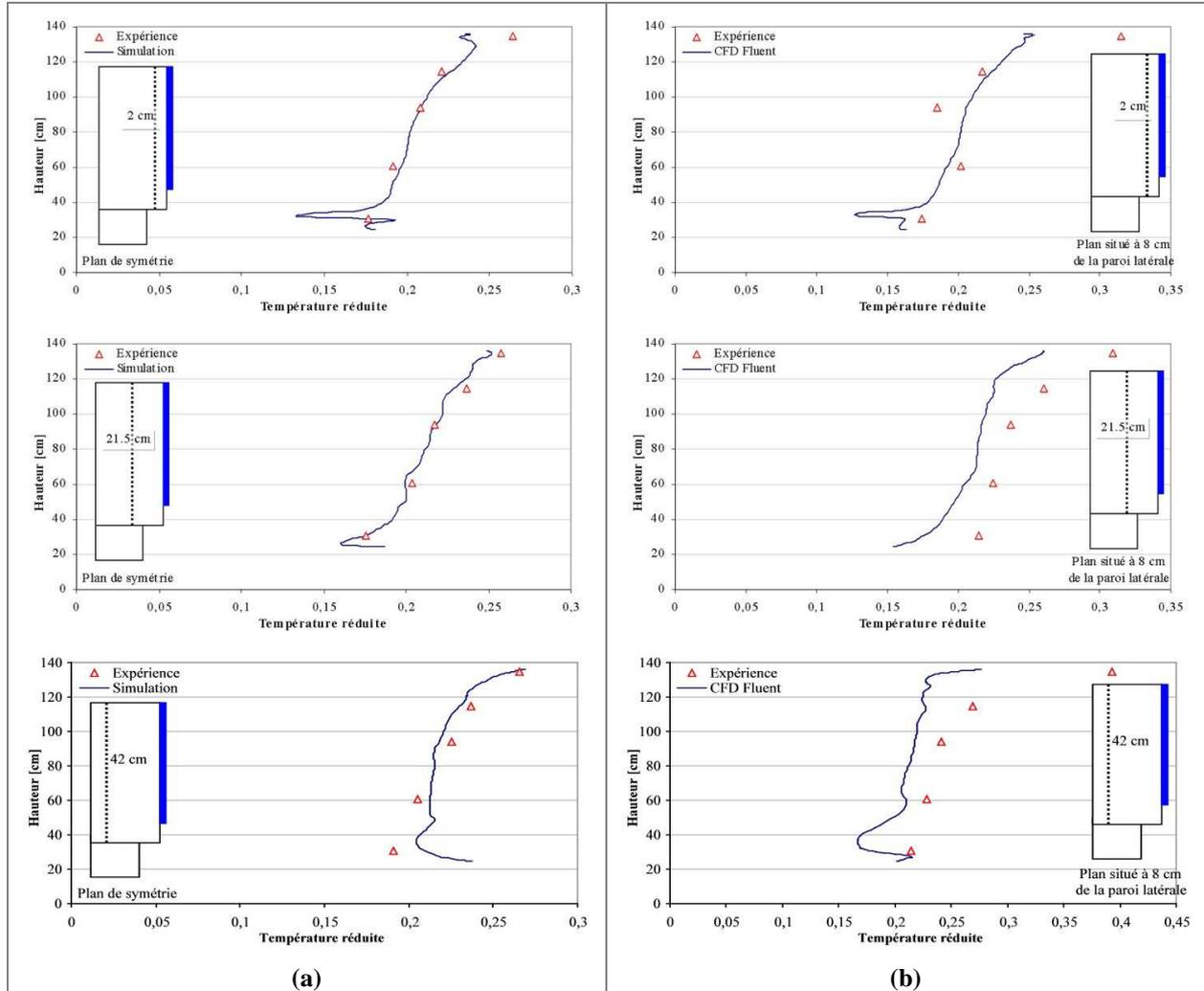
**Figure IV-42 : Comparaison entre les résultats expérimentaux et les simulations CFD des profils verticaux de température dans le cas du réfrigérateur ménager vide (sans étagères) ; (a) Sur le plan de symétrie ( $x = 26$  cm) ; (b) Sur le plan situé à  $x = 8$  cm de la paroi latérale**
