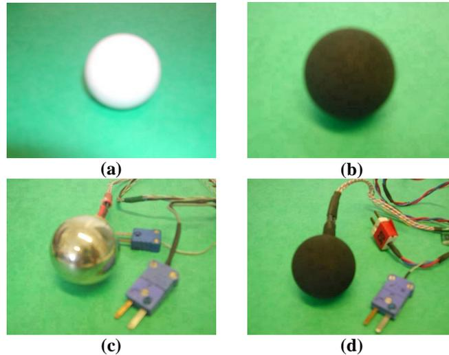
Figure II-4 : Photos des différentes sphères utilisées ( $\varnothing = 38 \text{ mm}$ ) ; (a) Sphère creuse en celluloïd blanc ; (b) Sphère creuse en celluloïd peinte en noir mat ; (c) Sphère en laiton chromée ; (d) Sphère en laiton peinte en noir mat
