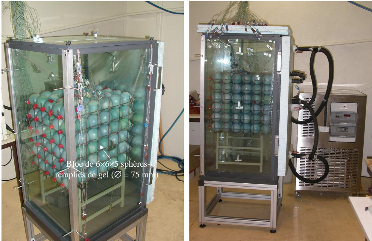
**Figure A-16 : Dispositif expérimental pour la mesure de la température d'air et à cœur des produits - Maquette partiellement remplie de sphères en gel (empilement de 6x6x5 sphères en gel)**
