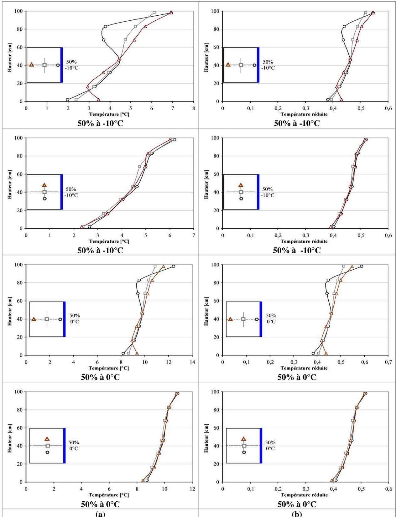
Figure A-50 : Comparaison des profils verticaux de température pour différentes positions par rapport au plan de symétrie de la maquette vide- 50% de la paroi froide (a) Hauteur en fonction de la température; (b) Hauteur en fonction de la température réduite
