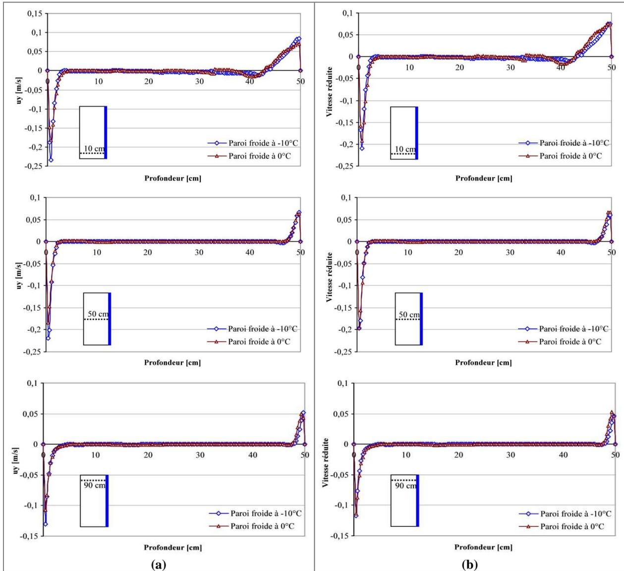
Figure IV-24 : Profil horizontal de la vitesse ( $u_y$ ) pour les deux températures de la paroi froide (-10°C et 0°C) - Totalité de la surface froide utilisée ; (a) Vitesse en fonction de la profondeur de la maquette ; (b) Vitesse réduite en fonction de la profondeur de la maquette
