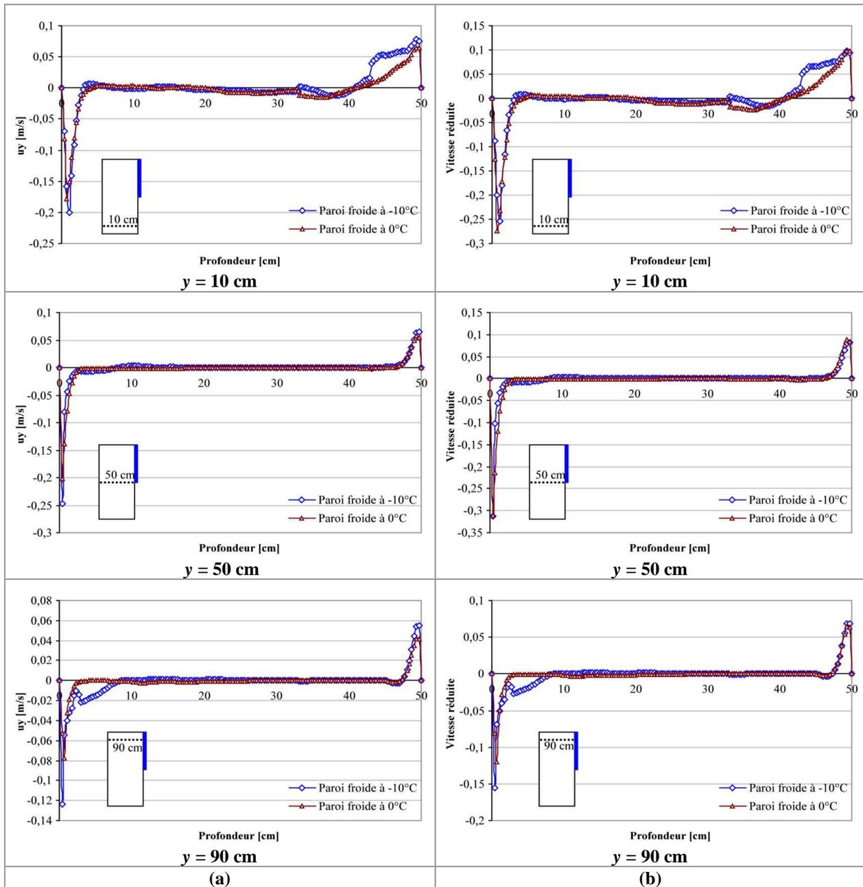
Figure A-28 : Distribution de la couche limite hydrodynamique pour les deux températures de la paroi froide ( $-10^{\circ}\text{C}$  et  $0^{\circ}\text{C}$ ) -Maquette vide -Moitié supérieure de la surface froide utilisée ;
