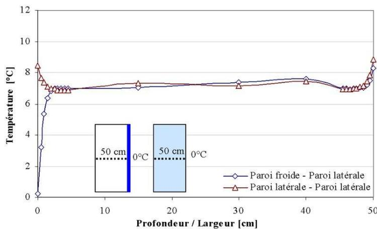
Figure IV-32 : Comparaison des profils de température horizontaux à mi-hauteur ( $y = 50$  cm) entre la paroi froide et la paroi vitrée située en face et entre les deux parois latérales vitrées (Totalité de la paroi froide maintenue à 0°C)
