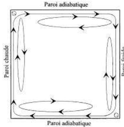
Figure I-14 : Ecoulement dans une cavité fermée (Tian et Karayiannis (2000))
