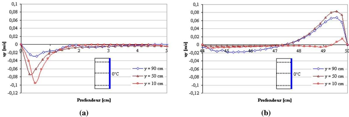
Figure IV-44 : Profil horizontal de la vitesse ( $u_y$ ) à trois hauteurs sur le plan de symétrie – Totalité de la paroi froide maintenue à 0°C, (a) Couche limite côté paroi froide ; (b) Couche limite côté paroi latérale vitrée
