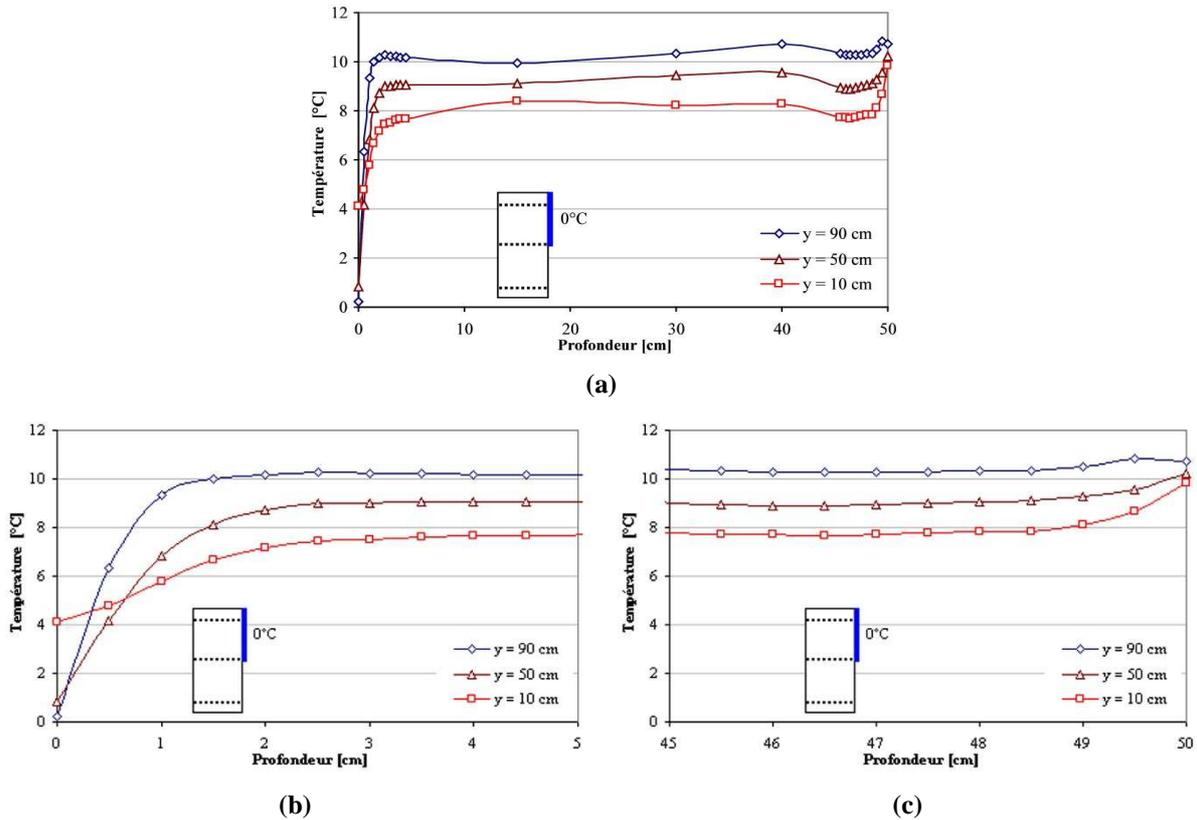
**Figure IV-33 : Profil horizontal de température sur trois hauteurs sur le plan de symétrie – Moitié supérieure de la paroi froide maintenue à 0°C (a) Vue globale ; (b) Couche limite côté paroi froide ; (c) Couche limite côté paroi vitrée**
