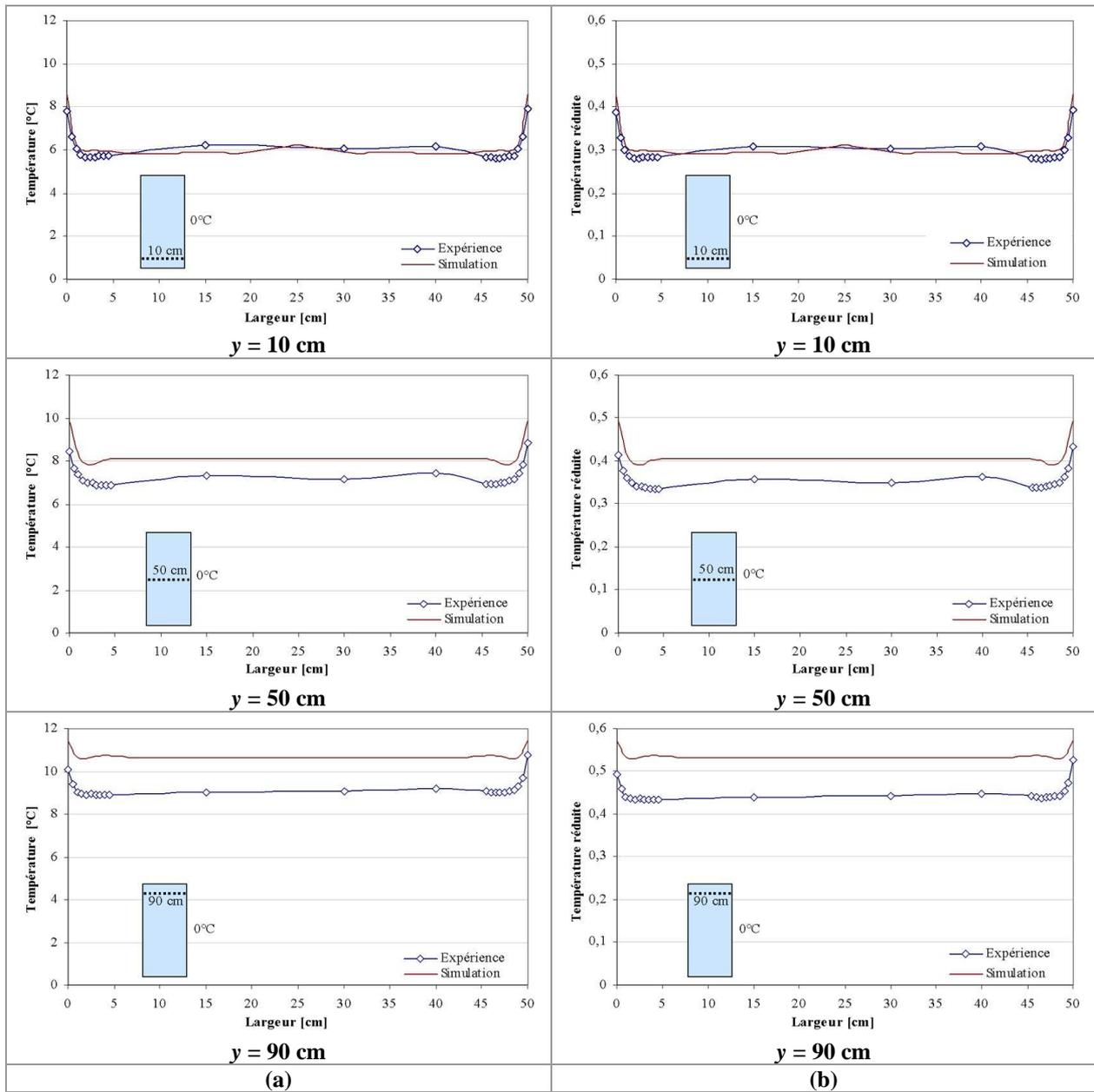
**Figure A-55 : Comparaison Expérience/ Simulation CFD de la distribution de la couche limite thermique entre les deux parois latérales sur le plan médian-Totalité de la paroi froide maintenue à 0°C ;(a)Température en fonction de la profondeur ; (b) Température réduite en fonction de la profondeur**
