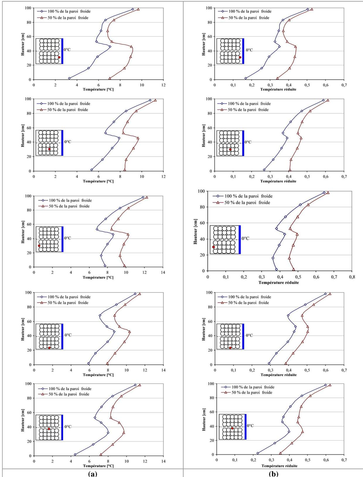
**Figure A-69 : Profils verticaux de température à différentes positions dans la maquette vide et pour les deux surfaces de la paroi froide (100% et 50%) - Paroi froide maintenue à 0°C ; (a) Hauteur en fonction de la température; (b) Hauteur en fonction de la température réduite**
