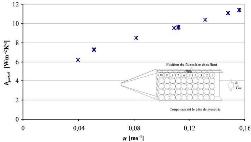
**Figure IV-14 : Influence de la vitesse d'air sur le coefficient de transfert convectif (Fluxmètre chauffant sur la 5<sup>ème</sup> rangée,  $T_{\text{paroi}} - T_{\text{air}} = 15^\circ\text{C}$ ).**
