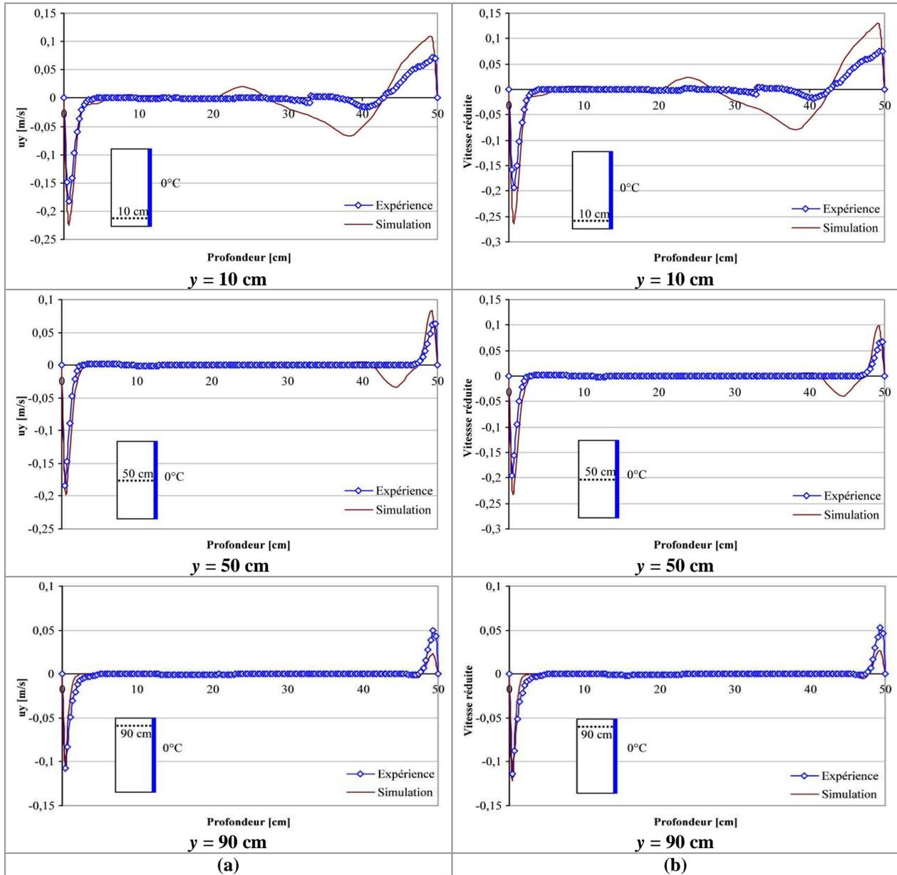
**Figure A-35 : Comparaison Expérience/ Simulation CFD de la distribution de la couche limite hydrodynamique sur différentes hauteurs-Maquette vide -Totalité de la paroi froide maintenue à 0°C, (a) vitesse en fonction de profondeur ; (b) vitesse réduite en fonction de profondeur**
