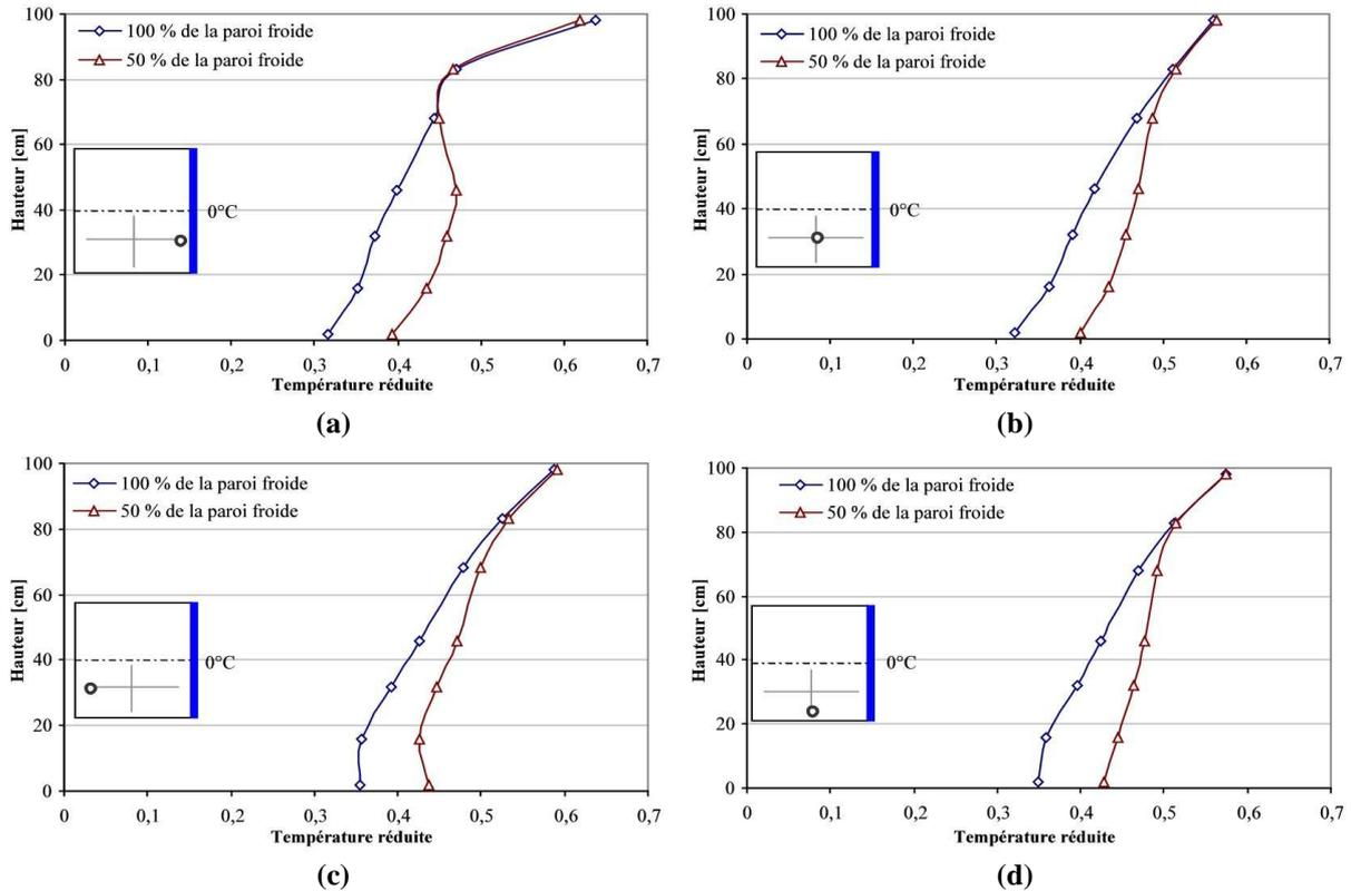
**Figure IV-37 : Profils verticaux de température dans la maquette vide – 100% ou 50% de la paroi froide maintenue à 0°C (a) Près de la paroi froide ; (b) A mi-distance entre la paroi froide et la paroi vitrée; (c) Près de la paroi vitrée (en face de la paroi froide) ; (d) Près de la paroi vitrée latérale**
