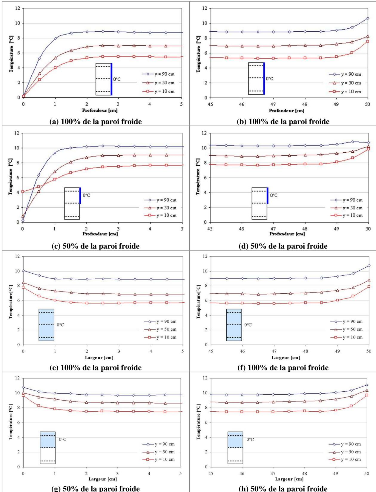
Figure A-40 : (a) Couche limite côté paroi froide (100%) ; (b) Couche limite côté paroi en face de la paroi face froide (100%) ; (c) Couche limite côté paroi froide (50%) ; (d) Couche limite côté paroi en face de la paroi face froide (50%) ; (e) et (f) Couche limite côté paroi latérale sur le plan médian (100%) ; (g) et (h) Couche limite côté paroi latérale sur le plan médian (50%)
