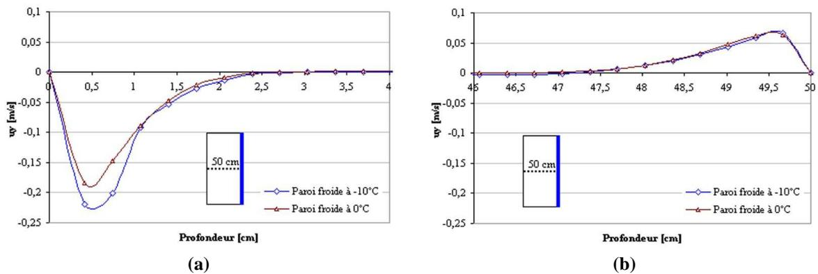
Figure IV-25 : Profil horizontal de la vitesse ( $u_y$ ) sur le plan de symétrie de la maquette vide ( $y = 50$  cm) - Deux températures de la paroi froide (-10°C et 0°C) - Totalité de la surface froide utilisée (a) Couche limite côté paroi froide; (b) Couche limite côté paroi vitrée
