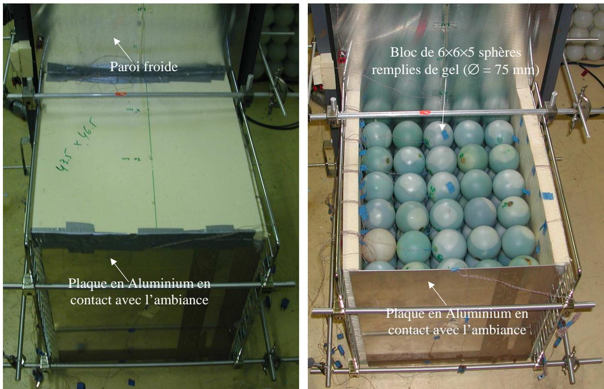
**Figure A-17 : Dispositif expérimental pour la mesure de la température d'air et à cœur des produits - Encinte parallélépipédique complètement remplie de sphères en gel (empilement de 6x6x5 sphères en gel)**
