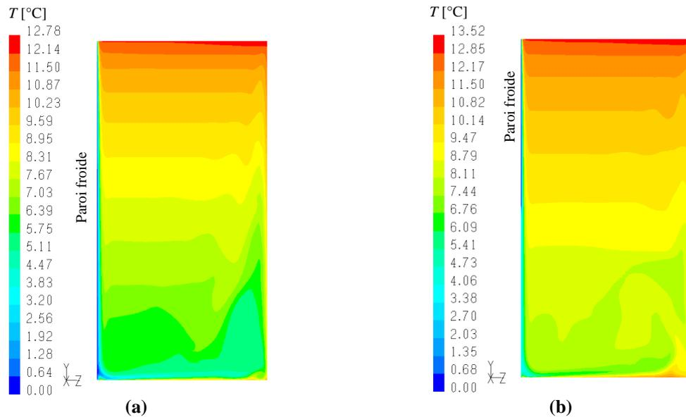
**Figure IV-38 : Température d'air sur le plan de symétrie de la maquette vide obtenu par simulations CFD (a) Totalité de la paroi froide maintenue à 0°C ; (b) Moitié supérieure de la paroi froide maintenue à 0°C**
