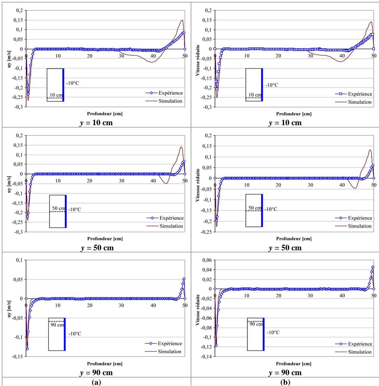
**Figure A-34 : Comparaison Expérience/ Simulation CFD de la distribution de la vitesse sur la couche limite hydrodynamique sur différentes hauteurs-Maquette vide -Totalité de la paroi froide maintenue à  $-10^{\circ}\text{C}$ , (a) vitesse en fonction de profondeur ; (b) vitesse réduite en fonction de profondeur**
