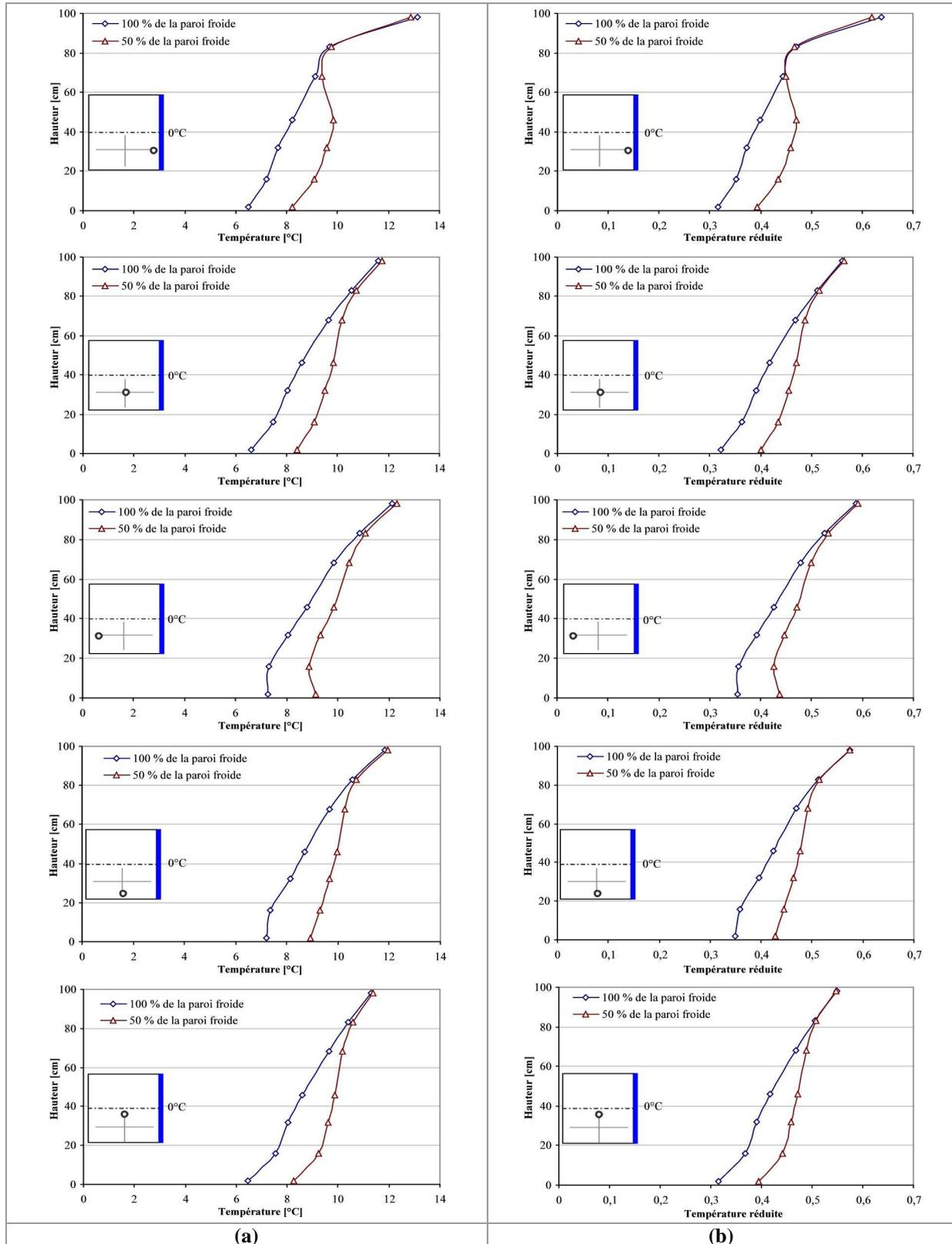
**Figure A-43 : Profils verticaux de température à différentes positions dans la maquette vide et pour les deux surfaces de la paroi froide (100% et 50%) - Paroi froide maintenue à 0°C (a) Hauteur en fonction de la température; (b) Hauteur en fonction de la température réduite**
