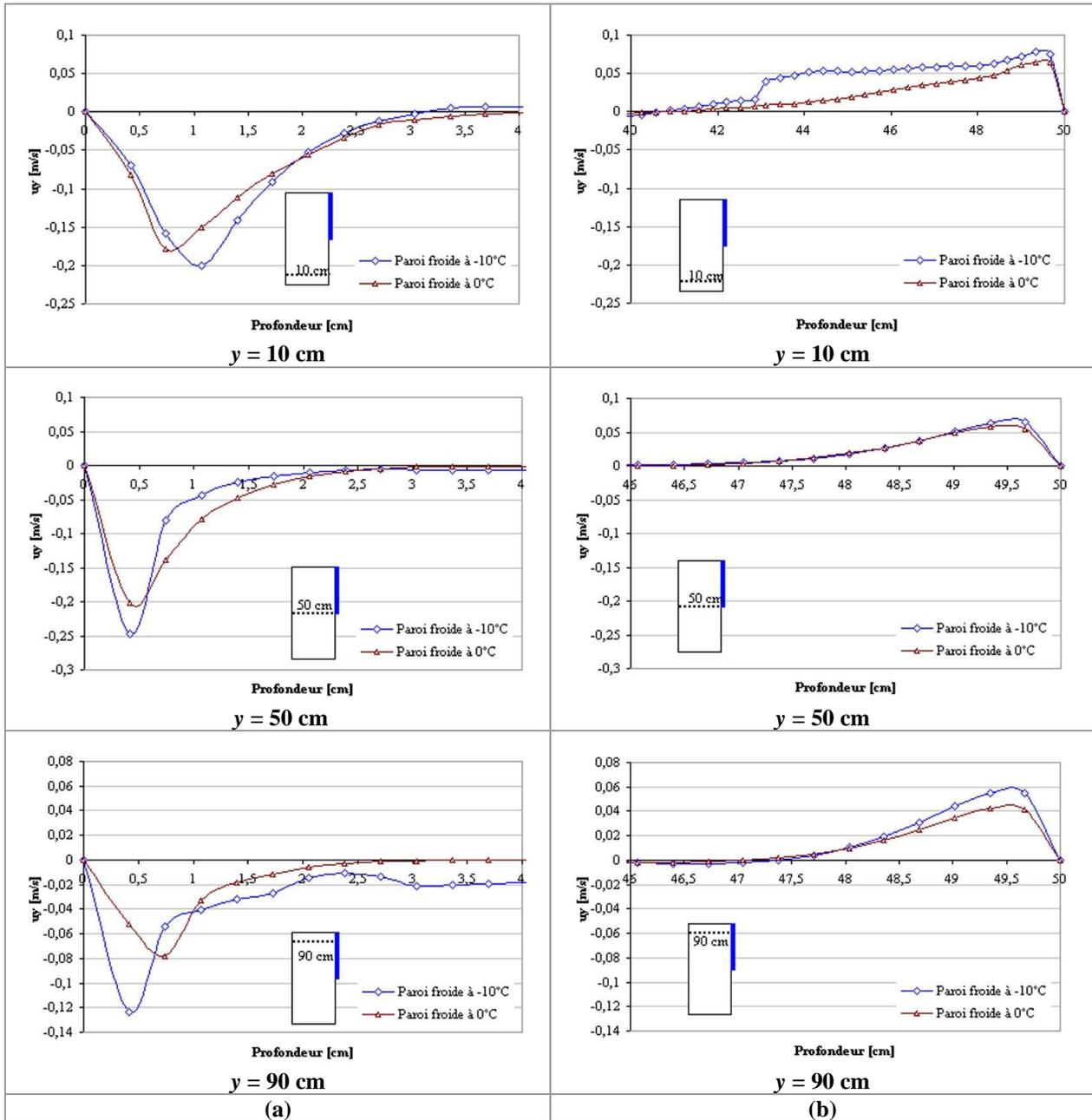
**Figure A-29 : Couche limite hydrodynamique à différentes hauteurs sur le plan de symétrie de la maquette vide- Deux températures de la paroi froide (-10°C et 0°C)- Moitié supérieure de la surface froide utilisée (a) Couche limite côté paroi froide; (b) Couche limite côté paroi vitrée**
