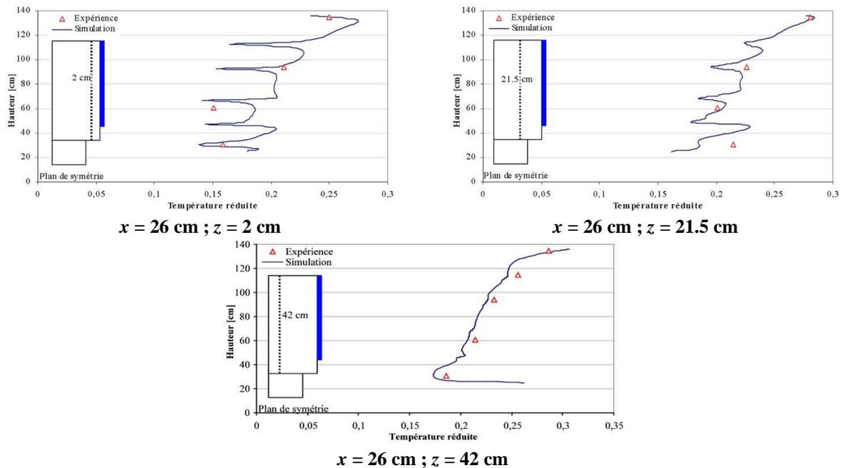
Figure IV-56 : Comparaison des résultats expérimentaux avec les résultats des simulations CFD des profils verticaux de température sur le plan de symétrie ( $x=26\text{cm}$ ) dans le cas du réfrigérateur ménager équipé avec des étagères en verre
