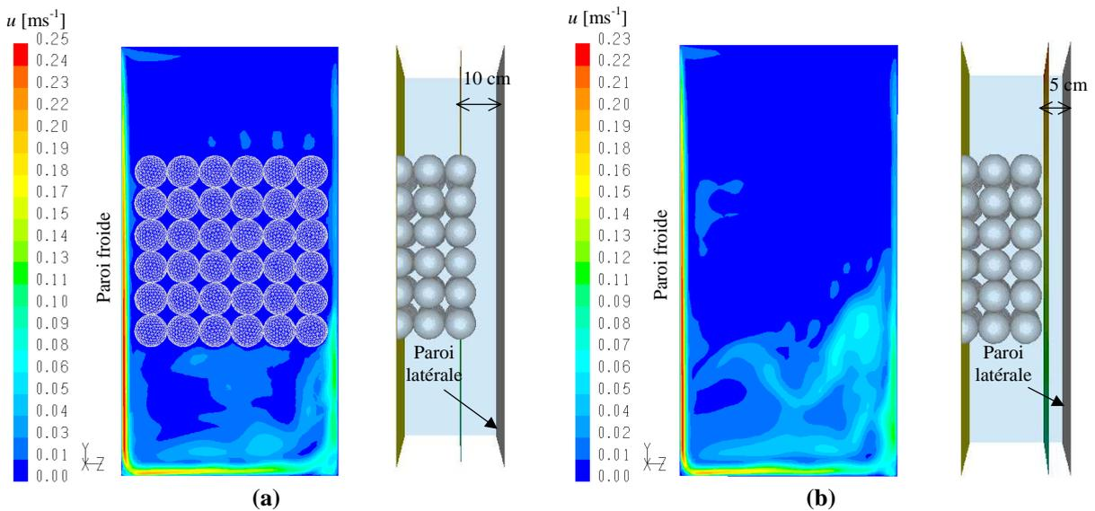
**Figure IV-60 : Norme de la vitesse à l'équilibre (4200 min) - Cas de la Maquette remplie avec des sphères en gel (a) Plan situé à 10 cm de la paroi latérale ; (b) Plan situé à 5 cm de la paroi latérale**
