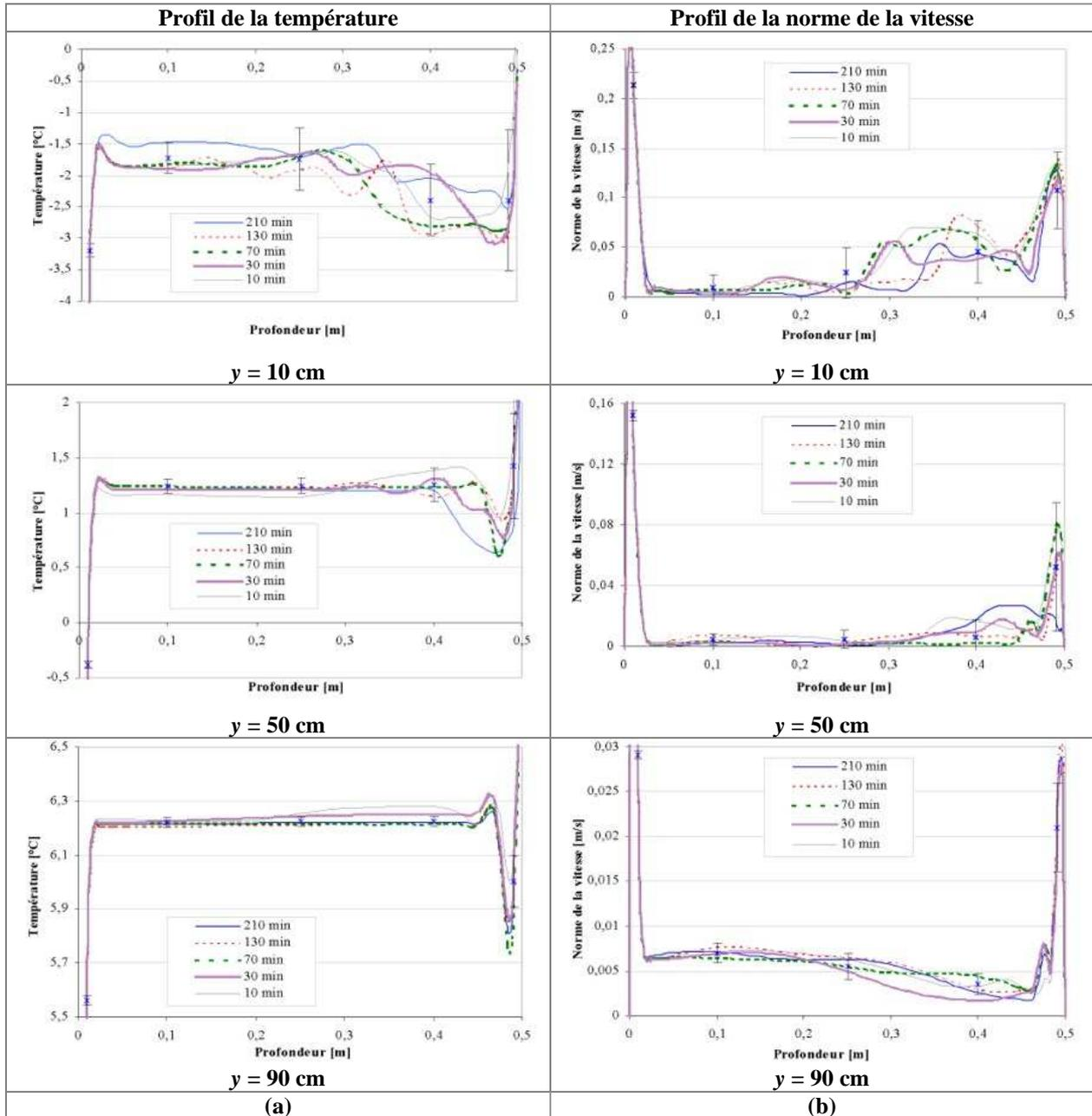
**Figure III-9 : Etude de la convergence ; (a) Profil de la température pour trois hauteurs différentes :  $y=10\text{cm}$ ,  $y=50\text{cm}$  et  $y=90\text{cm}$  ; (b) Profil de la norme de la vitesse pour trois hauteurs différentes :  $y=10\text{ cm}$ ,  $y=50\text{cm}$  et  $y=90\text{cm}$  ; (les croix et les barres représentent la moyenne  $\pm 2$  fois l'écart type aux points de contrôle pendant l'étape 5)**
