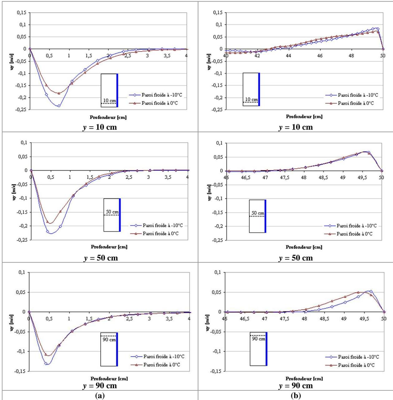
**Figure A-27 : Couche limite hydrodynamique à différentes hauteurs sur le plan de symétrie de la maquette vide- Deux températures de la paroi froide ( $-10^\circ\text{C}$  et  $0^\circ\text{C}$ ) - Totalité de la surface froide utilisée (a) Couche limite côté paroi froide; (b) Couche limite côté paroi vitrée**
