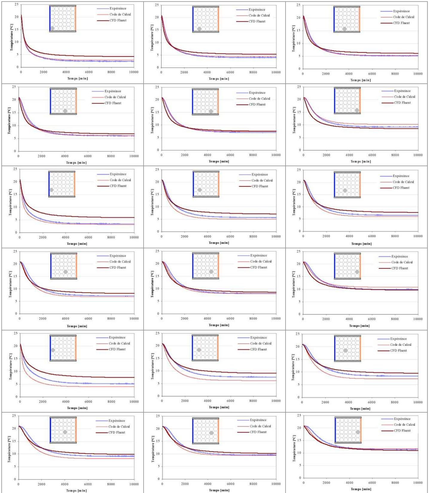
**Figure A-76 : Comparaison de température à cœur du produit entre l'expérience, le code 'macro-poreux' et les résultats de simulation CFD – Cas de l'enceinte parallélépipédique complètement remplie de sphères en gel**
