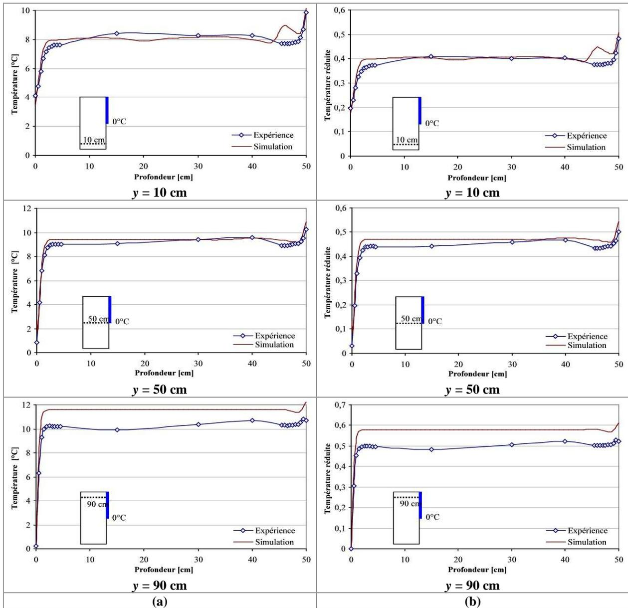
**Figure A-54 : Comparaison Expérience/ Simulation CFD de la distribution de la couche limite thermique entre la paroi froide et la paroi latérale en face -Moitié supérieure de la paroi froide maintenue à 0°C (a) Température en fonction de la profondeur ; (b) Température réduite en fonction de la profondeur**
