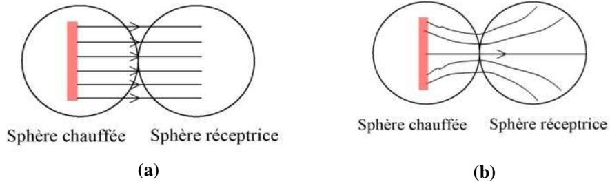
**Figure IV-5 : Conduction entre deux sphères : (a) Hypothèse de Schlunder (1966) : Lignes de courant unidirectionnelles et parallèles ; (b) Notre cas : Lignes de courant convergeant vers le point de contact entre les deux sphères.**
