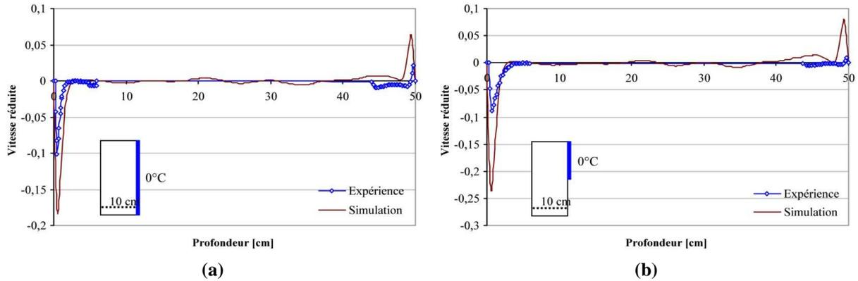
**Figure IV-49: Comparaison Expérience/ Simulations du profil de vitesse horizontale ( $y=10\text{cm}$ ), (a) 100% de la paroi froide maintenue à  $0^\circ\text{C}$ ; (b) 50% de la paroi froide maintenue à  $0^\circ\text{C}$**
