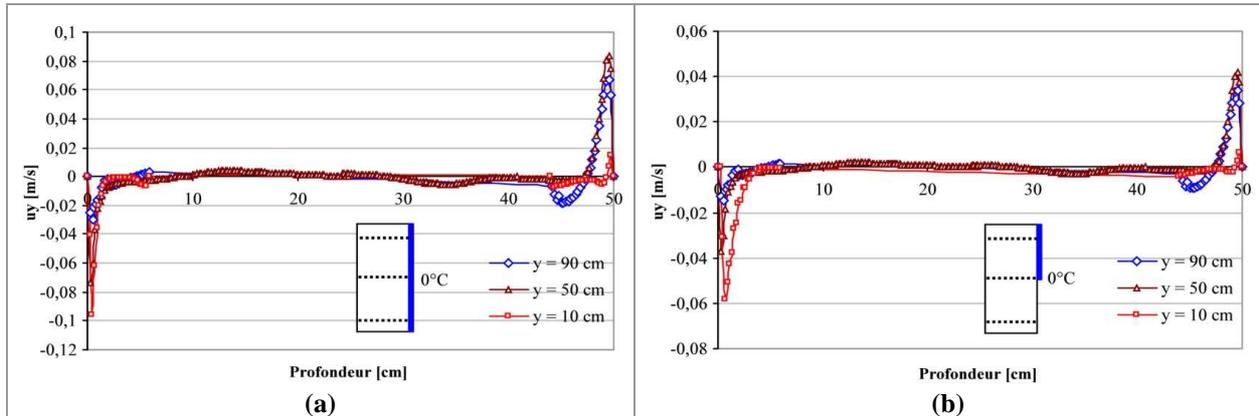
**Figure A-59 : Distribution de la couche limite hydrodynamique sur trois hauteurs sur le plan de symétrie - Maquette remplie de sphères creuses- Paroi froide maintenue à 0°C; (a) 100% de la paroi froide ; (b) 50% de la paroi froide**
