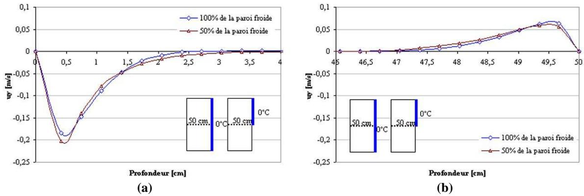
**Figure IV-27 : Profil horizontal de la vitesse ( $u_y$ ) sur le plan de symétrie de la maquette vide ( $y = 50$  cm) - Paroi froide à  $0^\circ\text{C}$ - Totalité et moitié supérieure de la paroi froide utilisée (a) Couche limite côté paroi froide; (b) Couche limite côté paroi vitrée**
