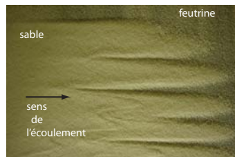
FIG. 5.45 – Doigts de ségrégation du sable se propageant directement sur la feutrine pour des hauteurs d'écoulement proche de h_{stop}(\theta) .
