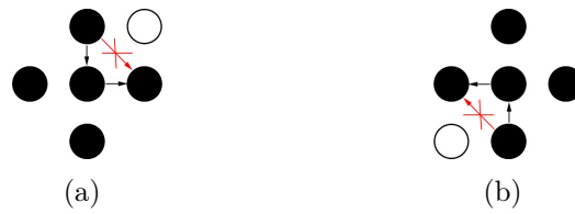
FIG. 8.21 – Algorithme d'initialisation de la composante fortement connexe : configurations permettant d'assurer le rattachement des sous-réseaux bidirectionnels internes à l'anneau périphérique
