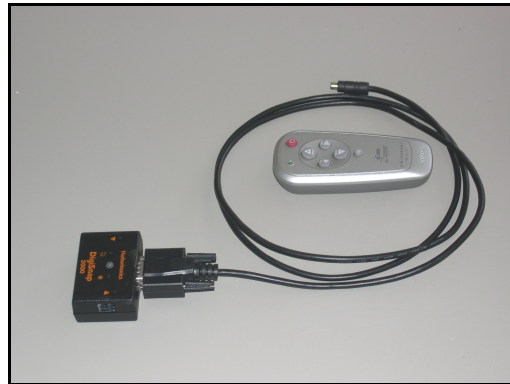
Figure 32 : Système permettant le déclenchement à distance de la prise de vue, à l'aide d'une télécommande infrarouge. Ce système, le Digisnaps 2000 (Harbortronics) est connecté à l'appareil numérique par un câble.
