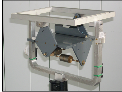
Figure 30 : Dispositif autostabilisé, permettant de garantir l'horizontalité de la prise de vue.
