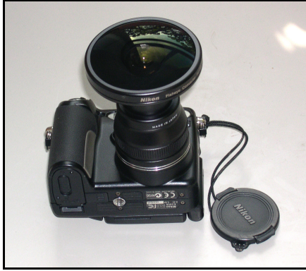
Figure 29 : Appareil numérique utilisé pour les photographies hémisphériques, le Nikon CoolPix 5000, équipé de l'objectif Fisheye Nikon FC-E8.
