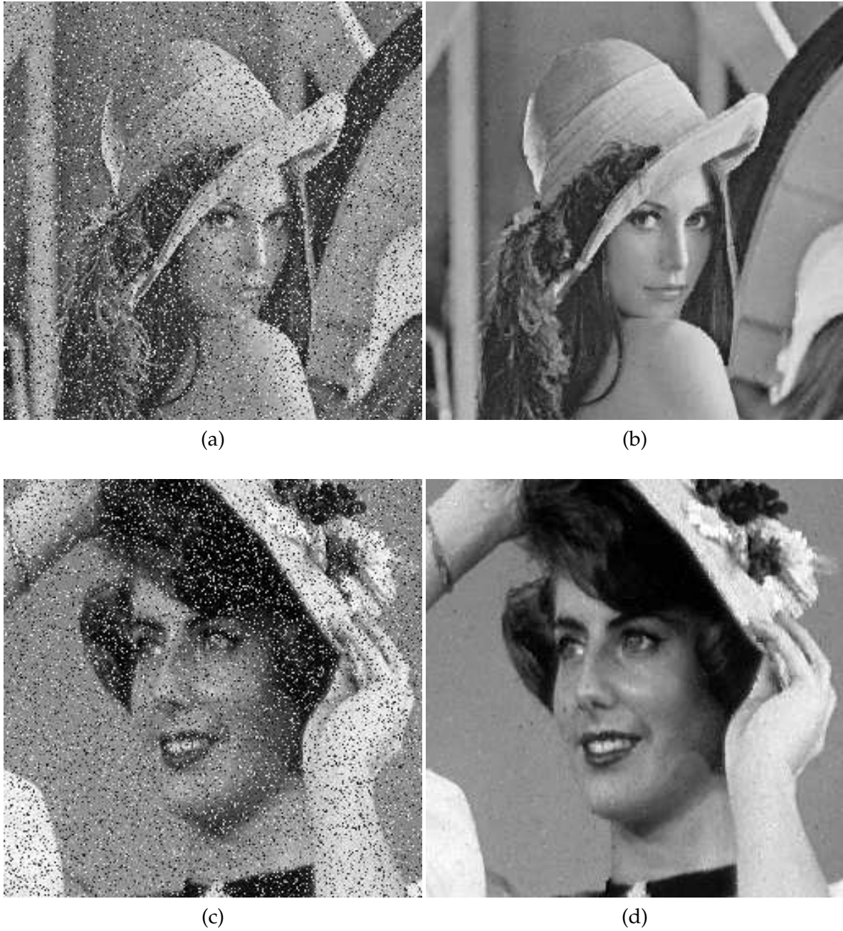
Fig. 2.4 – Restauration de lena et girl corrompues par un bruit impulsif ( p = 0.2 ). Les images corrompues sont présentées en (a) et (c) et images restaurées en (b) et (d). Le coefficient de régularisation est fixé à \beta = 0,20 .
