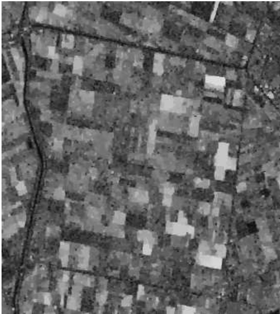
Fig. 2.11 – Résultat de la restauration de l'image radar présenté en figure 2.10. Le modèle utilisé est TV pour la régularisation et une loi de Nakagami pour l'attache aux données. Le coefficient de régularisation est fixé à \beta = 0,02 .
