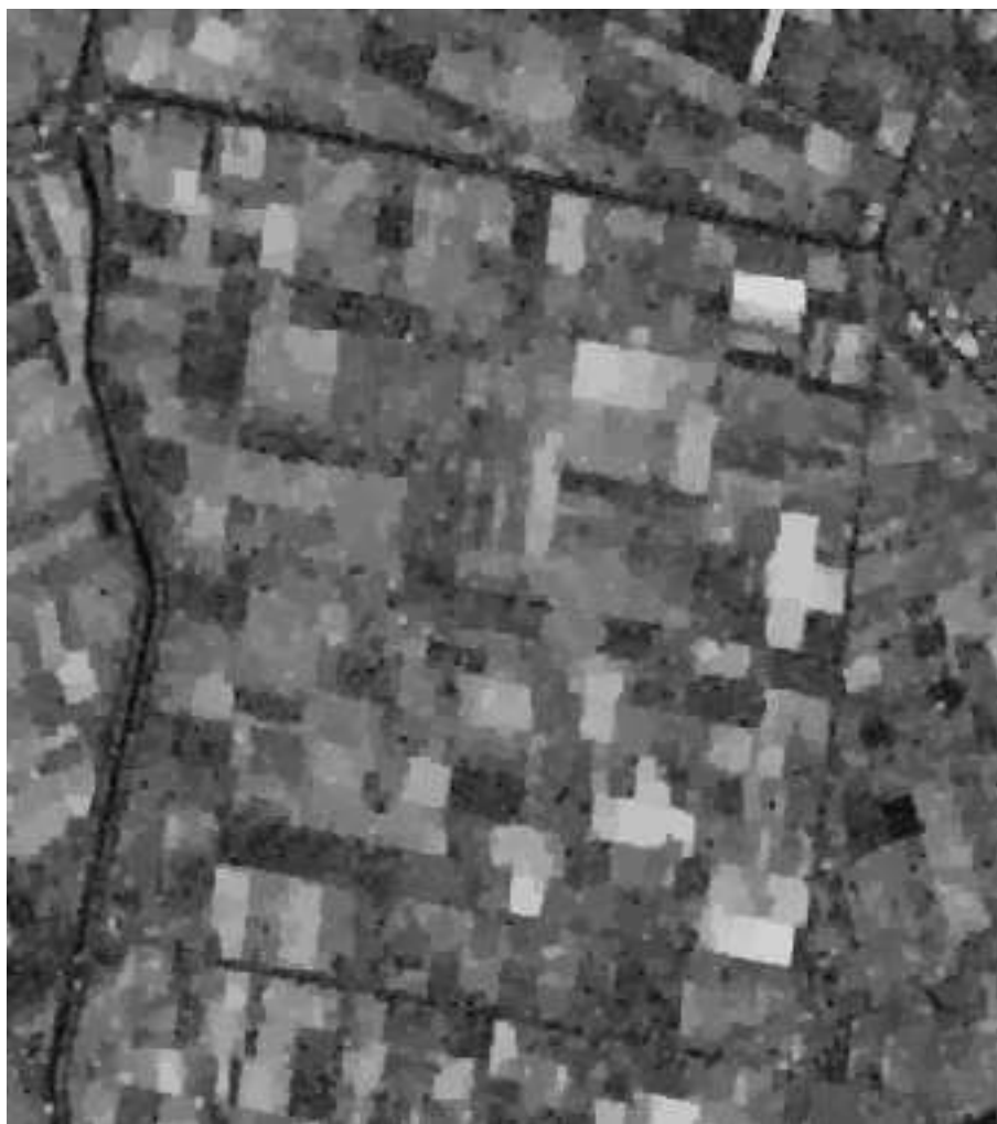
Fig. 2.12 – Résultat de la restauration de l'image radar présenté en figure 2.10. Le modèle utilisé est TV pour la régularisation et une loi de Nakagami pour l'attache aux données. Le coefficient de régularisation est fixé à \beta = 0,025 .
