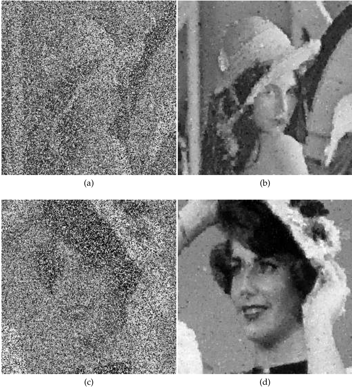
Fig. 2.6 – Restauration de lena et girl corrompue par un bruit impulsif ( p = 0.7 ). Les images corrompues sont présentées en (a) et (c) et les images restaurées en (b) et (d). Le coefficient de régularisation est fixé à \beta = 0,40 .
