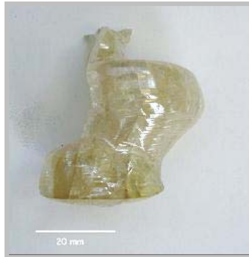
Figure I. 3-31 : boule de GdVO_4 : 2\% Yb obtenue par la méthode Czochralski.
