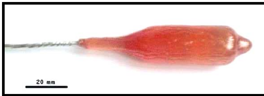
Figure I. 3-41 : boule Czochralski de GdAlO 3 dopé 2 % ytterbium.
