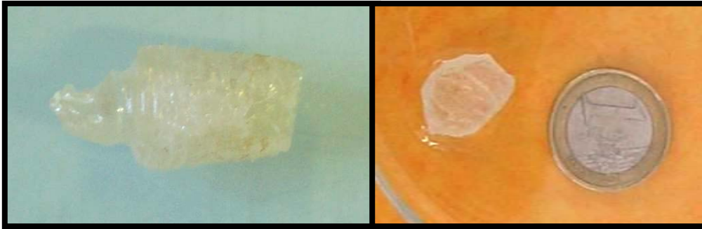
Figure I. 3-52 : cristaux de \text{Lu}_2(\text{WO}_4)_3 obtenus par la méthode Czochralski
