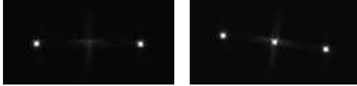
FIG. 3.8 – Spectre de Fourier d'un éclairage modulé par un SLM Displaytech. Un alignement optimal du vecteur \vec{P}_0 signifie une modulation presque pure de phase (photo à gauche), tandis qu'un alignement imparfait de \vec{P}_0 donne une modulation mixte d'amplitude et de phase (photo à droite).
