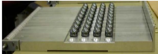
Figure C.I.11 : Plaque de collage dont l'espacement entre les axes des billes est de 24 mm. Le positionnement des billes est assuré par un trou usiné dans la plaque.
