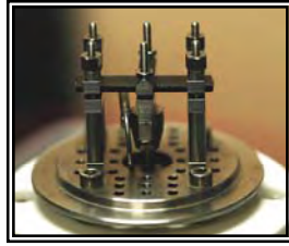
Figure I.22 : Analyse mécanique dynamique en flexion 3 points encastrés
