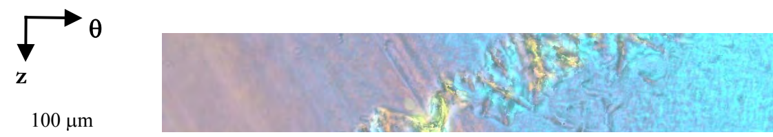
Figure III.25 : Photographie d'un alignement de défauts selon la direction \theta , obtenue en microscopie optique en transmission
