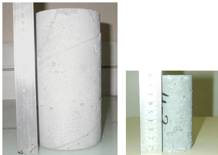
FIG. 3.3: Epreuves homothétiques de béton de polystyrène de tailles : (110 \times 220mm) et (44 \times 88mm) : rapport d'homothétie égal à 2.5.
