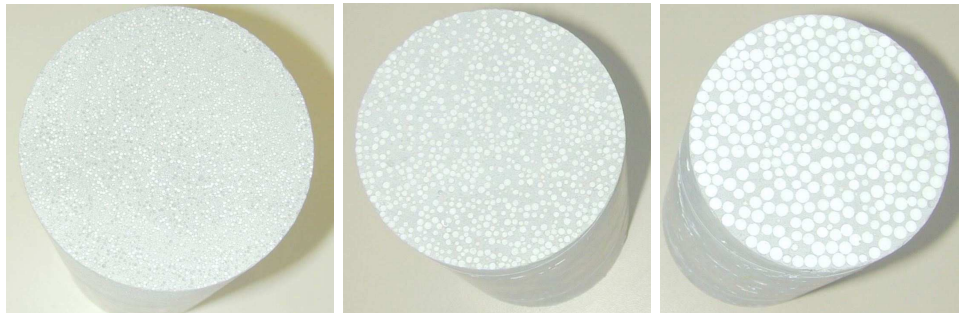
FIG. 3.1: Les trois tailles homothétiques des billes de polystyrène expansé considérées dans cette étude : \phi_1 = 1mm , \phi_2 = 2.5mm et \phi_3 = 6.3mm : rapport d'homothétie égal à 2.5.
