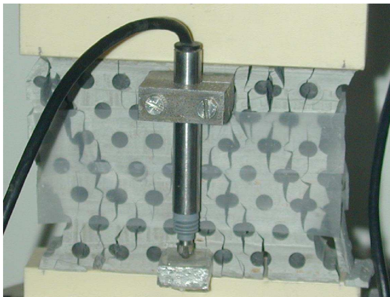
FIG. 2.8: Faciès de rupture au pic d'effort : propagation stable des fissures vers le centre de l'éprouvette 1 ( \phi_1 = 5mm ; % surfacique en trous = 20).
