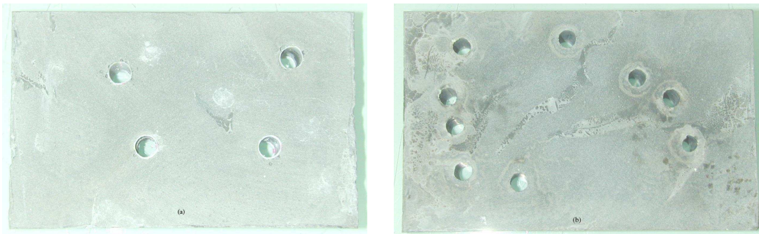
FIG. 2.32: a) Epreuve 1 ( \phi_1 = 6mm ; % surfacique en trous = 1.8) : configuration aléatoire des trous n°1. b) Epreuve 2 ( \phi_2 = 4mm ; % surfacique en trous = 1.8) : configuration aléatoire des trous n°1.
