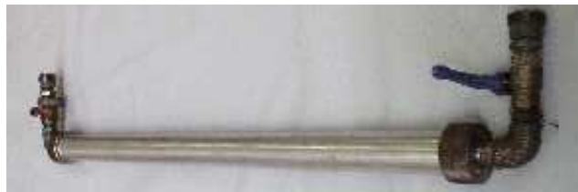
FIG. I-18 Tube scanner (Diamètre D=0.05 m, Longueur L=0.79 m)
