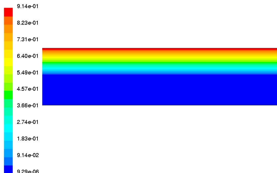
FIG. A-11 Champ des taux de déformation \dot{\gamma} (en s^{-1} ) pour une vitesse moyenne de 0,08 \text{ m}\cdot\text{s}^{-1}
