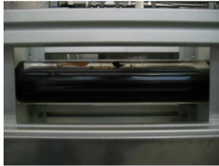
FIG. IV-18 Visualisation du retrait (au sommet) dans le tube plexiglas du montage expérimental (vue de côté)
