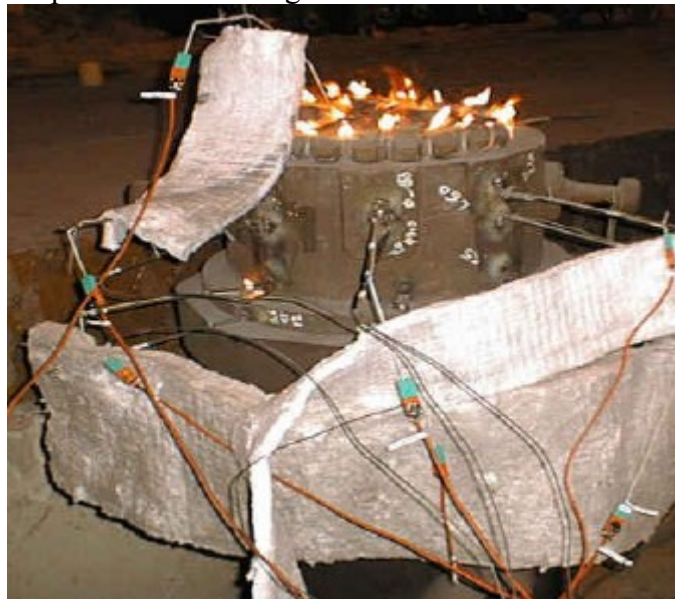
Figure 1-4 : Détail de l’instrumentation du lingot O3t3 de Aubert et Duval [HANS, 2002]
