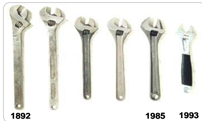
Figure N°3 : Evolution des clefs à mollette (Sandvik, 95)
