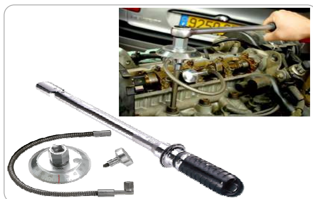
Figure N9 : Outils nécessaires au serrage angulaire contrôlé
