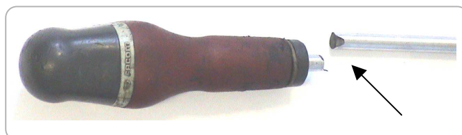
Figure N°71 : Tournevis personnalisé (coup de meule sur la lame) issu d'un garage automobile - Utilisé pour le contrôle du jeu de rotule (effet de levier).
