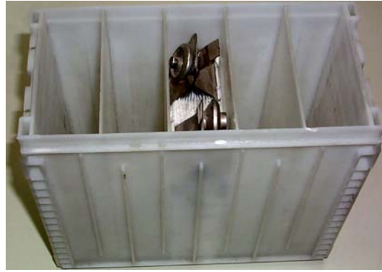
Figure 3-1 : Élément de batterie avec un faisceau dans le boîtier
