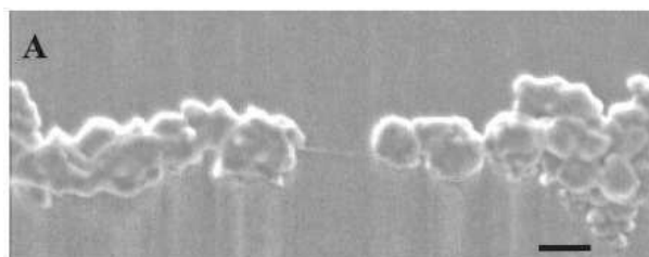
FIG. 1.14 – Image au MEB d'un SWNT contacté par des fils d'or auto-assemblés sur de l'ADN [KBB + 03]
