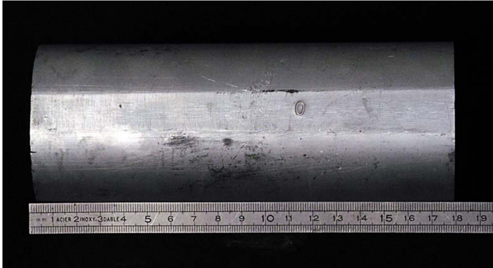
Figure VII.20 Eprouvette de compression AA7175 filé vue de dessus, au niveau du méplat.
