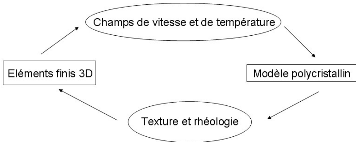
Figure IV.5 Principe général du couplage méthode EF / modèle polycristallin pour un incrément de calcul macroscopique.
