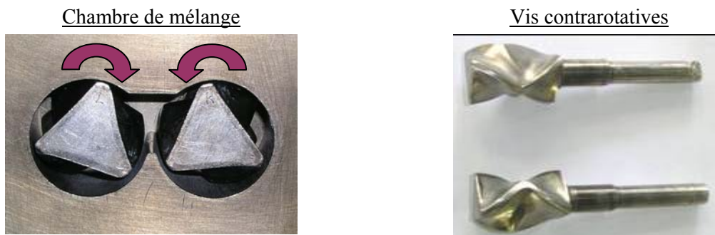
Figure 17 : Chambre de mélange et vis contrarotatives du mélangeur
