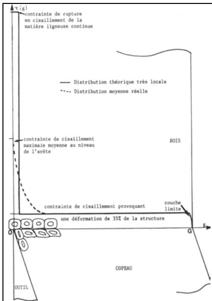
Figure I-39 : Distribution des contraintes le long du plan de cisaillement primaire d'après [THI88]
