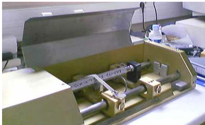
Figure 229 : Banc de mesure des modules d'élasticité dynamique
