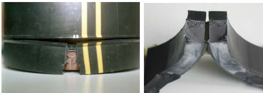
Figure 2.42 : Résultats de l'essai à la virole sur une soudure réalisée à pression nulle
