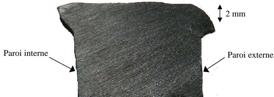
Figure 5.21 – Allure en coupe du bourrelet à la fin de la phase de chauffage (d'une durée de 175s). La température du miroir est de 220°C, les pressions appliquées sont de 0,18 MPa au cours de l'égalisation et de 0,01 MPa au cours du chauffage
