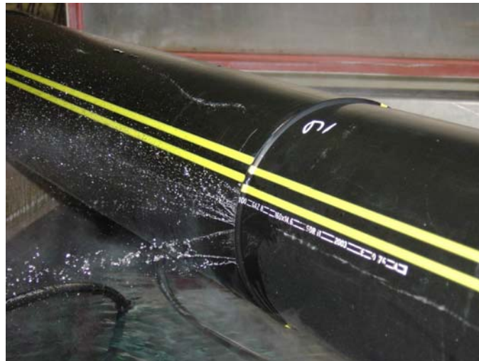
Figure 2.45 – Rupture en pression hydraulique (80°C / 5 MPa) dans le plan de soudage de l'assemblage réalisé à pression nulle
