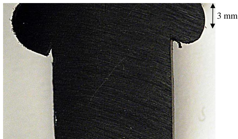
Figure 5.29 – Allure en coupe du bourrelet obtenu à la fin du de soudage. La pression appliquée sur le tube est de 0,18 MPa
