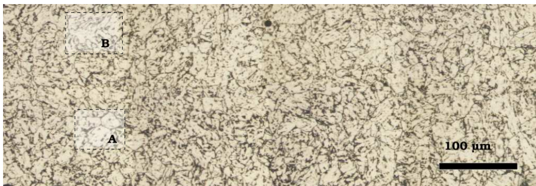
FIG. II.18 – Observation optique en plan large de la microstructure de l’acier 16MND5, après attaque au nital à 2%.
