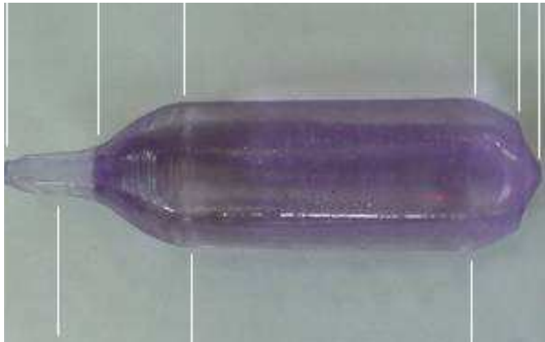
Figure 65. Cristal de \text{Sr}_{0,7}\text{La}_{0,25}\text{Nd}_{0,05}\text{Al}_{11,7}\text{O}_{19} - 8\text{Se} (diamètre : 40 mm).
