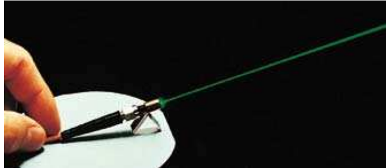
Figure 6. Laser puce émettant dans le vert. Dans un volume minimal, tous les éléments nécessaires au fonctionnement du laser sont intégrés : pompage, cristal, cavité résonante. (CEA-LETT).
