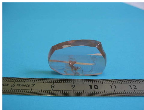
Figure 40. Lame clivée dans le cristal GdVO 4 : Er(0,75%), Yb(10%) 474C.
