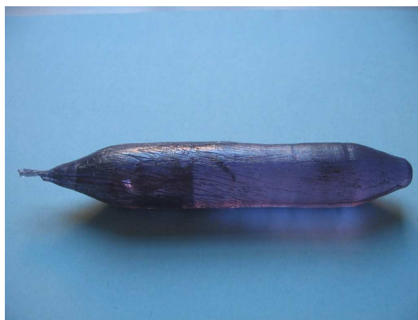
Figure 10. Cristal de \text{CaGdAlO}_4:\text{Nd } 3\% , après recuit réducteur sous atmosphère \text{Ar}/\text{H}_2 à 1000^\circ\text{C} .
