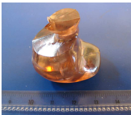
Figure 39. Cristal GdVO 4 : Er(0,75%), Yb(10%) issu du tirage 474C.
