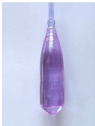
Figure 31. Cristal \text{CaWO}_4\text{:Nd, Na} (2%) élaboré par tirage Czochralski (diamètre : 27 mm).
