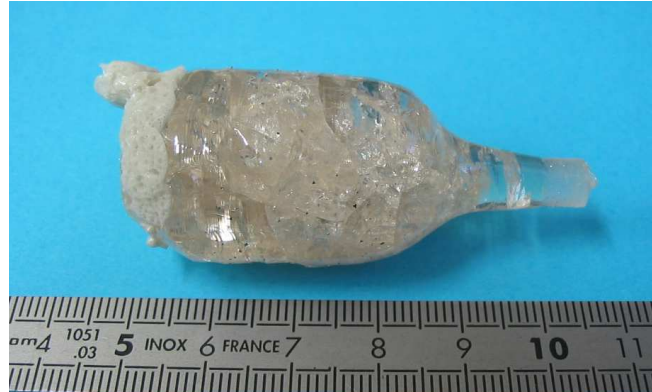
Figure 15. Cristal CAS:Er(1%) , Yb(4,5%) , Ce (5%) – CZ2 obtenu par tirage Czochralski, sous air.
