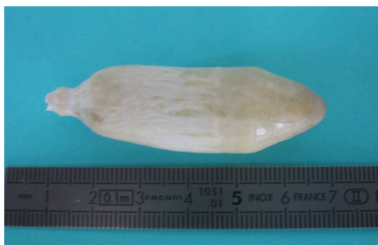
Figure 60. Cristal \text{Ca}_8(\text{Gd}_{0.85}\text{Er}_{0.02}\text{Yb}_{0.1}\text{Ce}_{0.02})_2(\text{PO}_4)_6\text{O}_2 - \text{CZ2} obtenu par tirage Czochralski.
