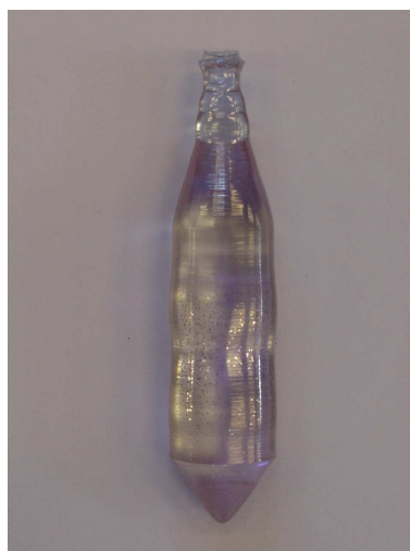
Figure 32. Cristal \text{SrWO}_4\text{:Nd, Na} (4,5%) élaboré par tirage Czochralski (diamètre : 27 mm).
