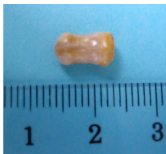
Figure 33. Cristal GdVO_4 : Er(0,5%), Yb(10%) obtenu au four à concentration de rayonnements.
