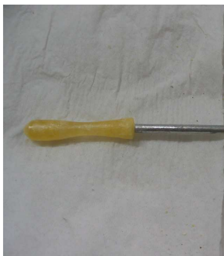
Figure 61. Premier essai de tirage de la composition CLAPO:Er (2%), Yb (10%), Ce (2%).
