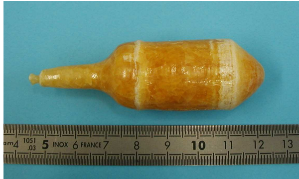
Figure 58. Cristal \text{Ca}_8(\text{Gd}_{0.81}\text{Er}_{0.02}\text{Yb}_{0.15}\text{Ce}_{0.02})_2(\text{PO}_4)_6\text{O}_2 - CZ1 obtenu par tirage Czochralski.
