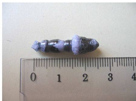
Figure 29. Photo du cristal \text{CaMoO}_4 : Nd, Na 1,5% (four à image) « brut de croissance ».
