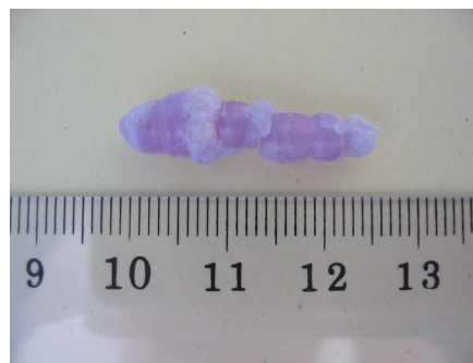
Figure 30. Photo du cristal \text{CaMoO}_4 : Nd, Na 1,5% (four à image) recuit sous oxygène.
