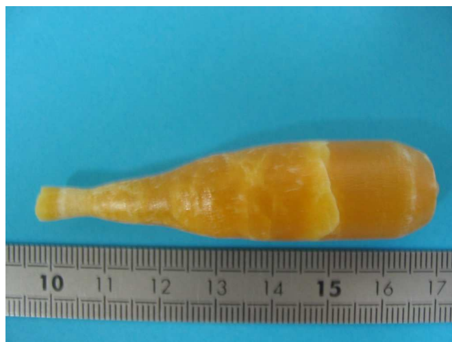
Figure 62. Cristal de CLAPO:Er (2%), Yb (10%), Ce (2%).
