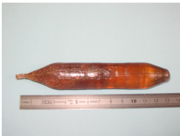
Figure 9. Cristal de \text{CaGdAlO}_4:\text{Nd } 3\% , brut d'élaboration.
