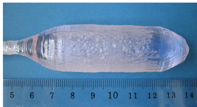
Figure 24. Cristal GdCOB:Er(1,41%), Yb(30,3%) obtenu par tirage Czochralski.
