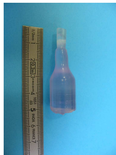
Figure 33. Cristal de \text{BaWO}_4\text{:Nd, K} (10%) élaboré par tirage Czochralski.
