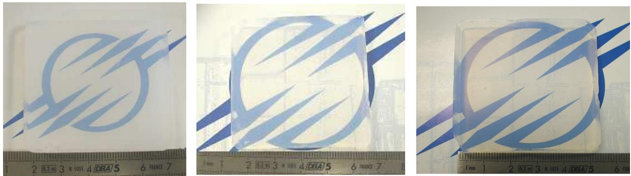
Figure III-16 : Photos d'aérogels de référence issus des différentes extractions
