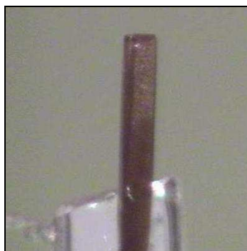
Figure 2.12: Photo d'un cristal de [Fe(DPEA)(NCS)_2] monté à l'huile sur un capillaire fin.
